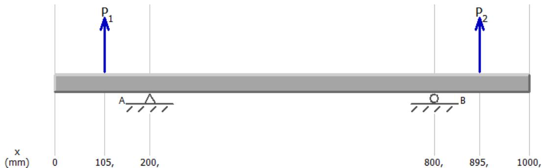
Slika 32. Opterećenje gornjeg vratila u vertikalnoj ravnini
