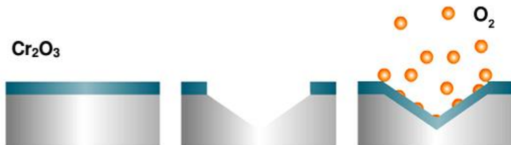
Slika 13: Prikaz mehanizma samoobnavljanja pasivnog filma kromovih oksida na površini.
