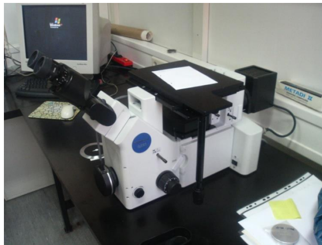
Slika 1: Svjetlosni mikroskop OLYMPUS GX51
