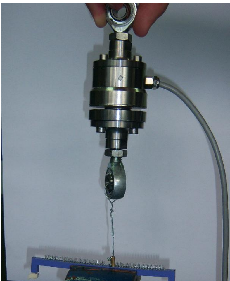
Slika 11. Pripremljen proces za izvlačenje iglice
