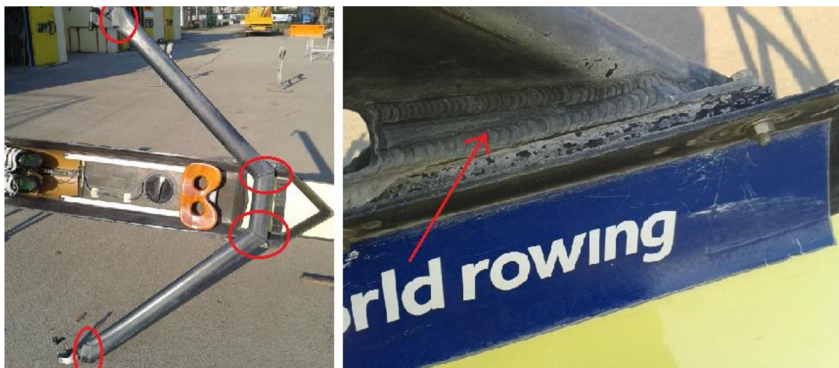
Slika 15. Mjesta zavara na aluminijskim krilima: međusobni spojevi cijevi te spojevi cijevi i nosača za namještanje raspona ušica (lijevo); spoj cijevi i postolja (desno)
