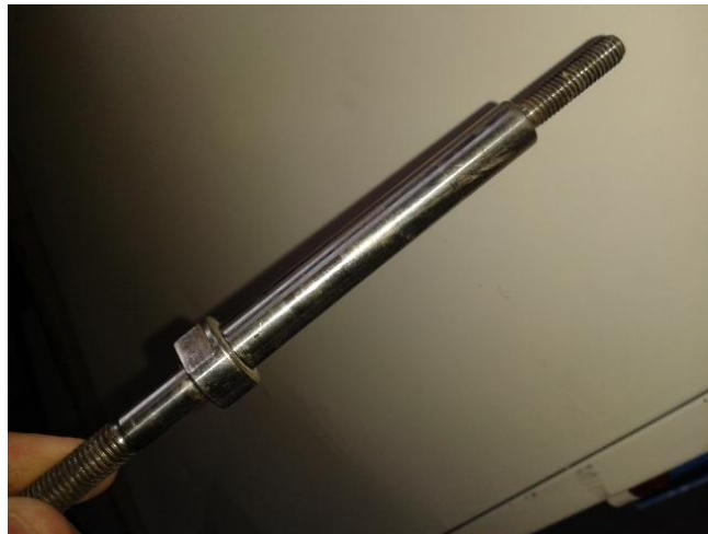
Slika 22. Osovina od ušice od nehrđajućeg čelika
