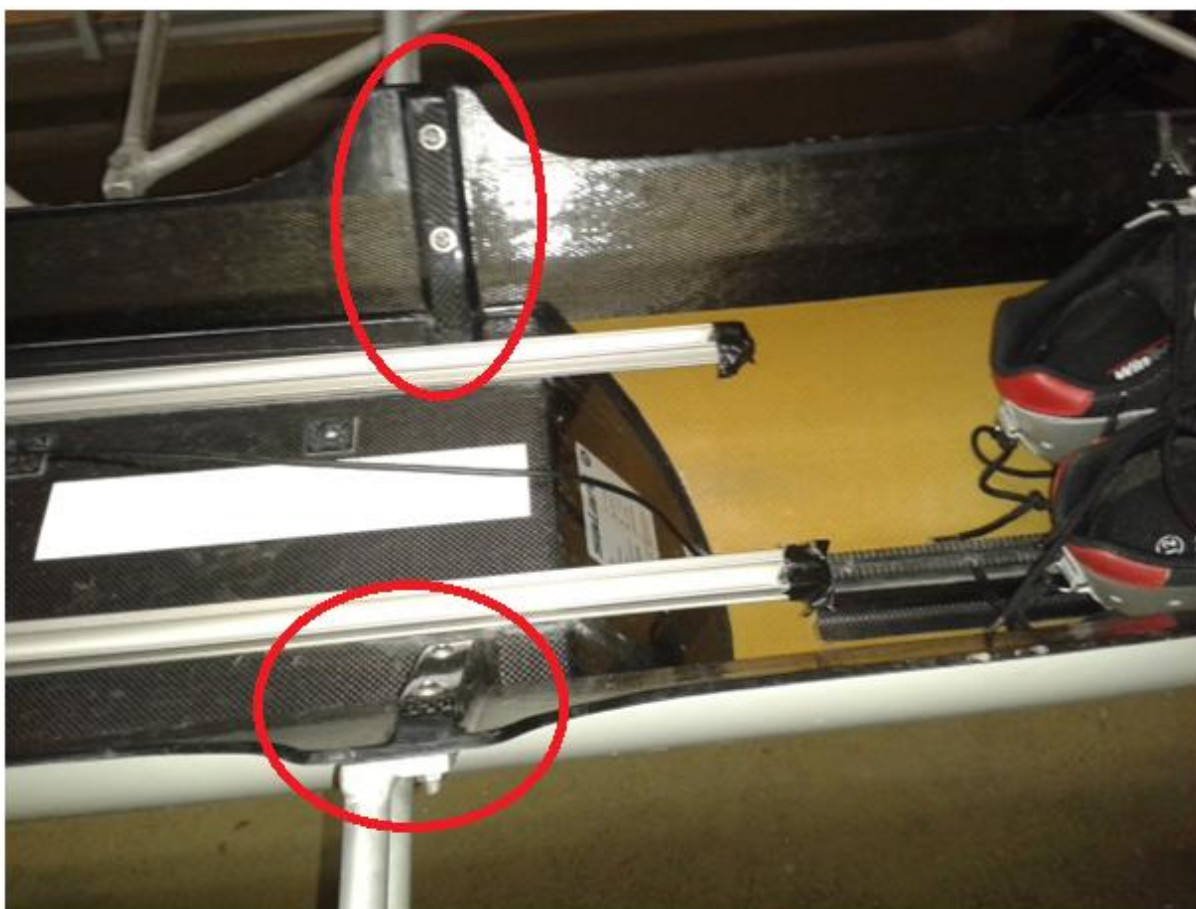
Slika 14. Drvena rebra ojačana ugljičnim vlaknima u koja se vijcima pričvršćuju izbočnici koji nisu u izvedbi krila
