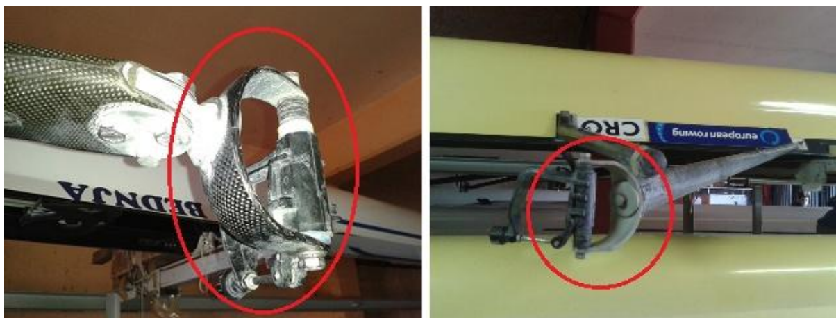
Slika 17. Čeljusti za prihvat ušice ojačane ugljičnim vlaknima (lijevo) i od aluminija (desno)
