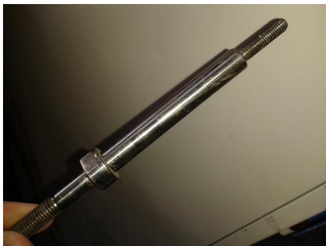
Slika 22. Osovina od ušice od nehrđajućeg čelika
