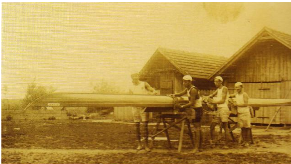
Slika 3. Klinker četverac s preklopnom građom[2]
