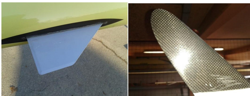
Slika 26. Aluminijska peraja (lijevo) i peraja od ugljičnih vlakana (desno)
