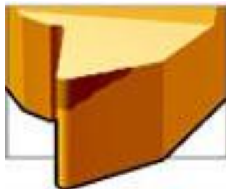
Slika 46. Pretjerano trošenje ruba pločice
