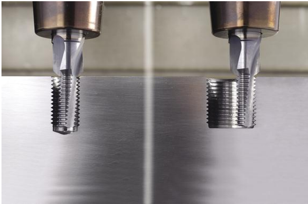
Slika 37. Glodanje različitih promjera navoja istim alatom
