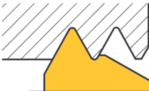
Slika 27. Rezna pločica za puni profil [12]
