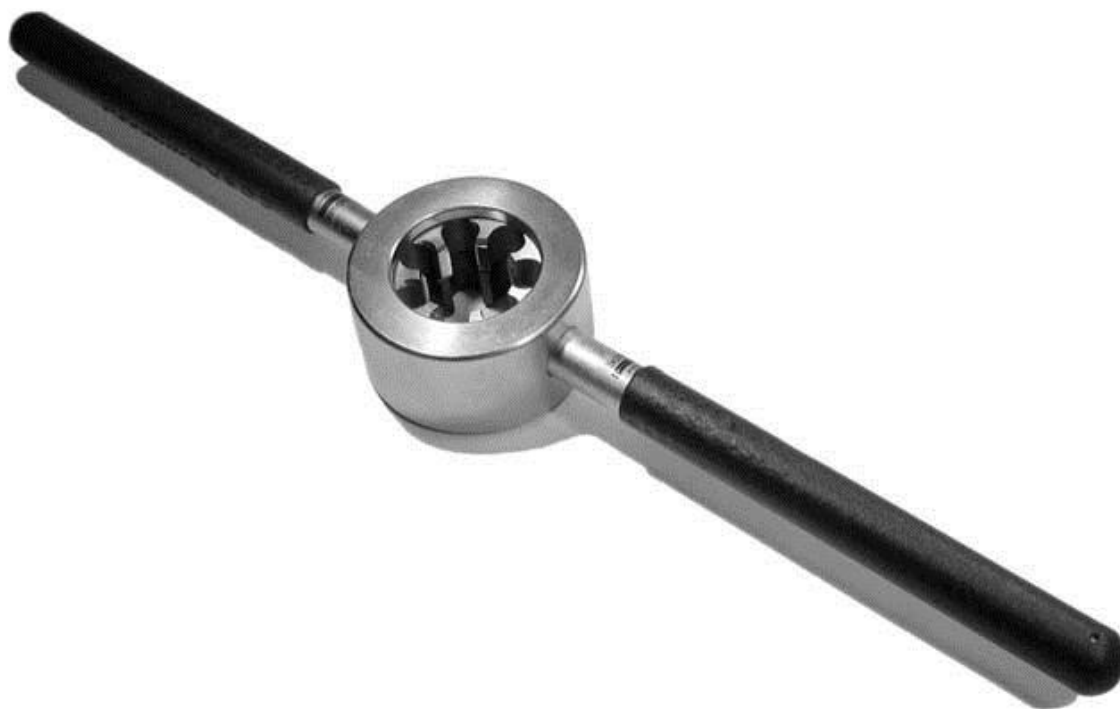
Slika 36. Držač i okrugla nareznica [18]
