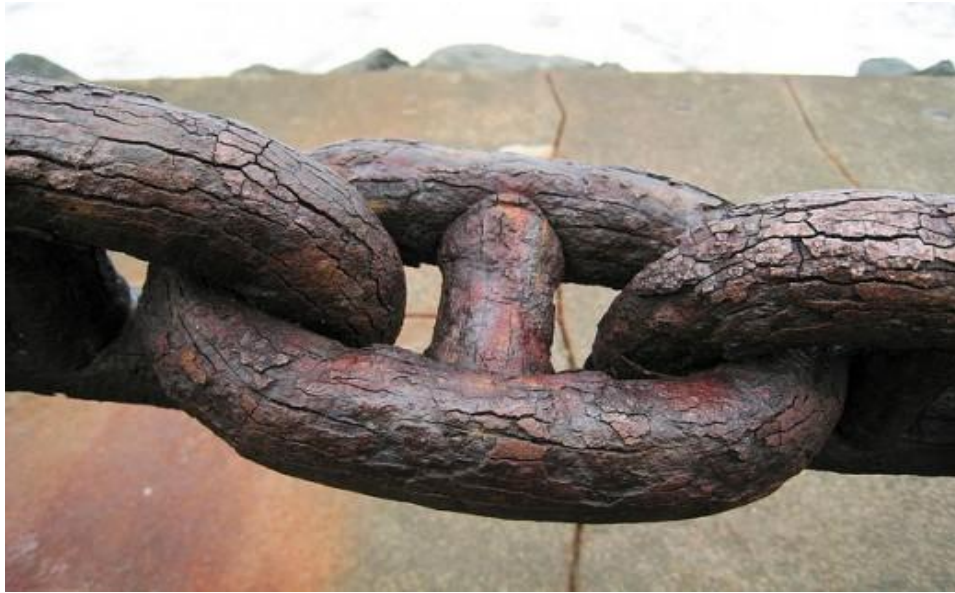
Slika 3. Opća korozija članka lanca u morskoj atmosferi [4]
