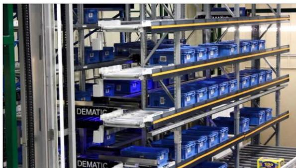
Slika 29: Multishuttle 2 sustav s tračnim vozilima
