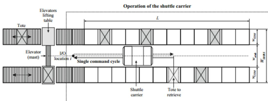
Slika 36: Jednostruki ciklus tračnog vozila
