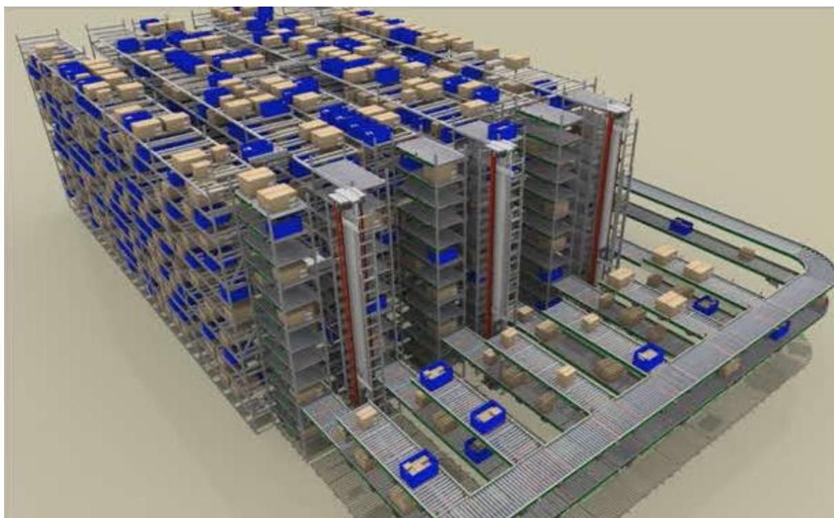
Slika 24: Automatizirani skladišni sustav s tračnim vozilima
