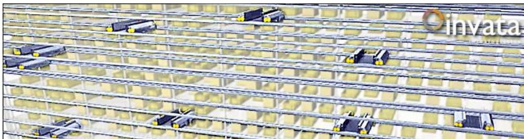
Slika 28: One level sustav s tračnim vozilima proizvođača Invata
