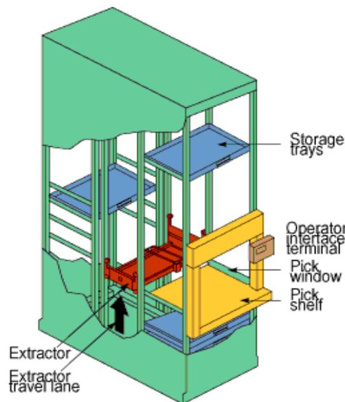
Slika 14: Prikaz vertikalnog podiznog modula s naznačenim dijelovima
