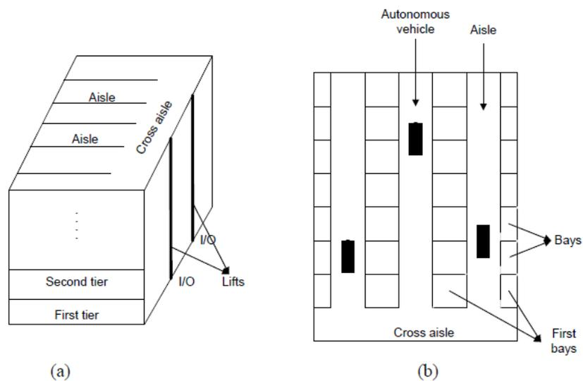
Slika 34 a i 34 b: Osnovni dijelovi i njihov smještaj u sustavu s tračnim vozilima
