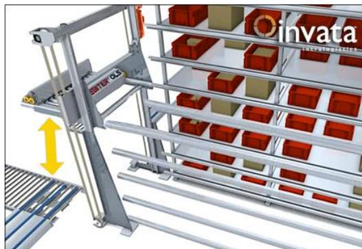
Slika 27: One level sustav s tračnim vozilima
