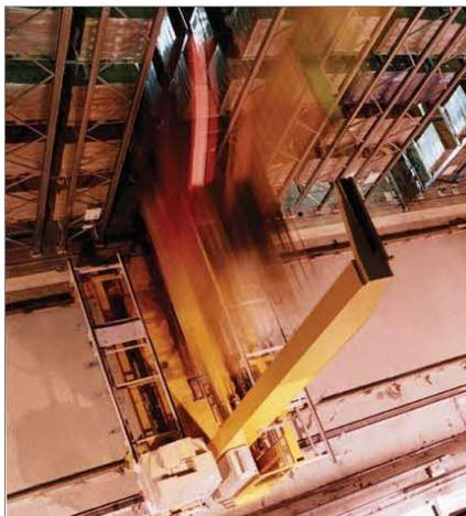
Slika 19: Aisle transfer cart sustav automatiziranog skladištenja
