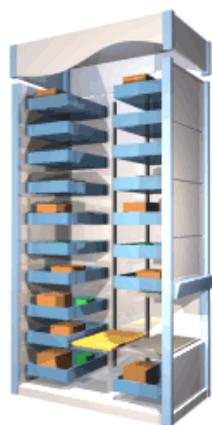
Slika 13: Prikaz unutrašnjosti vertikalnog podiznog modula
