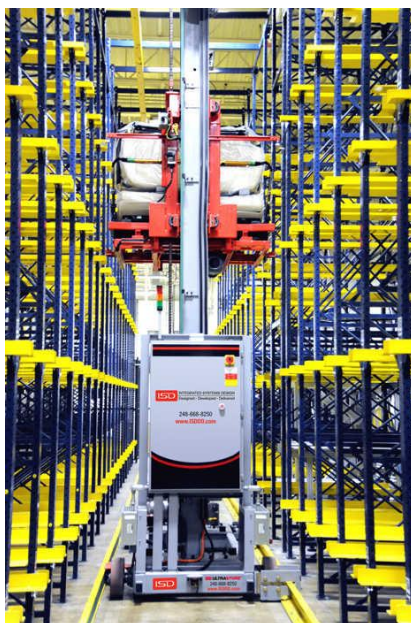
Slika 2: MID-LOAD automatizirani skladišni sustav
