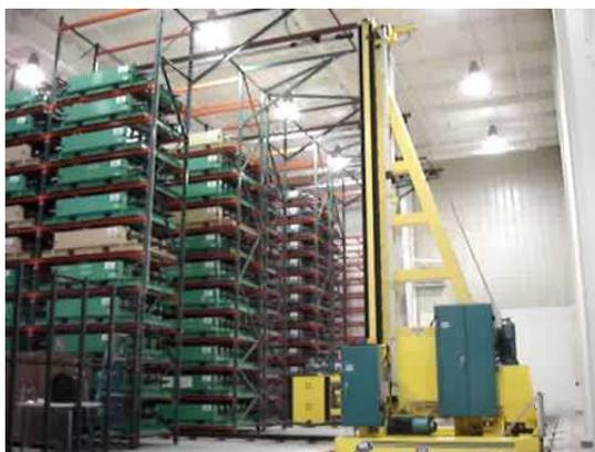
Slika 20: Aisle transfer cart sustav automatiziranog skladištenja (2)
