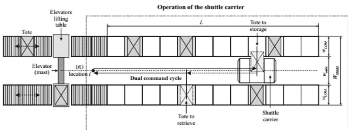
Slika 38: Dvostruki ciklus tračnog vozila
