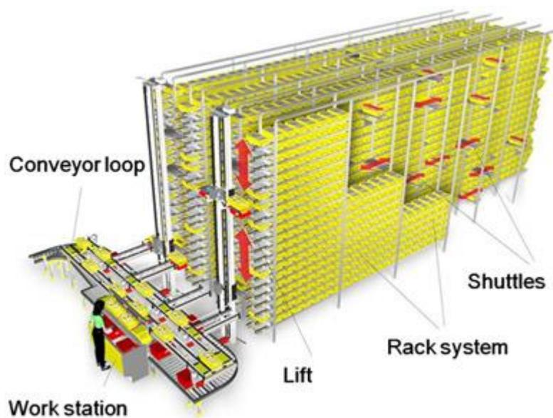
Slika 30: Prikaz dijelova sustava s tračnim vozilima (2)
