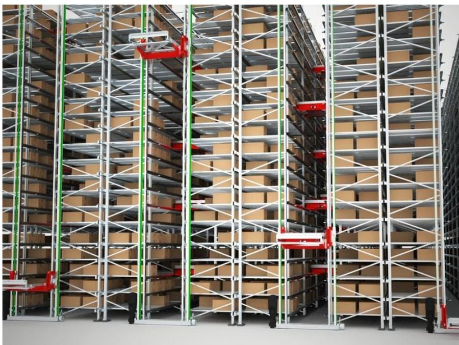
Slika 26: Stingray sustav s tračnim vozilima tvrtke TGV
