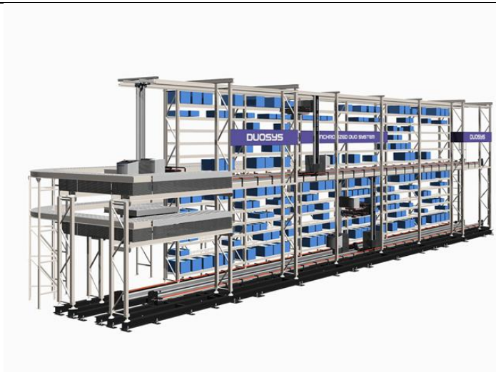
Slika 17: Inovativni Duosys sustav automatiziranog skladištenja
