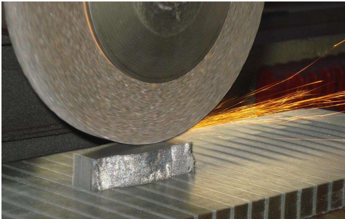
Slika 44 Brušenje uzorka brusilicom
