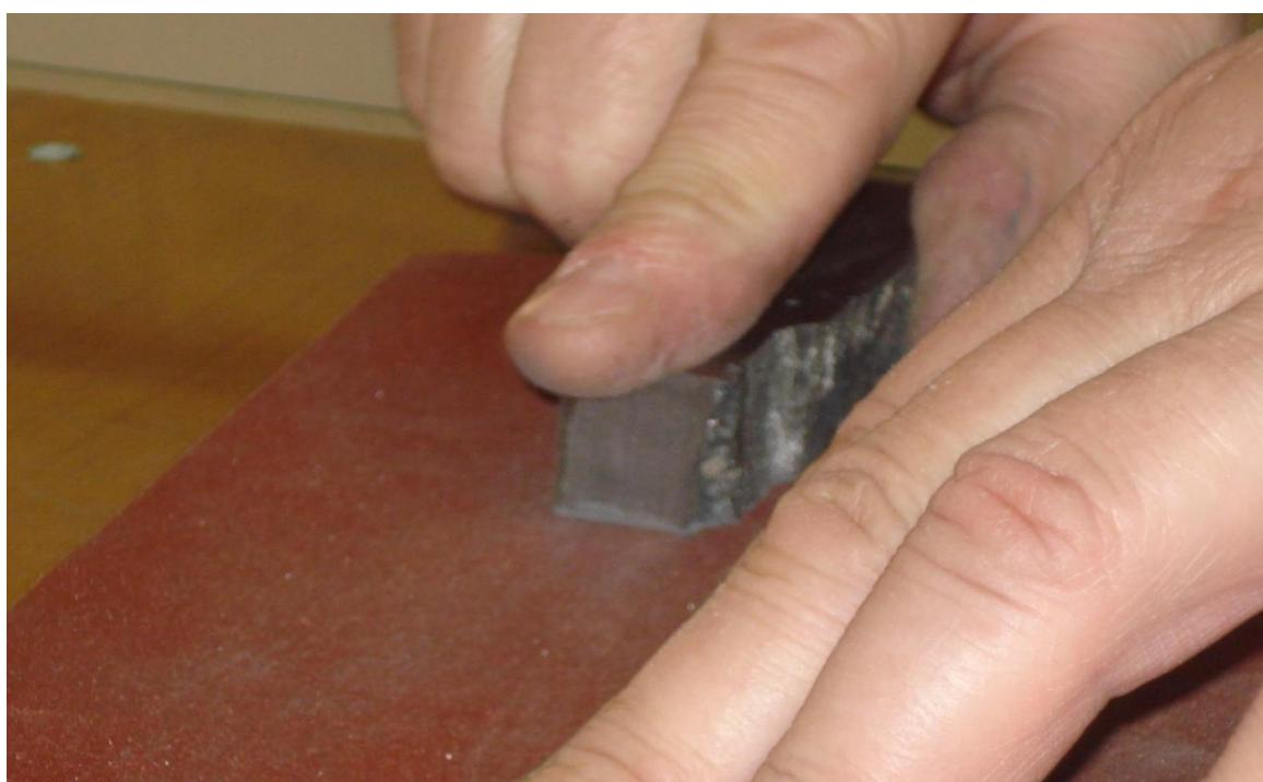
Slika 45 Ručno poliranje uzorka brusnim papirom
