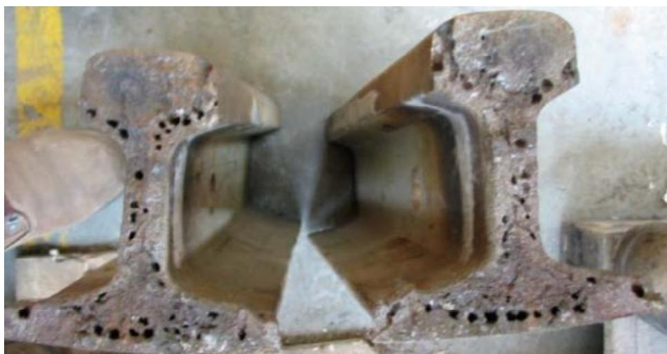
Slika 40 Porozitet u zavaru [19]
