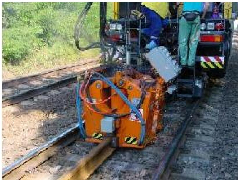
Slika 12 Elektrootporno zavarivanje tračnica [11]
