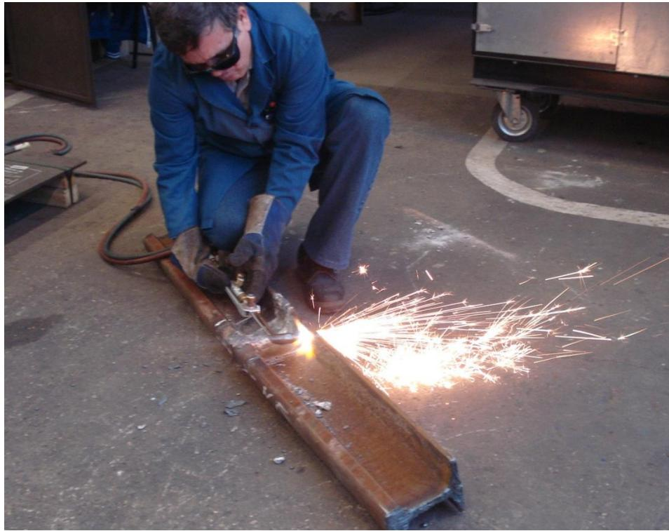
Slika 42 Plinsko rezanje tračnice
