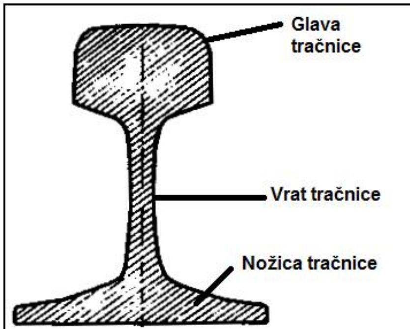
Slika 3 Dijelovi tračnice [6]
