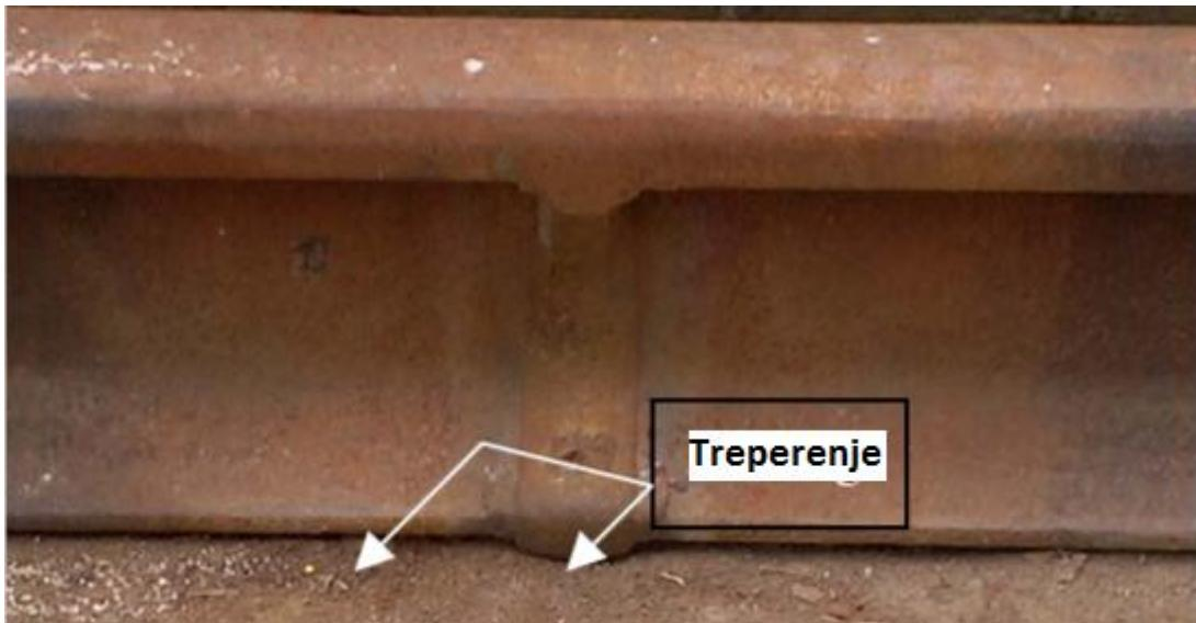
Slika 39 Treperenje zavara na krajevima nožice tračnice [19]
