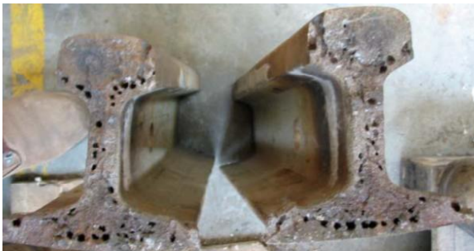
Slika 40 Porozitet u zavaru [19]
