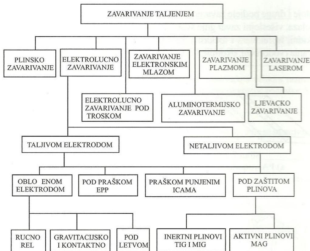
Slika 1 Podjela postupaka zavarivanja taljenjem [3]
