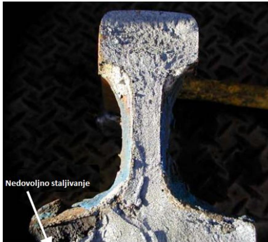
Slika 37 Nedovoljno staljivanje u nožici tračnice [19]
