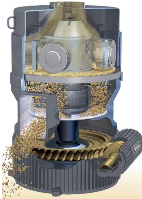
Slika 2. Proces izrade peleta [2]
