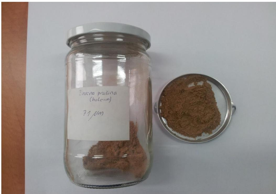
**Slika 12. Drvena prašina granulacije 71  $\mu\text{m}$**
