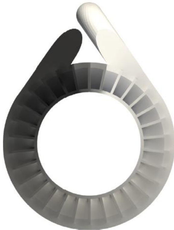
Slika 1.8 Ustrujavanje fluida u kanal i porast tangencijalnog tlaka kroz obodnu pumpu
