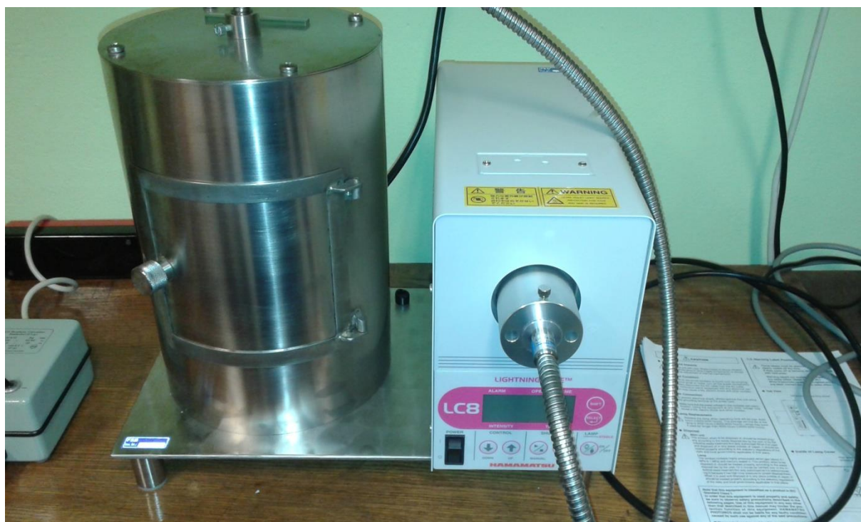
Slika 2. Uređaj točkastog izvora ultraljubičastog zračenja Hamamatsu LC8
