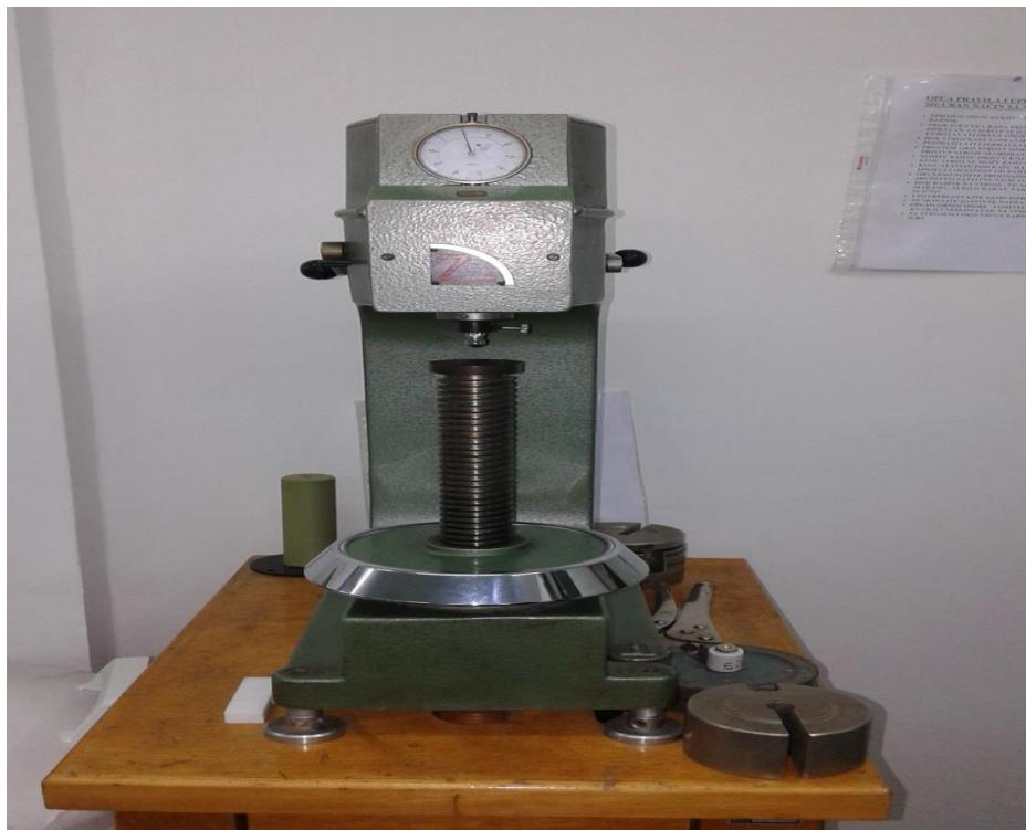
Slika 16. Ispitivanje tvrdoće na tvrdomjeru
