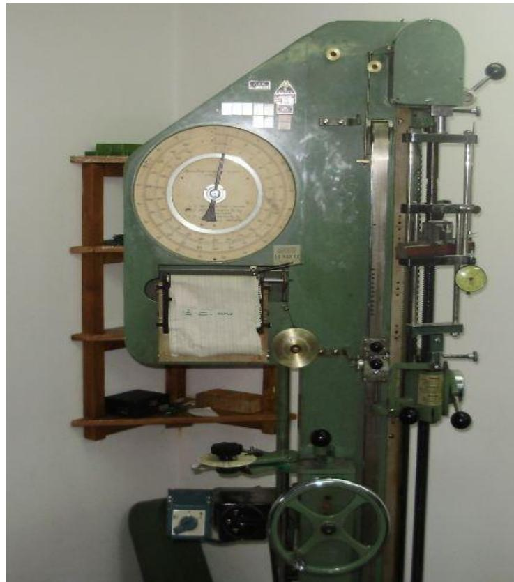
**Slika 8. Ispitivanje savojne čvrstoće na univerzalnoj kidalici**
