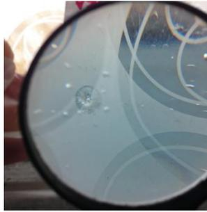
Slika 5.9. Samoobnovljeno oštećenje nakon probijanja metkom
