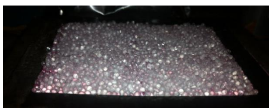
Slika 5.2. Stavljanje granulata u kalup
