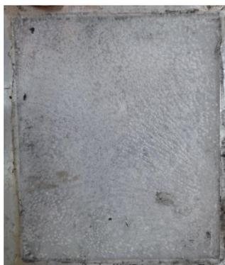
Slika 5.4. Polimerna ploča dobivena prešanjem
