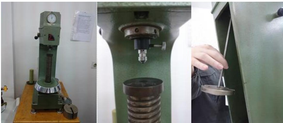
Slika 5.16. a)Tvrdomjer; b)kuglica; c)čelična šipka za utege
