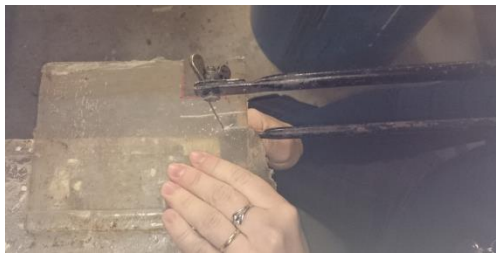
Slika 5.7. Rezanje epruveta ručnom pilom
