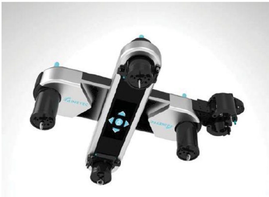
Slika 2 Uređaj za ispitivanje cijevi parogeneratora
