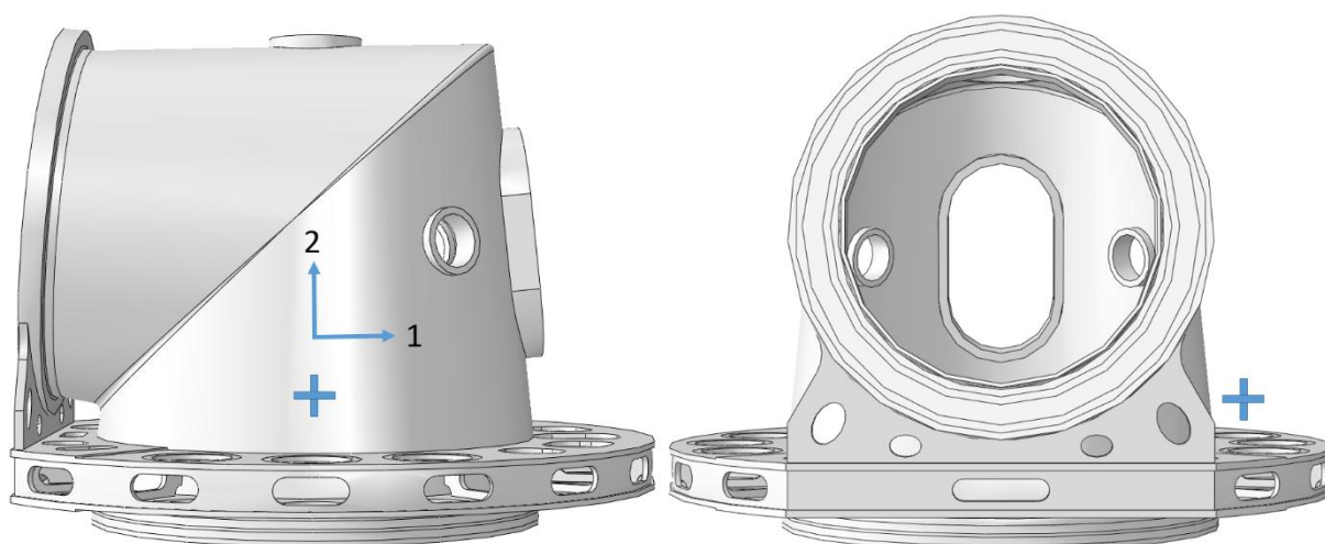
Slika 46. Prikaz glavnog nosača s označenim mjernim mjestom
