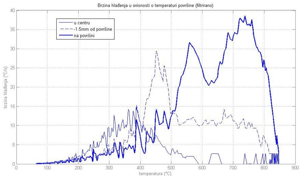
Slika 8.34. Brzina hlađenja – temperaturna površina (filtrirano)
