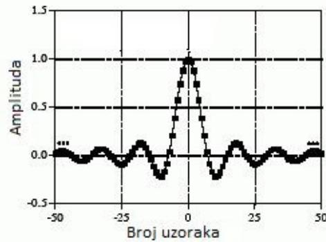
Slika 6.2. Impulsni odziv idealnog niskopropusnog filtera
