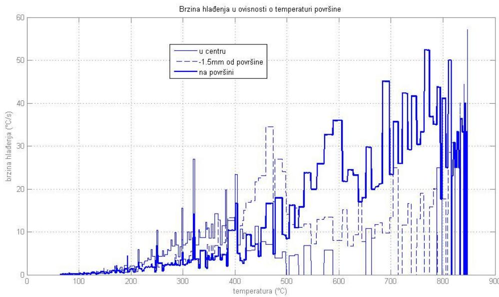
Slika 8.14. Brzina hlađenja – temperaturna površina (ulje)
