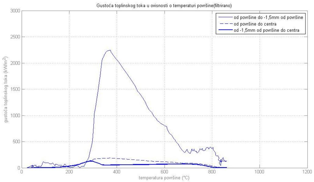
Slika 8.29. Gustoća toplinskog toka – temperaturna površine (polimer, filtrirano)
