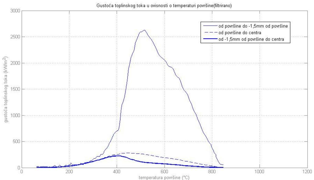
Slika 8.28. Gustoća toplinskog toka – temperaturna površina (ulje, filtrirano)
