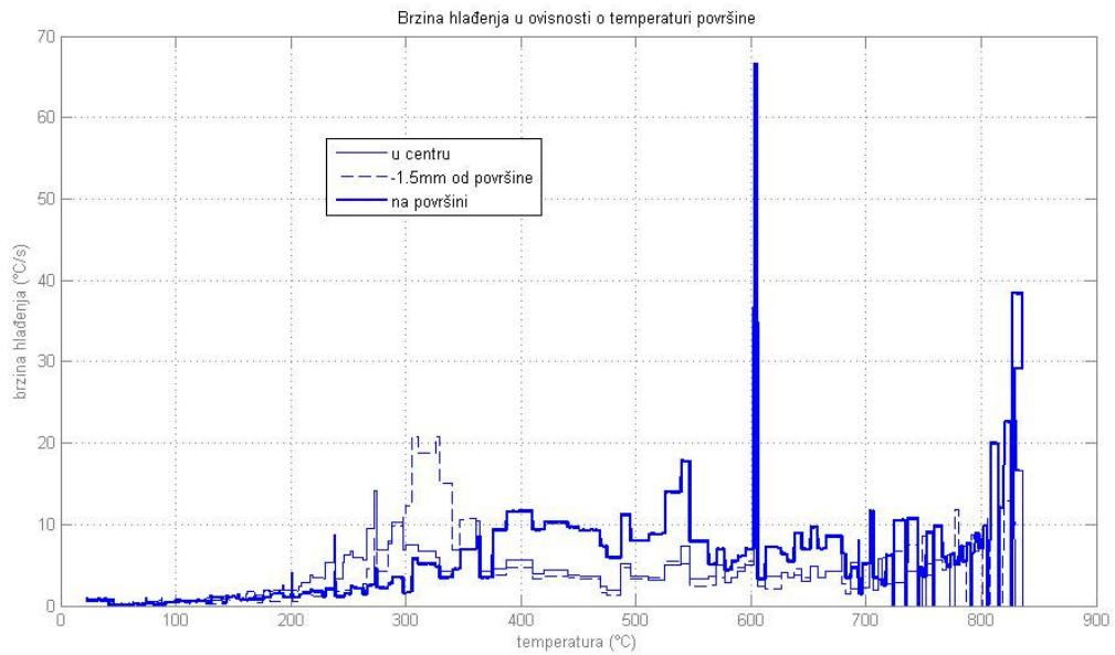
Slika 8.15. Brzina hlađenja – temperaturna površine (polimer)
