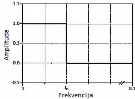
Slika 6.1. Frekvencijski odziv idealnog niskopropusnog filtera
