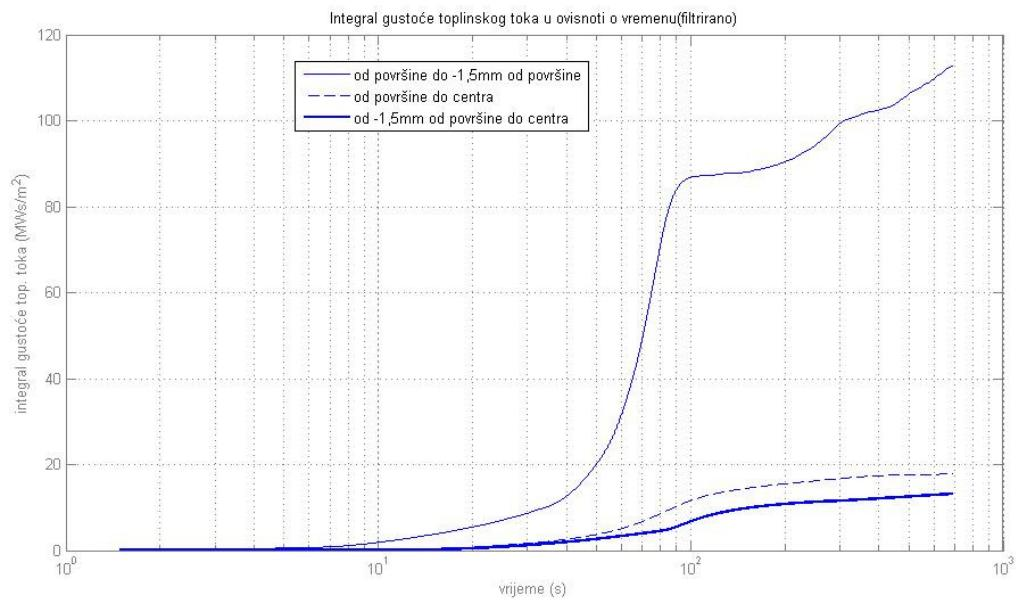
Slika 8.31. Gustoća toplinskog toka – temperaturna površine (polimer, filtrirano)
