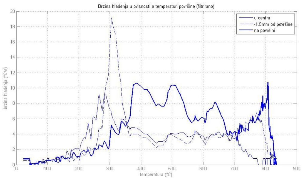
Slika 8.35. Brzina hlađenja – temperatura površine (filtrirano)
