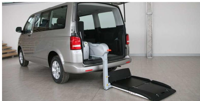
**Slika 4. Vozilo s liftom smještenim u prtljažnom prostoru**
