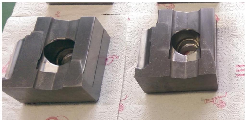
Slika 32. Uzorak A3 prevučen TiBN prevlakom
