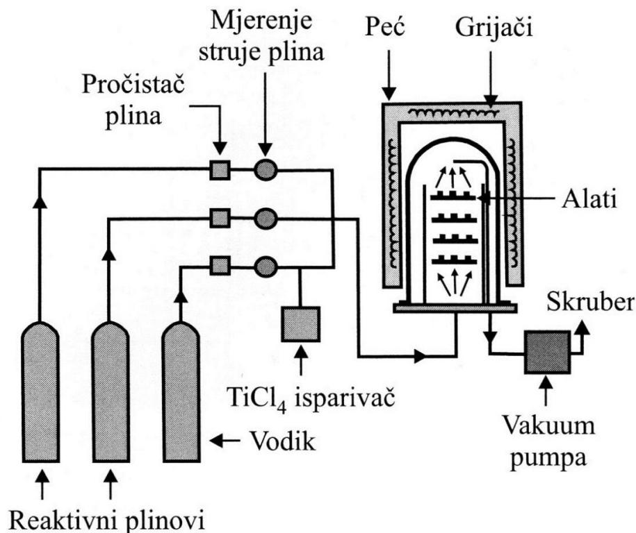
Slika 18. Shematski prikaz postrojenja za nanošenje prevlaka CVD-postupkom [8]
