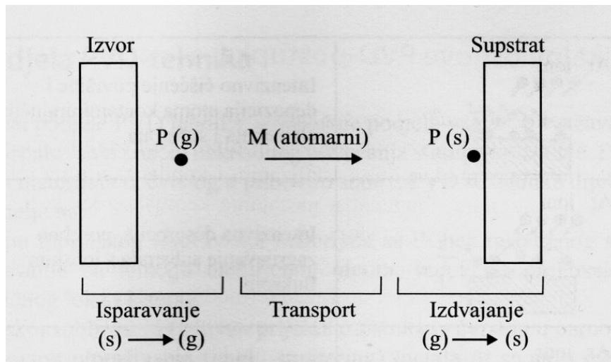
Slika 15. Shematski prikaz fizikalnog taloženja iz parne faze [8]
