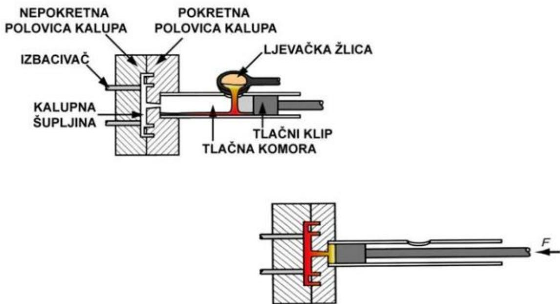
Slika 5. Tlačni lijev u hladnoj komori [4]
