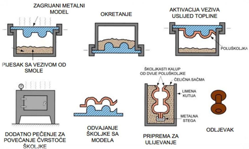
Slika 2. Postupak izrade kalupa za školjkasti lijev [4]
