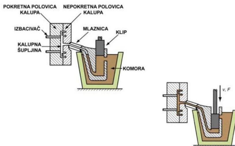
Slika 4. Tlačni lijev s topom komorom [4]
