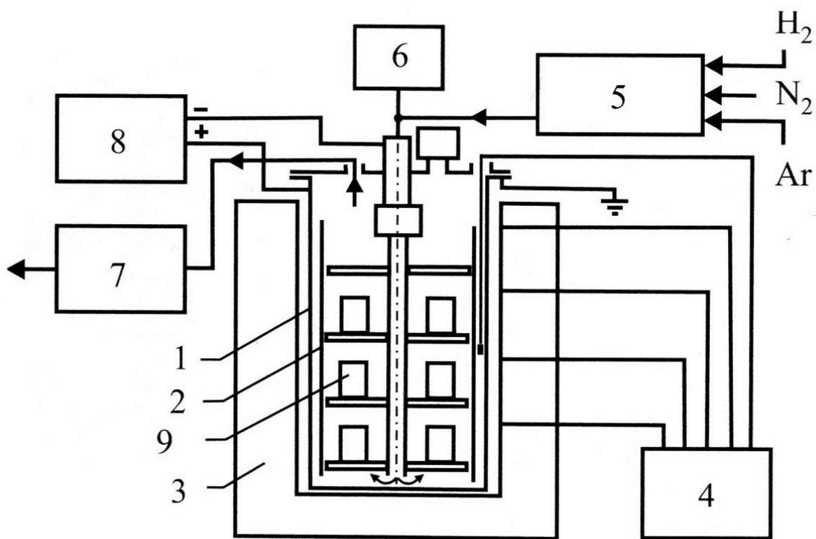
**Slika 21.** Shematski prikaz opreme za PACVD postupak [8]
