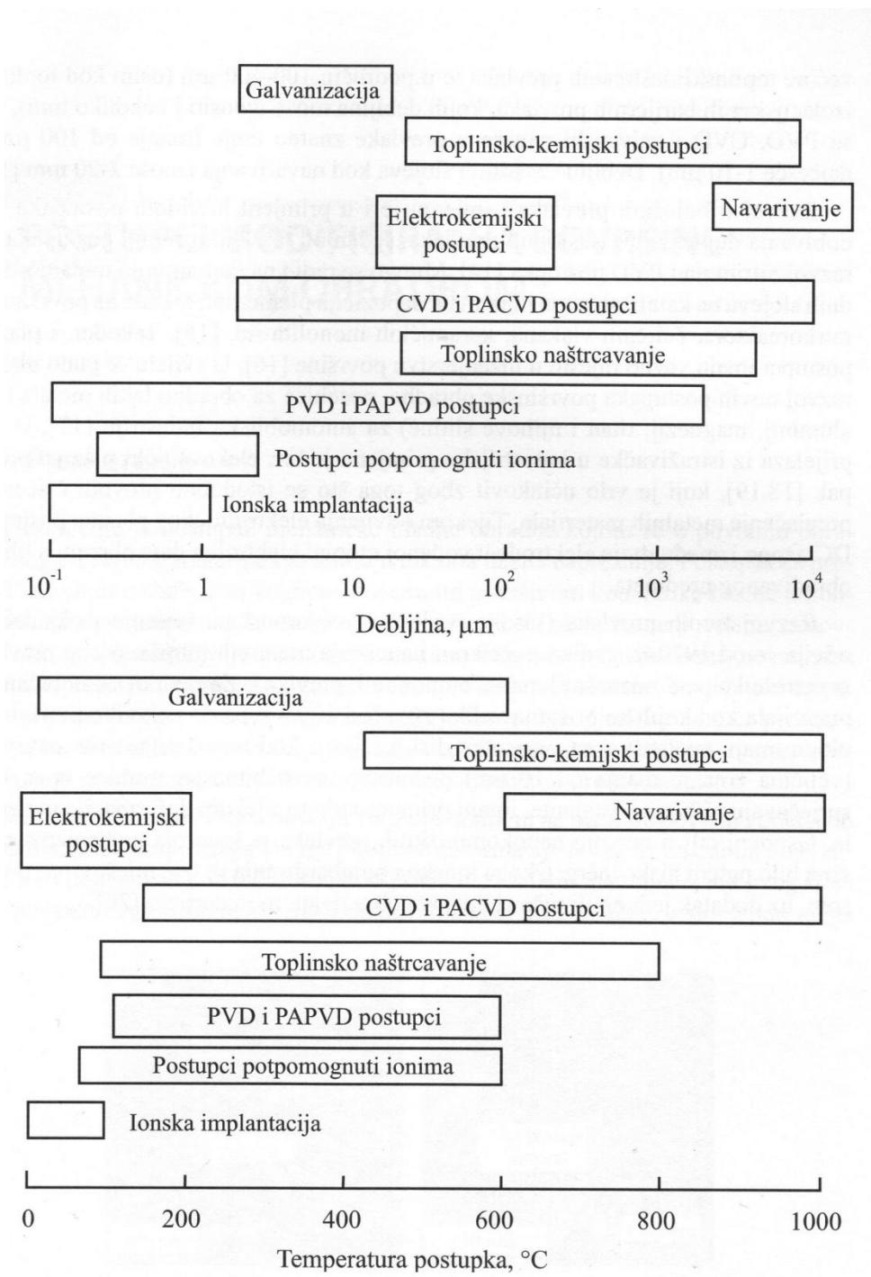
Slika 14. Debljine slojeva i temperature postupaka [8]
