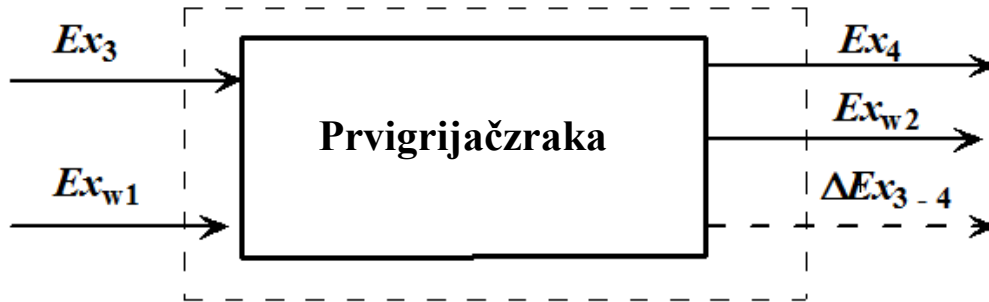
Slika 7 Shema eksergijske destrukcije unutar prvog grijača
