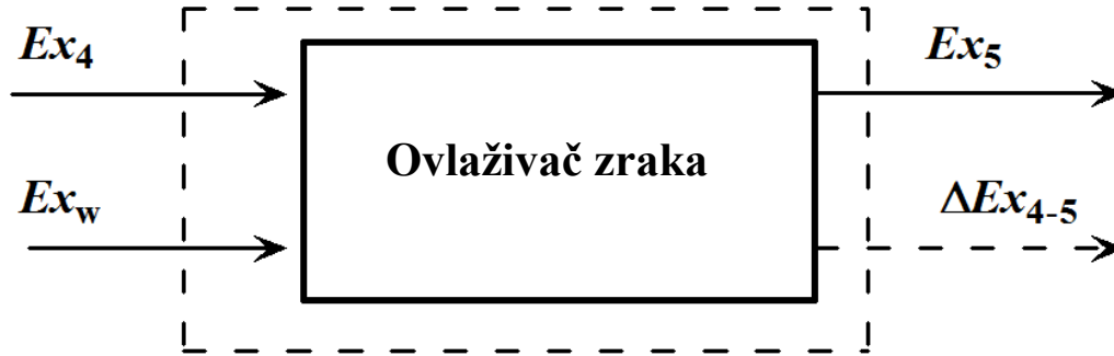
Slika 8 Shema eksergijske destrukcije u ovlaživaču
