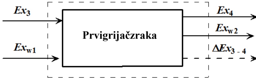
Slika 7 Shema eksergijske destrukcije unutar prvog grijača
