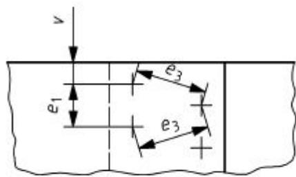
**Slika 7 Elektrootporno točkasto zavarivanje ploča, dvoredno zamaknuto [7]**
