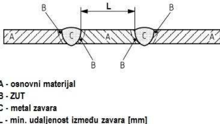
Slika 12 Minimalna udaljenost između zavara [7]
