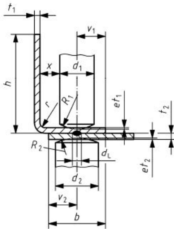
Slika 4 Elektrootporno točkasto zavarivanje kutnih profila i ploča [7]
