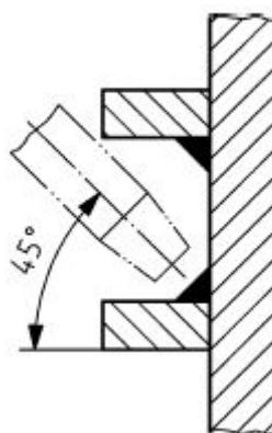
Slika 10 Pristup elektrode [7]
