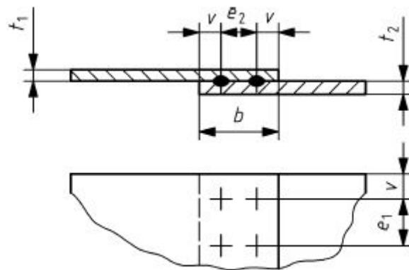
**Slika 6 Elektrootporno točkasto zavarivanje ploča, dvoredno [7]**
