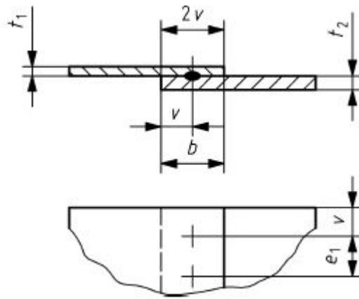
Slika 5 Elektrootporno točkasto zavarivanje ploča, jednoredno [7]
