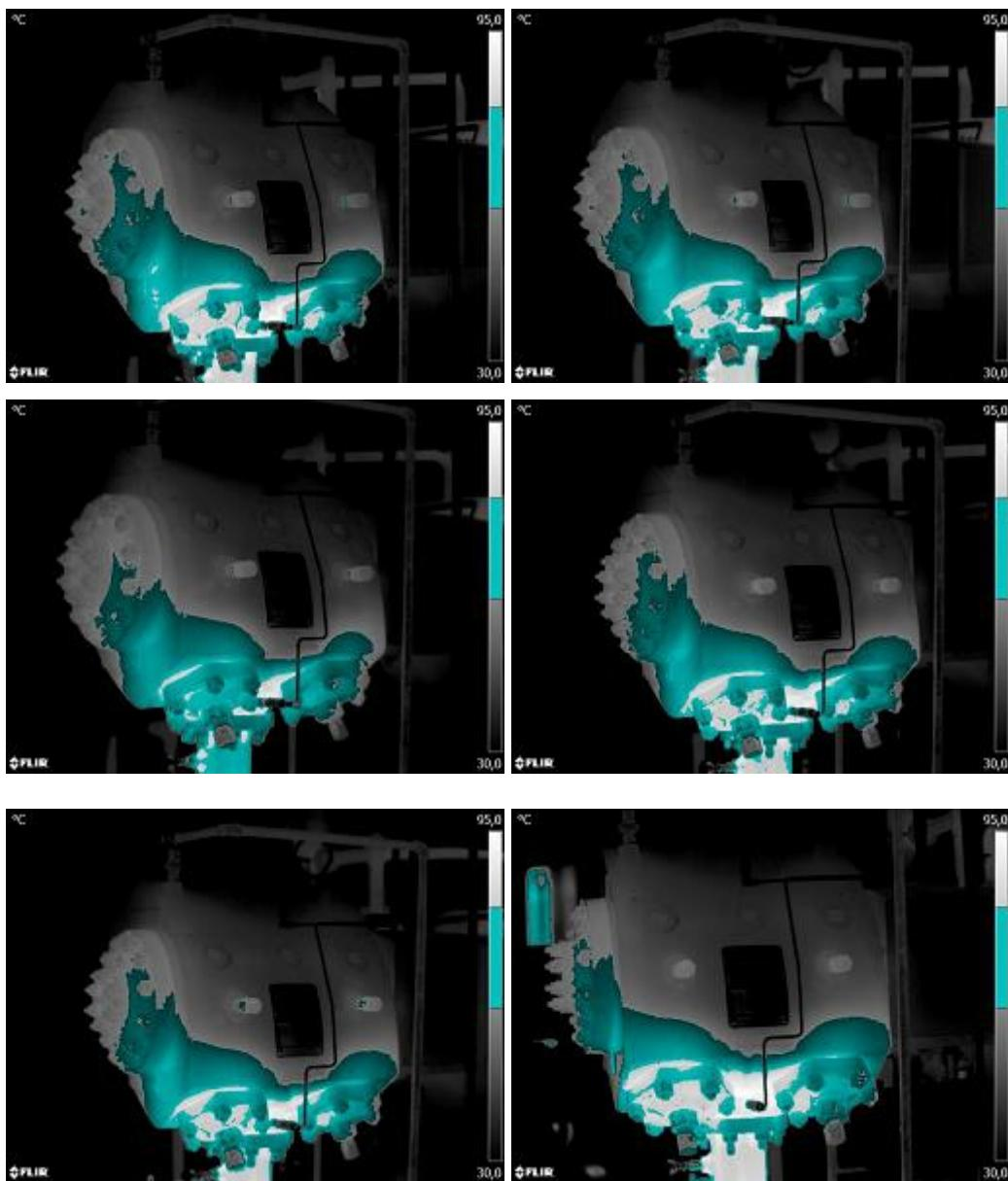
**Slika 23. Usporedni prikaz lijevog cilindra kompresora po datumima**
