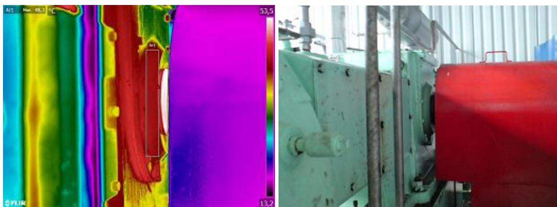
**Slika 28. Termogram i slika prednjeg ležaja kompresora**
