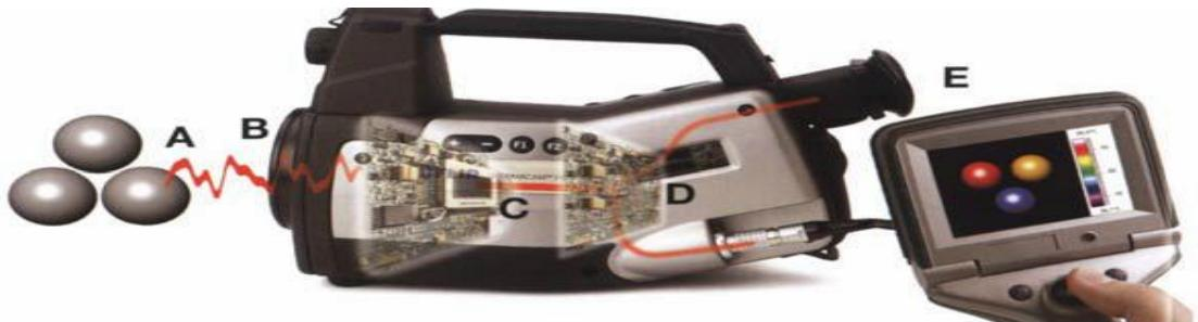
**Slika 2. Princip rada suvremenog termografskog uređaja [2]**
