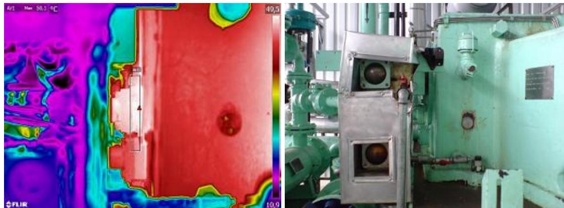
**Slika 30. Termogram i slika stražnjeg ležaja kompresora**
