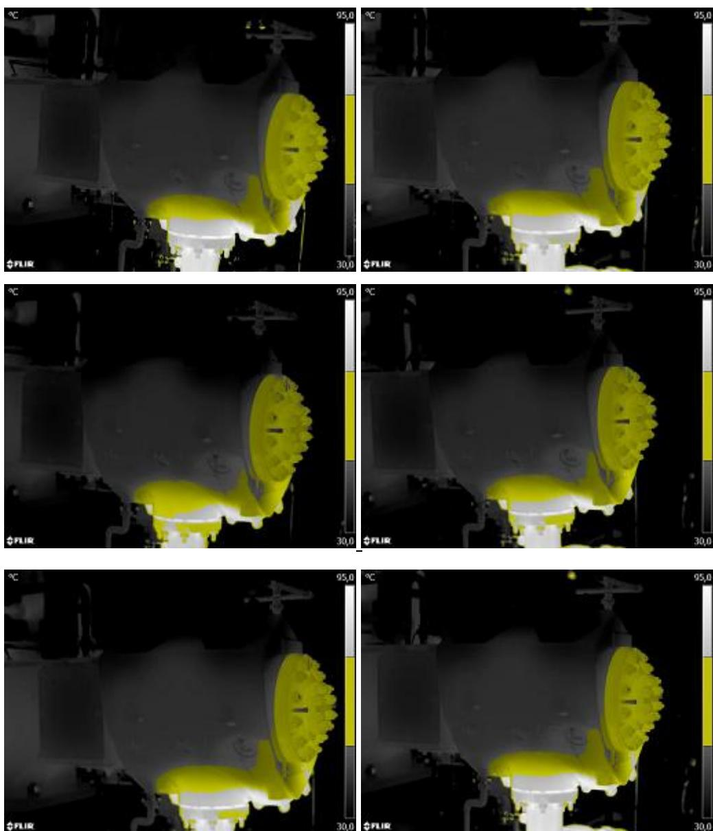
**Slika 18. Usporedni IC-prikaz desnog cilindra kompresora po datumima**
