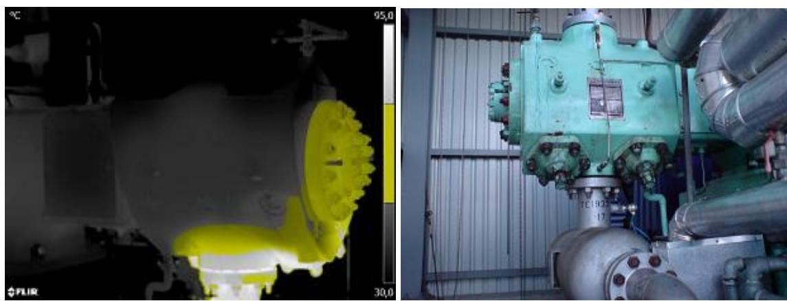
Slika 17. IC prikaz i fotografija desnog cilindra kompresora
