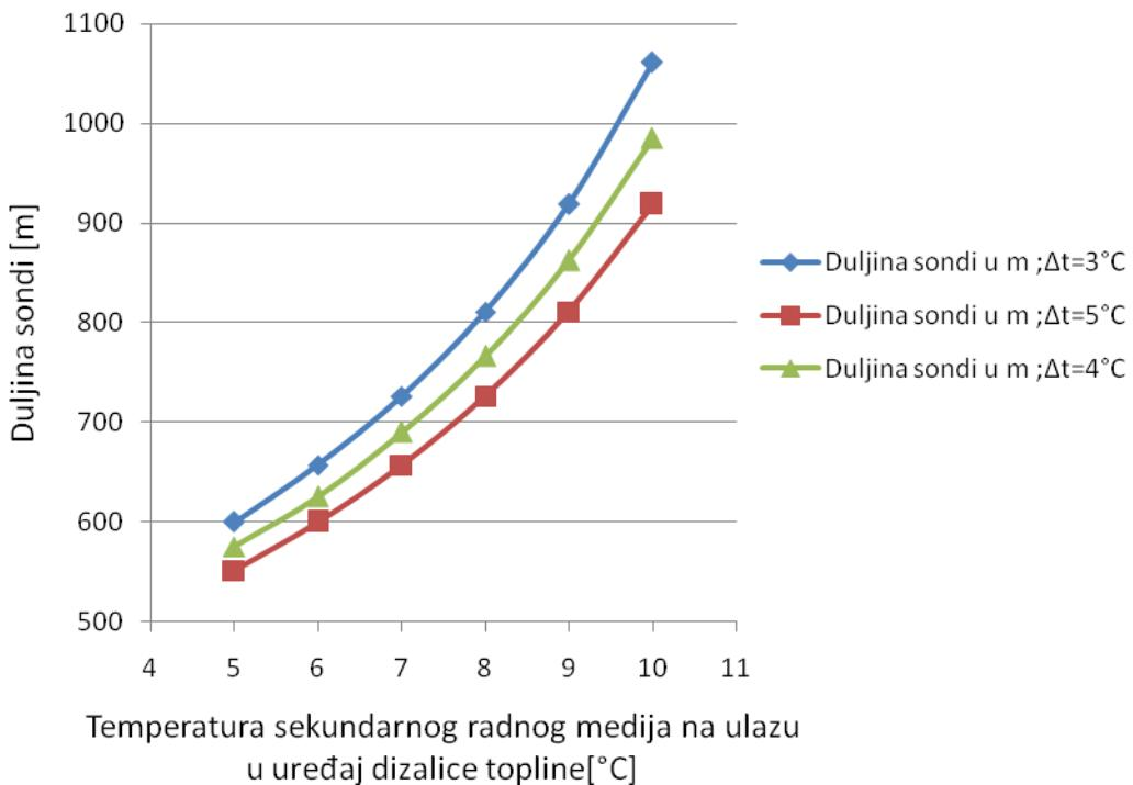
Slika 22. Utjecaj ulazne temperature sekundarnog radnog medija u uređaj dizalice topline na duljinu vertikalnih sondi
