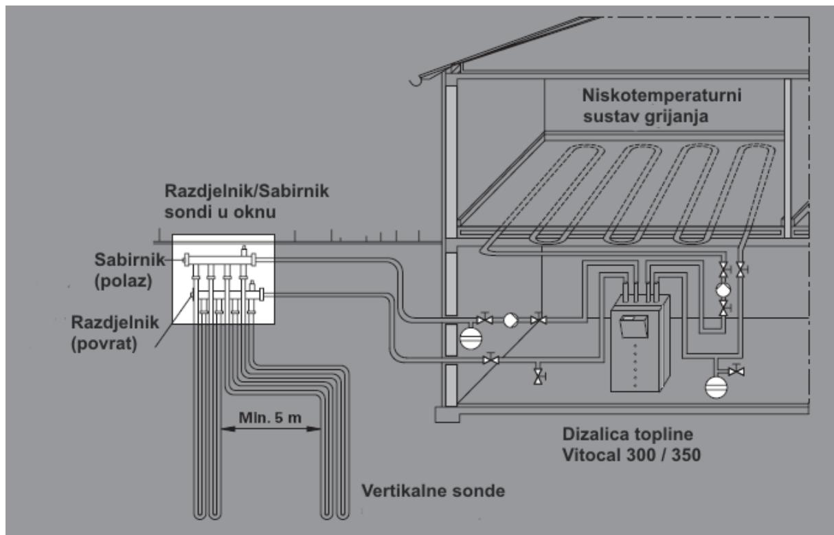
Slika 11. Dizalica topline s tlom kao toplinskim spremnikom s vertikalno ukopanim dubinskim sondama [8]
