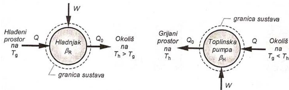
Slika 1. Shematski prikaz rada rashladnog uređaja i toplinske pumpe [1]
