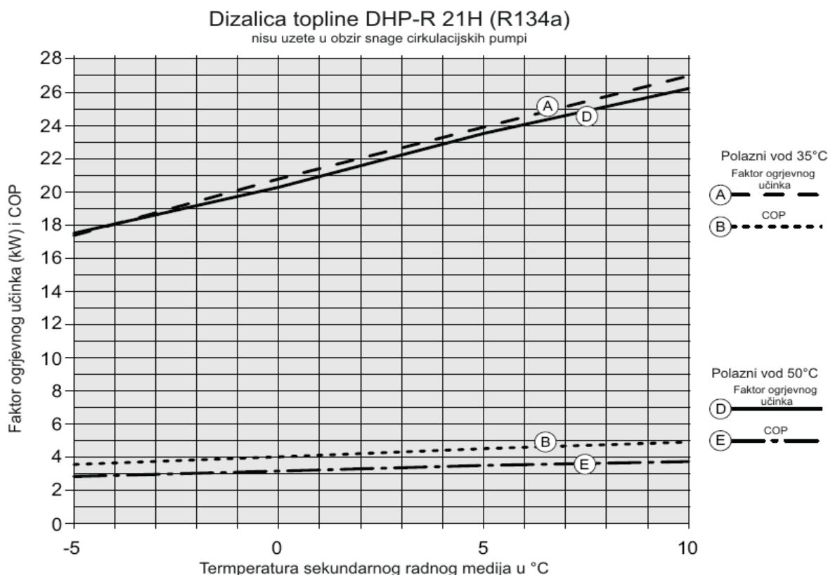
Slika 16. Primjer radnih karakteristika uređaja dizalice topline [10]
