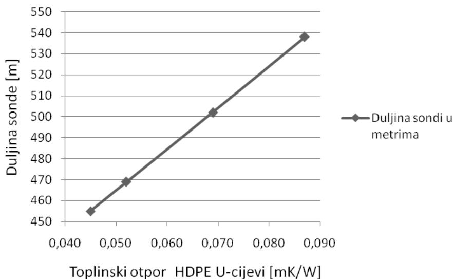
Slika 21. Utjecaj termofizikalnih karakteristika materijala cijevi izmjenjivača topline na duljinu vertikalnih sondi
