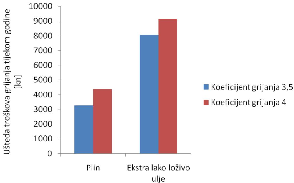
Slika 31. Ušteda pogonskih troškova sustava grijanja u ovisnosti o sezonskom koeficijentu grijanja dizalice topline s tlom
