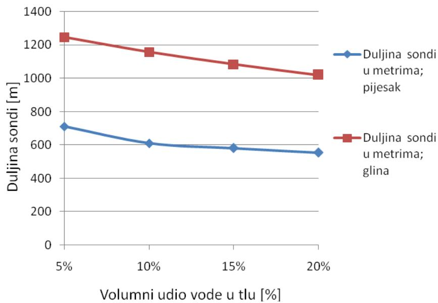
Slika 20. Utjecaj sadržaja vode u tlu na duljinu vertikalnih sondi
