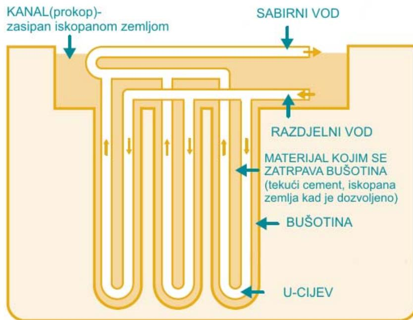
Slika 12. Osnovni dijelovi izvedbe sustava dizalica topline s vertikalnim sondama [6]
