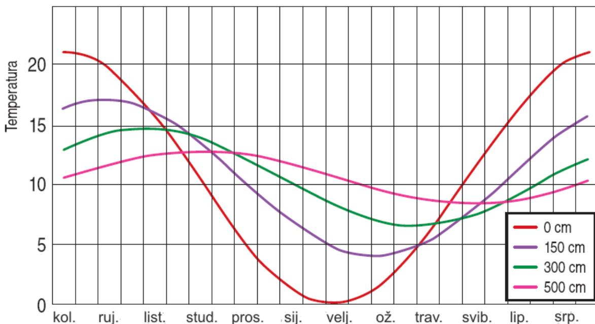
Slika 9. Raspodjela temperatura tla tijekom godine u ovisnosti o dubini tla iskazana u centimetrima [7]
