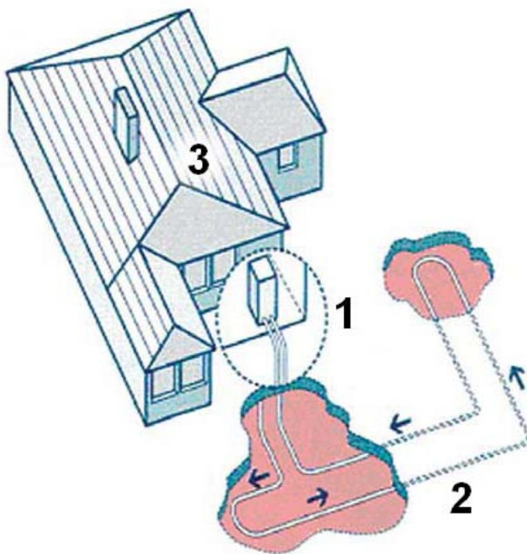
Slika 10. Prikaz osnovnih komponenata termotehničkih sustava sa dizalicom topline s tlom kao toplinskim izvorom [6]
