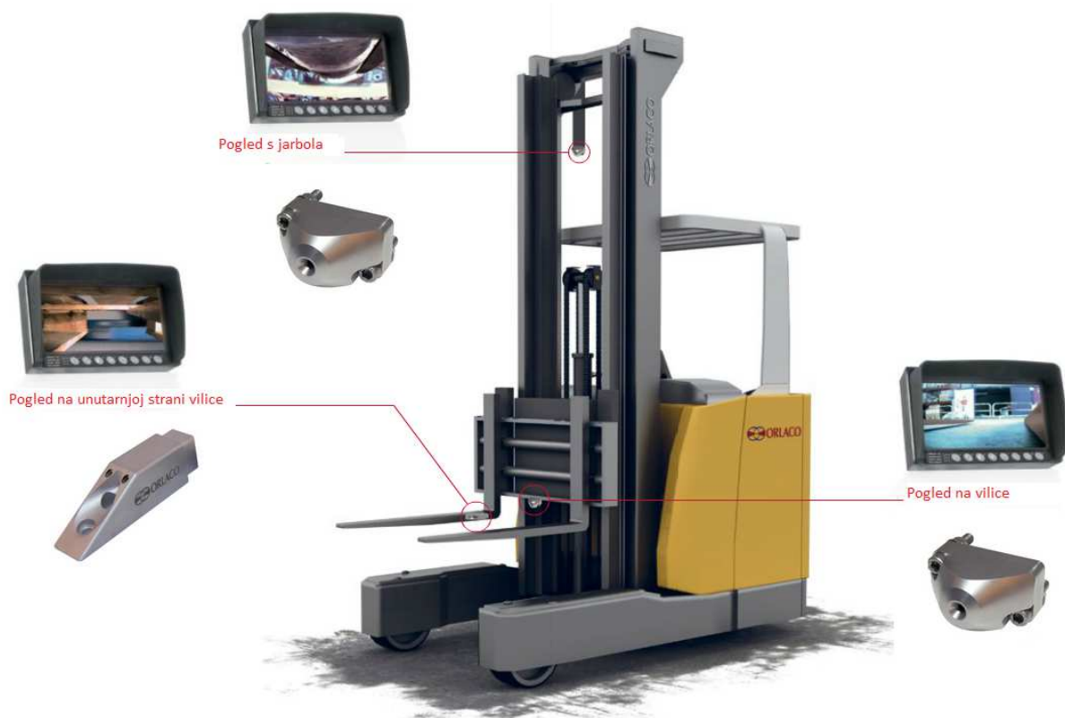
Slika 46. Mogućnosti i varijante montaže kamere [48]
