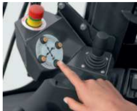
Slika 35. Kutevi zakretanja i način upravljanja [39]
