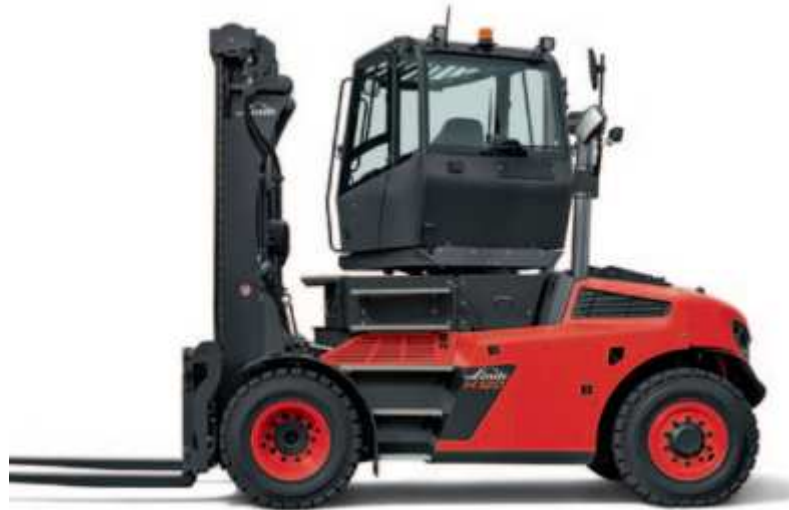
Slika 34. Viličar sa rotirajućom kabinom, Linde H120 [39]
