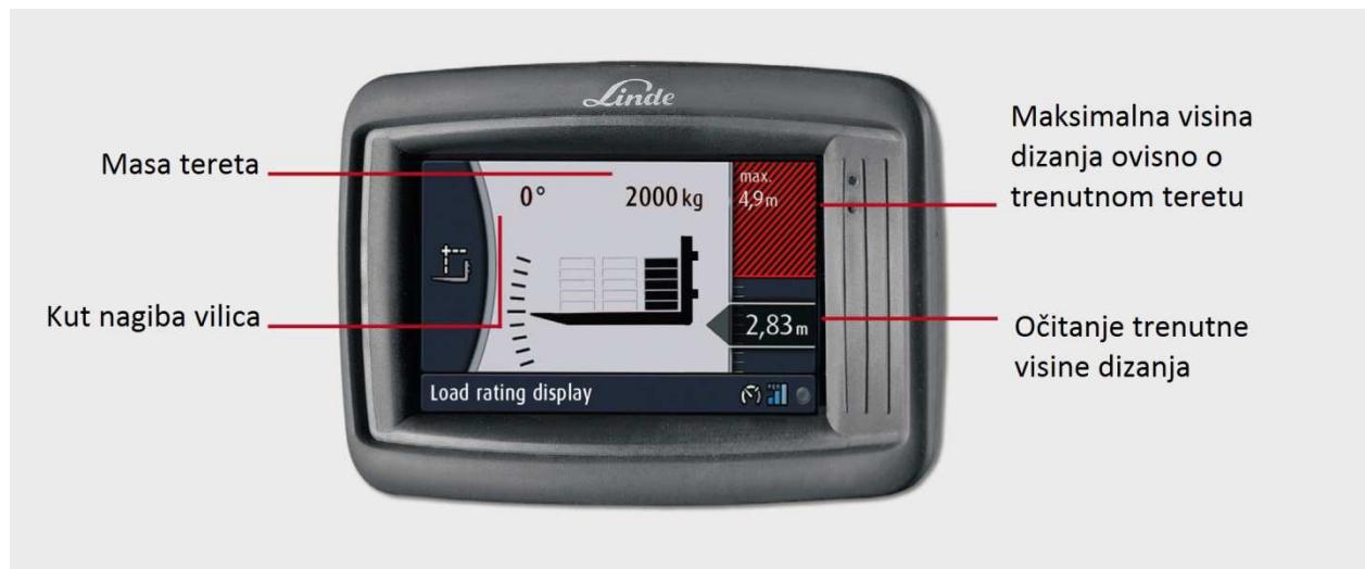
Slika 42. Prikaz trenutnih parametara prijevoza tereta i ograničenja na "Safety Pilot" ekranu [38]
