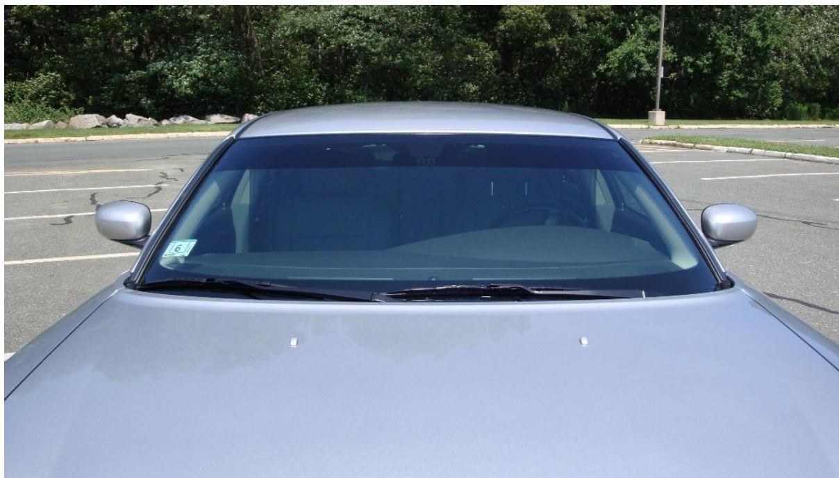
Slika 22. Zatamnivanje gornjeg dijela vjetrobranskog stakla
