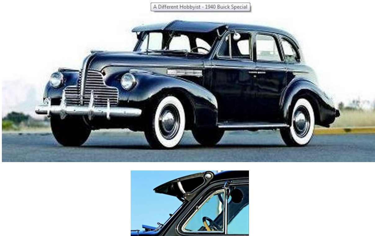
Slika 2. Podesivo vanjsko sjenilo, Buick Special iz 1940.godine
