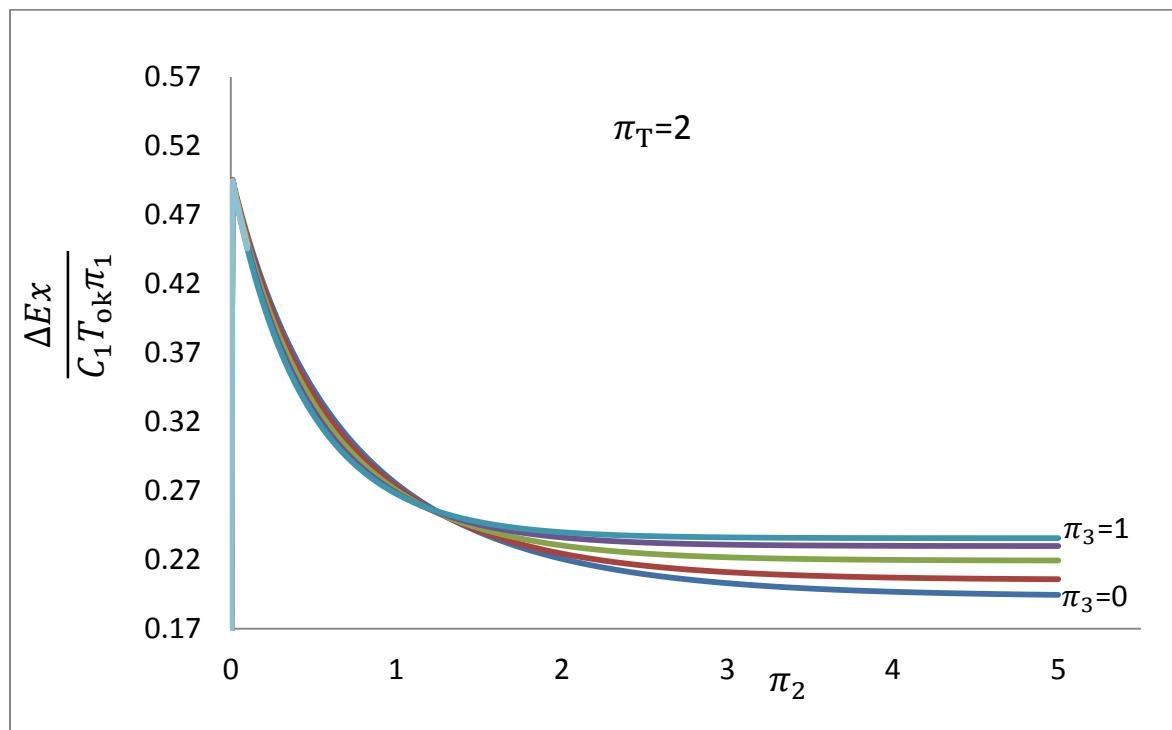
Slika 10. Omjer eksergijske destrukcije i iskoristivosti topline istosmjernog rekuperatora za  $\pi_T=2$ . Jednako kao i u prošla dva slučaja potrebno je odrediti vrijednost omjera bezdimenzijske destrukcije i iskoristivosti topline rekuperatora kada  $\pi_2 \rightarrow 0$ . Shodno tome, koristeći jednadžbu (68) te uvrštavajući u jednadžbu  $\pi_T=2$  dobivamo
