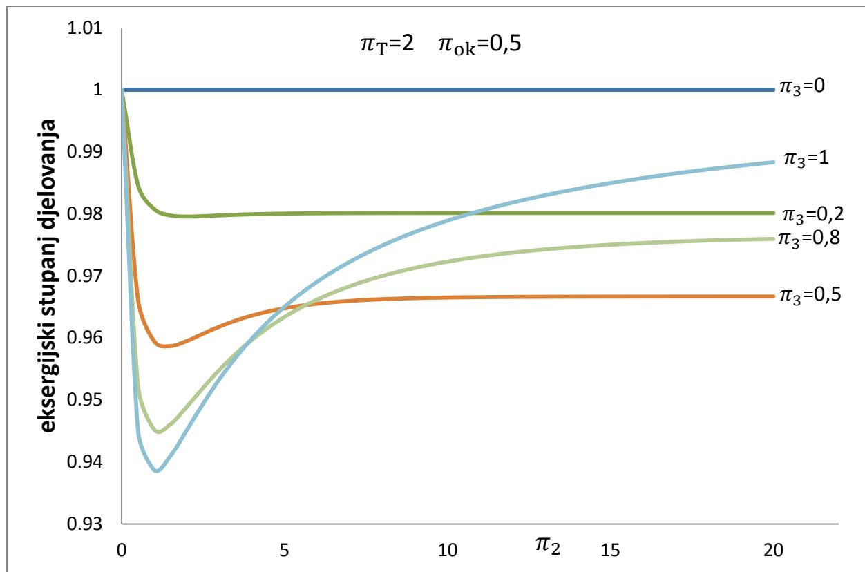
Slika 25. Eksergijski stupnja djelovanja protusmjernog rekuperatora za  $\pi_T = 2$  i  $\pi_{ok} = 0,5$
