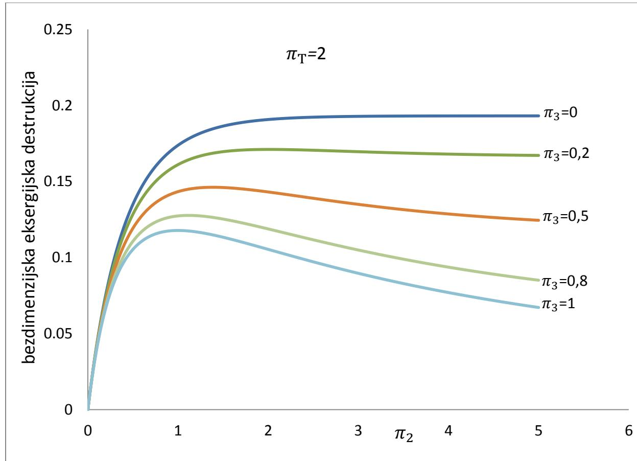
Slika 19. Bezdimenzijska eksergijska destrukcija protusmjernog rekuperatora za  $\pi_T=2$
