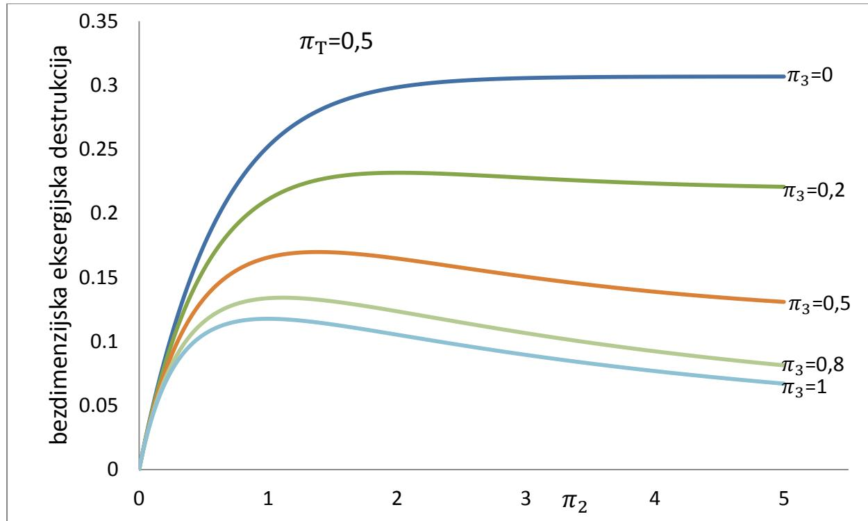
Slika 18. Bezdimenzijska eksergijska destrukcija protusmjernog rekuperatora za  $\pi_T=0,5$
