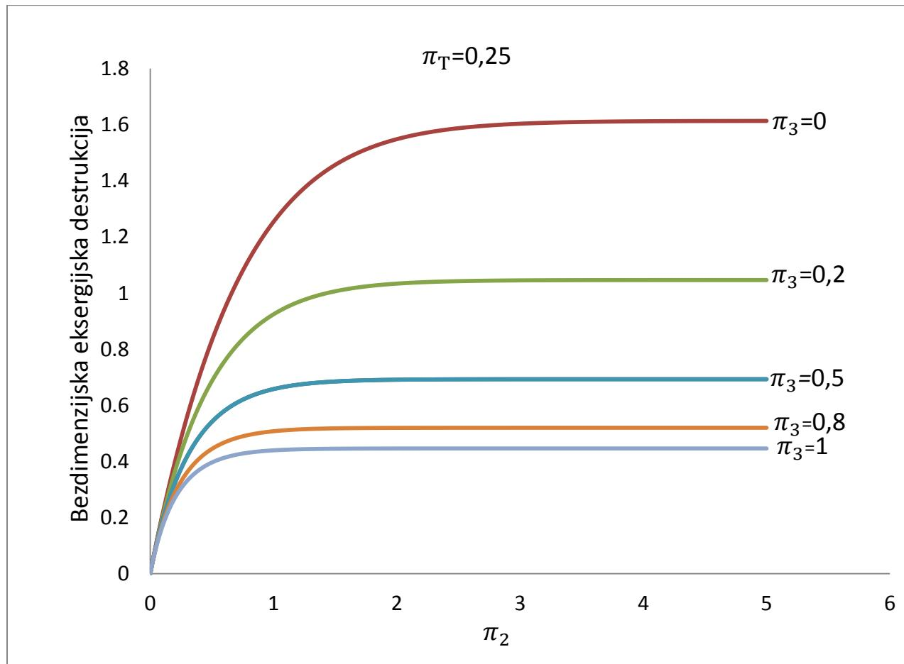
Slika 4. Bezdimenzijska eksergijska destrukcija istosmjernog rekuperatora za  $\pi_T=0,25$
