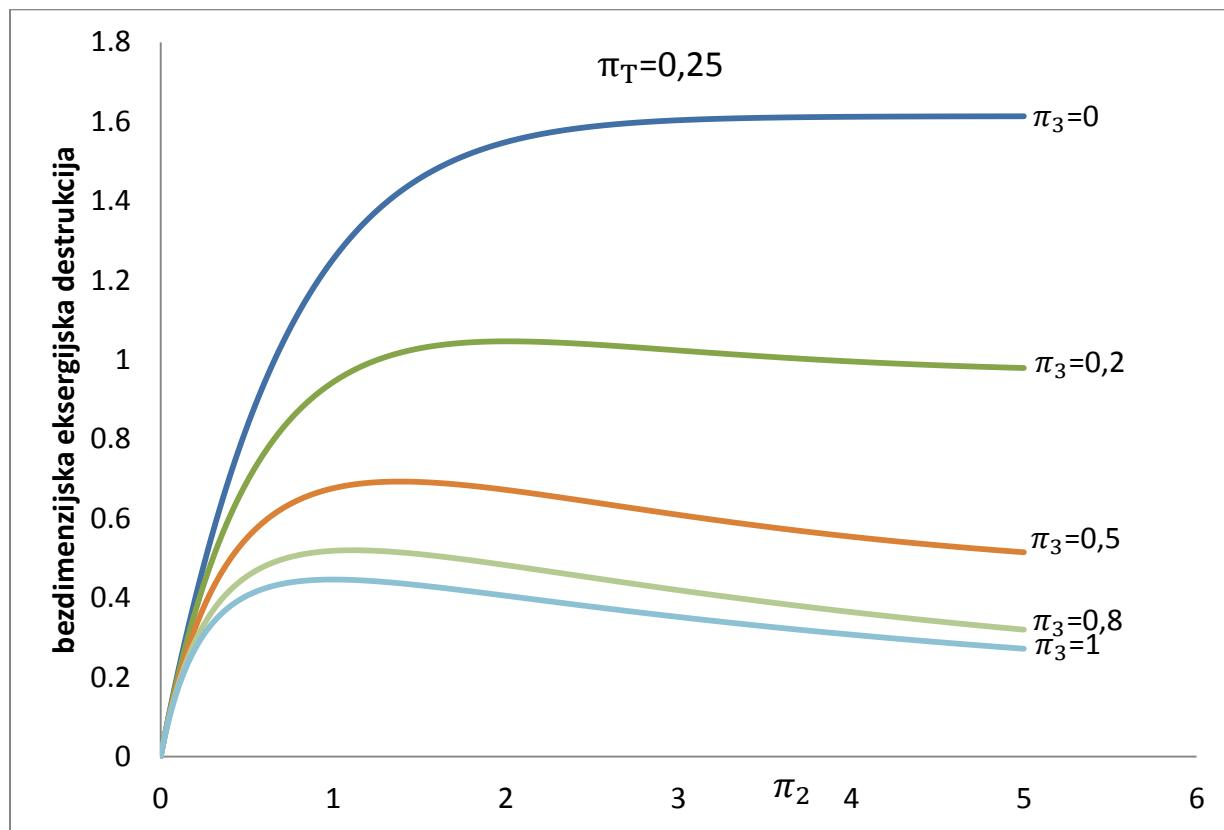
Slika 17. Bezdimenzijska eksergijska destrukcija protusmjernog rekuperatora za  $\pi_T=0,25$
