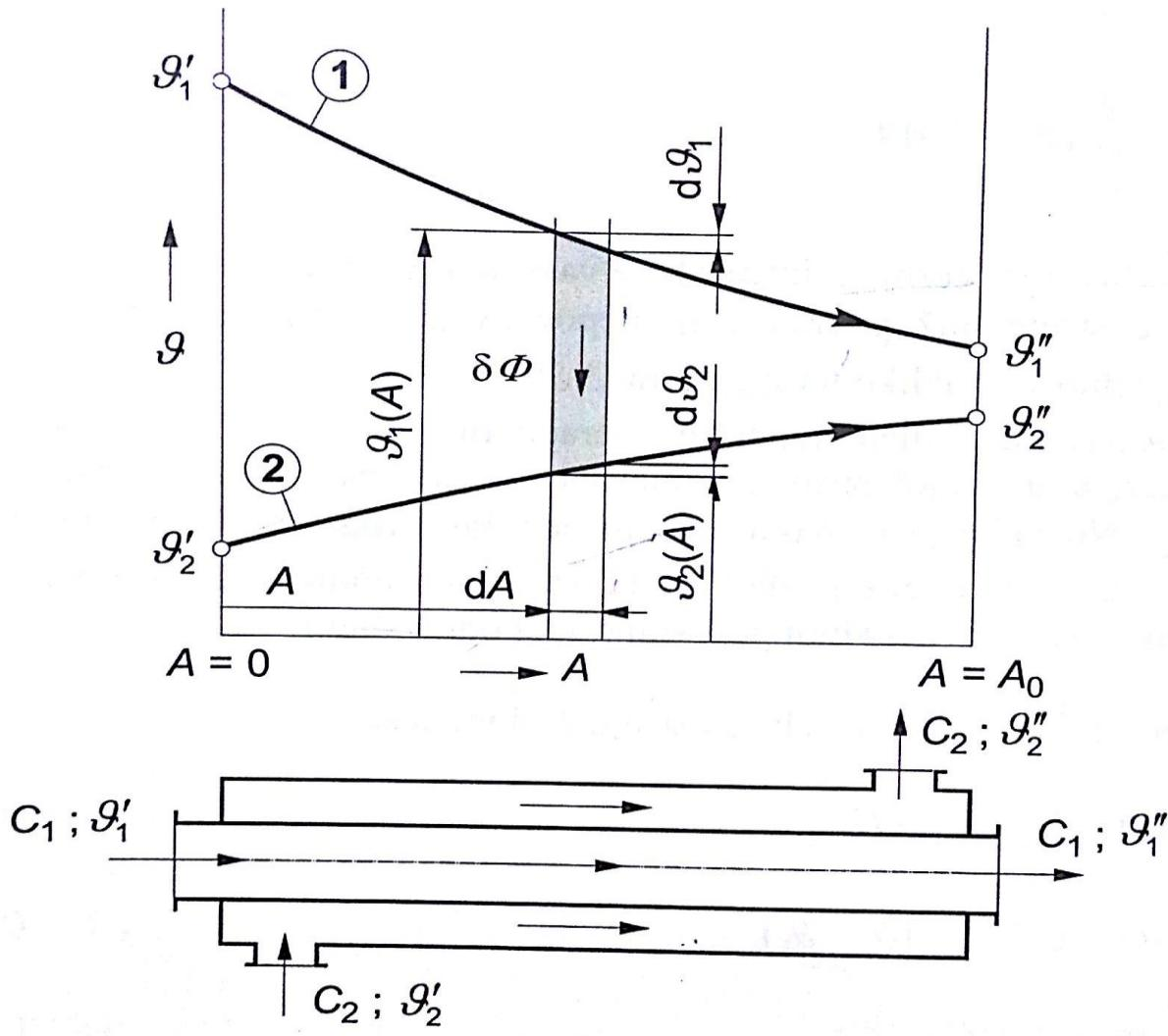
Slika 3. Dijagramski prikaz temperaturne raspodjele struja u ovisnosti o površini istosmjernog rekuperatora [2]
