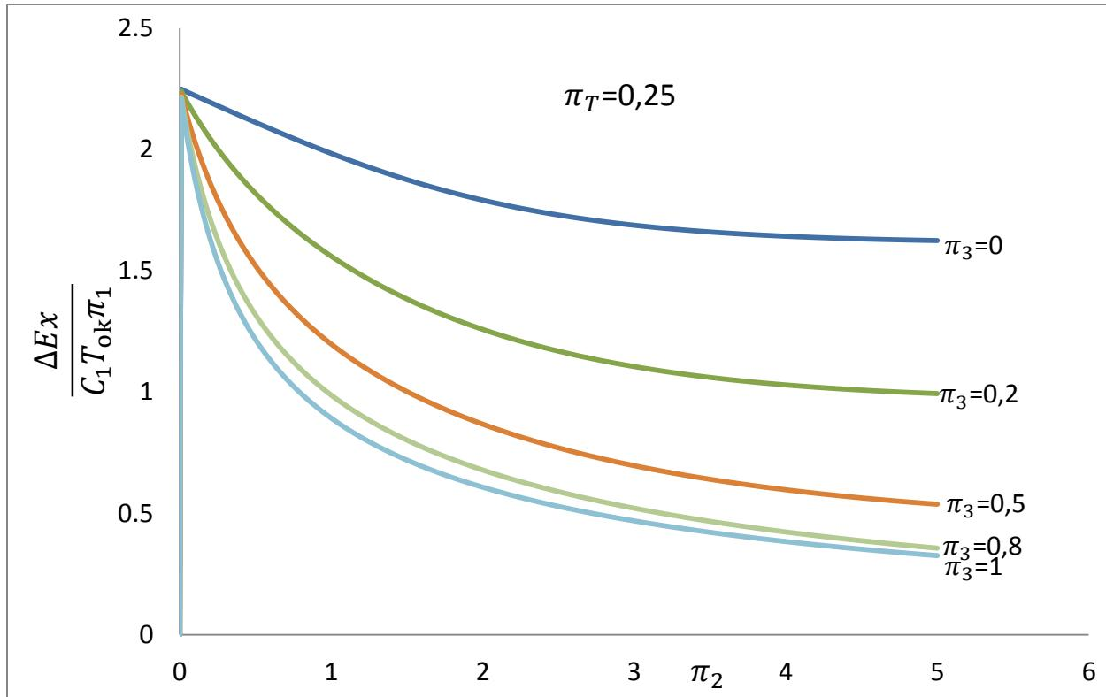
Slika 20. Omjer eksergijske destrukcije i iskoristivosti topline protusmjernog rekuperatora za  $\pi_T=0,25$
