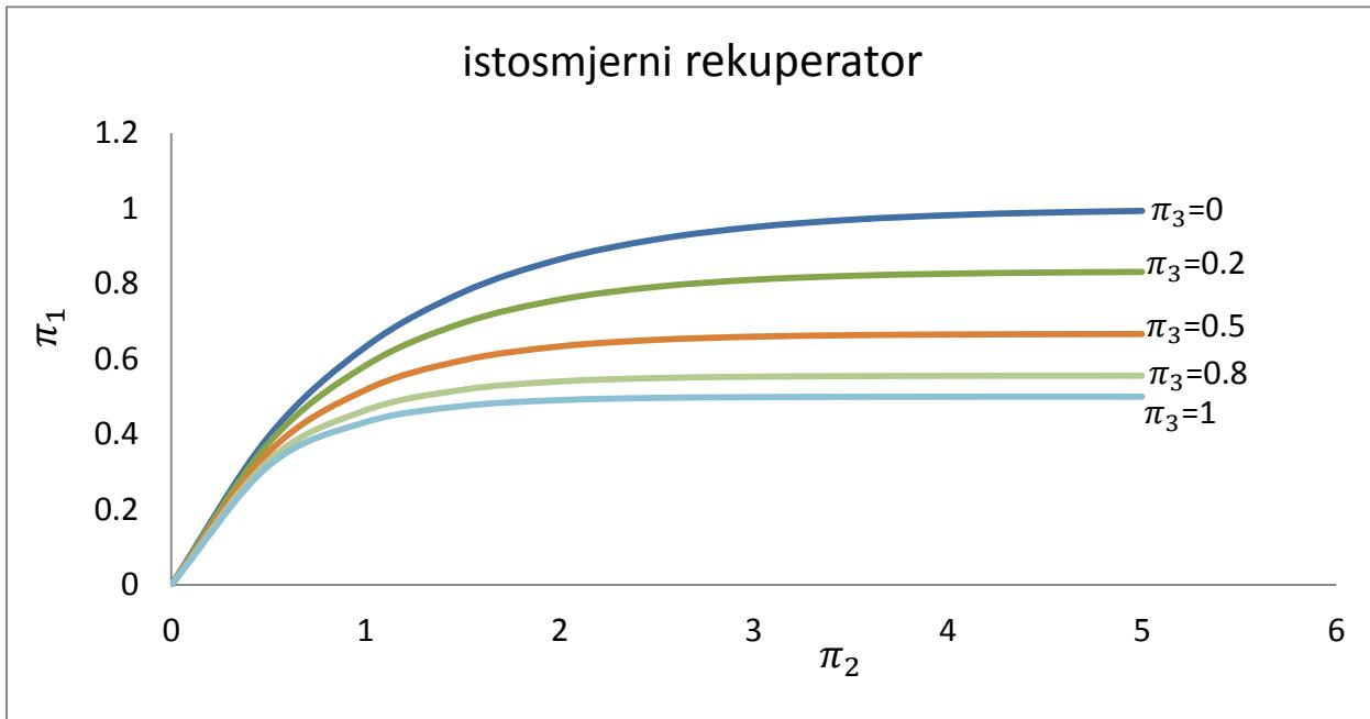
Slika 1. Dijagramski prikaz značajke  $\pi_1$  za istosmjerni rekuperator
