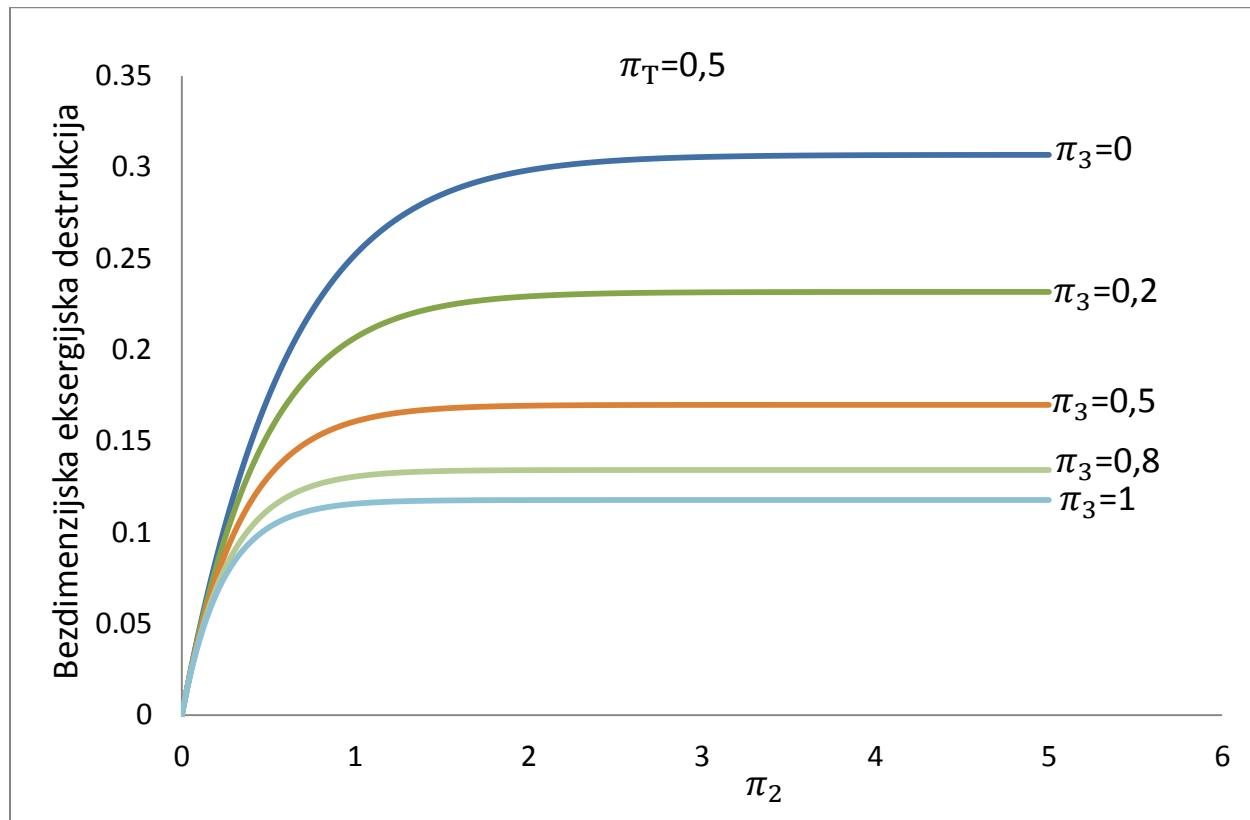
Slika 5. Bezdimenzijska eksergijska destrukcija istosmjernog rekuperatora za  $\pi_T=0,5$
