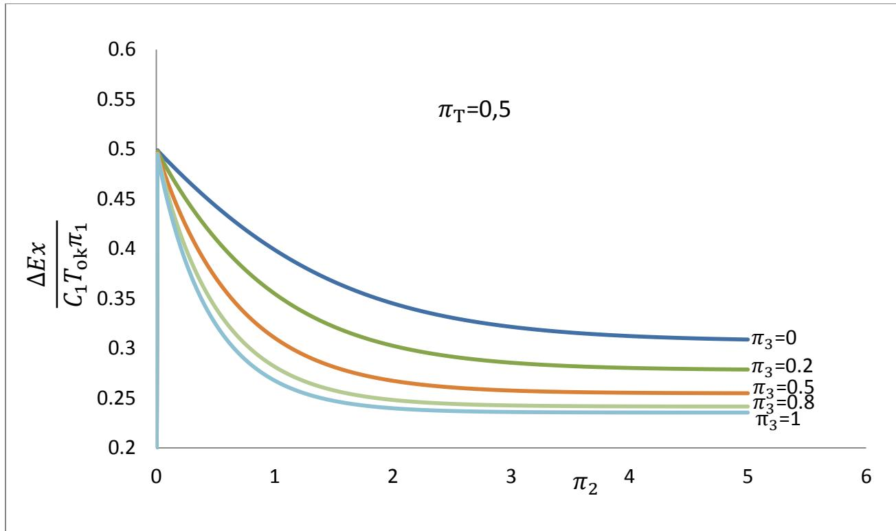
Slika 9. Omjer eksergijske destrukcije i iskoristivosti topline istosmjernog rekuperatora za  $\pi_T=0,5$
