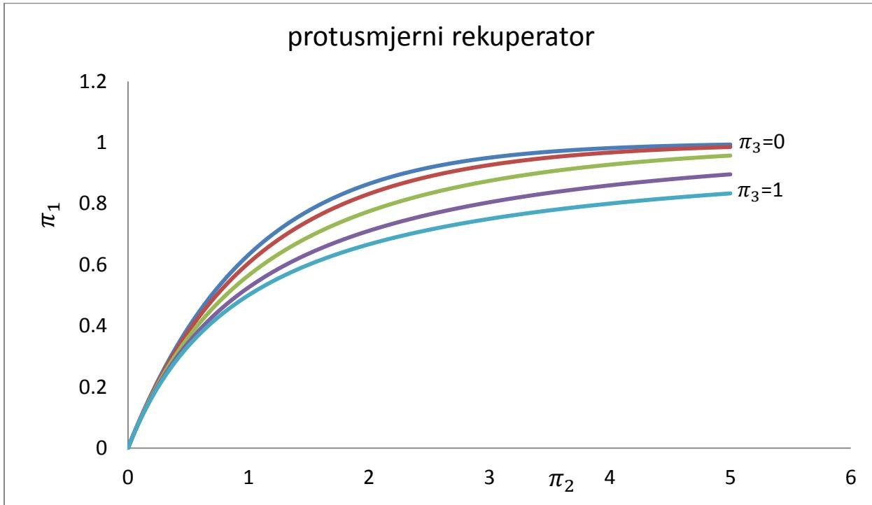
Slika 2. Dijagramski prikaz značajke  $\pi_1$  za protusmjerni rekuperator
