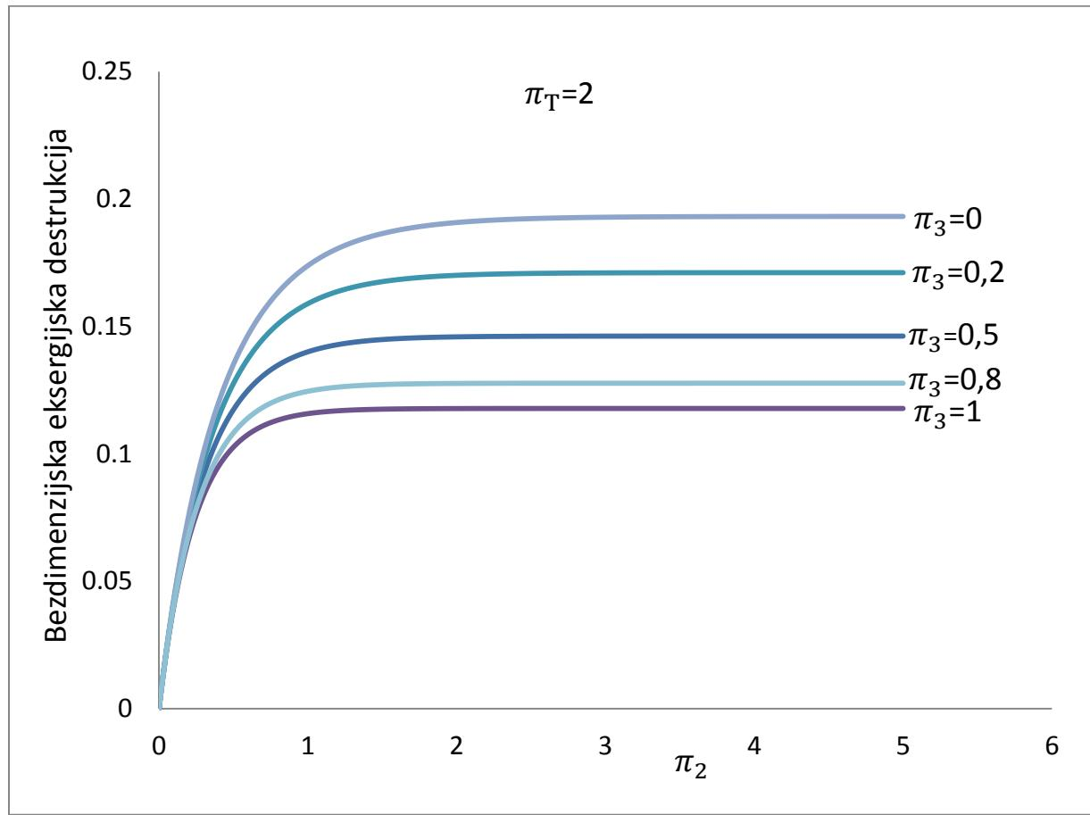
Slika 6. Bezdimenzijska eksergijska destrukcija istosmjernog rekuperatora za  $\pi_T=2$
