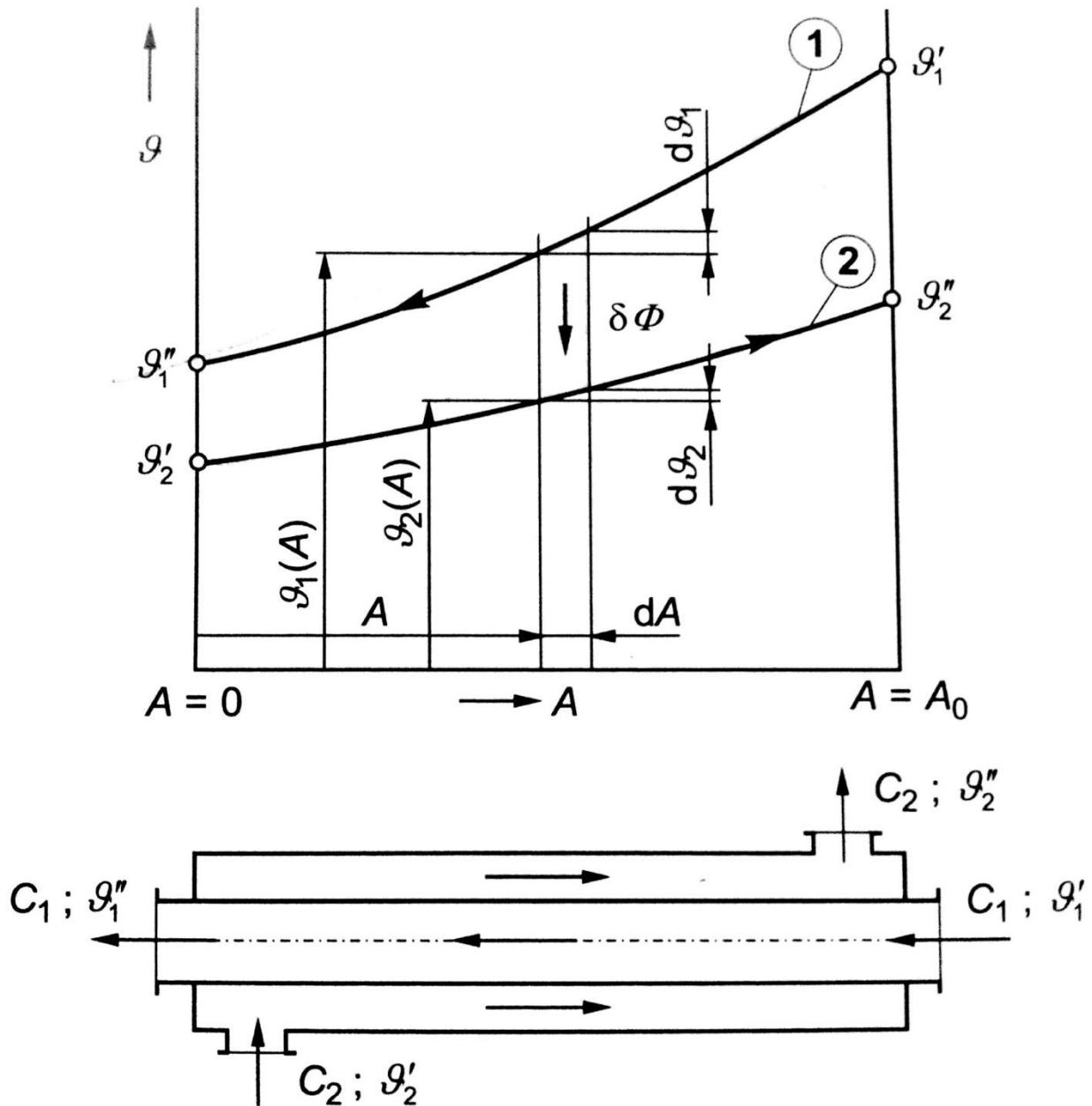
Slika 16. Dijogramski prikaz temperaturne raspodjele struja u ovisnosti o površini protusmjernog rekuperatora [2]
