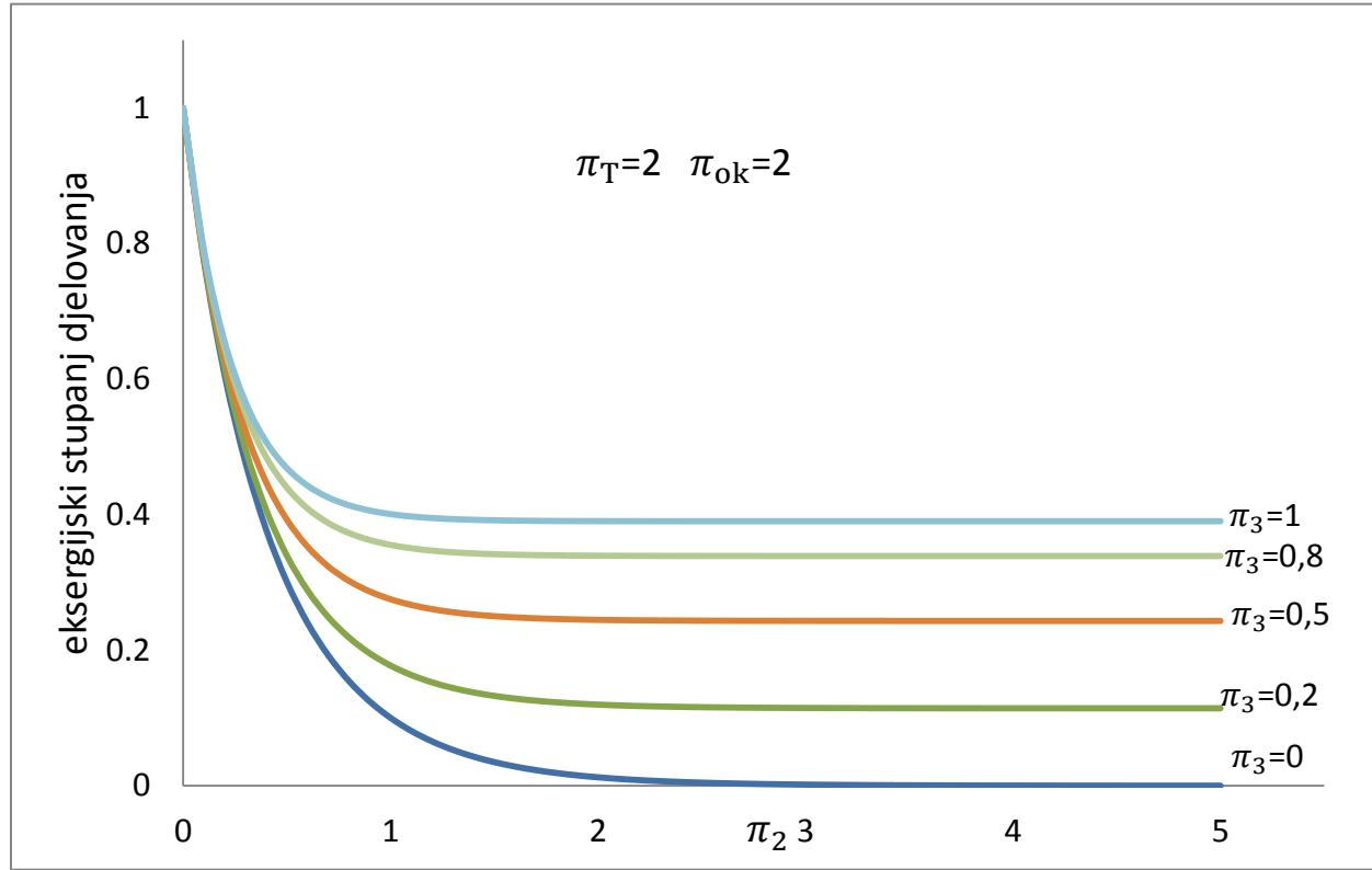
Slika 14. Eksergijski stupanja djelovanja istosmjernog rekuperatora za  $\pi_T=2$  i  $\pi_{ok}=2$
