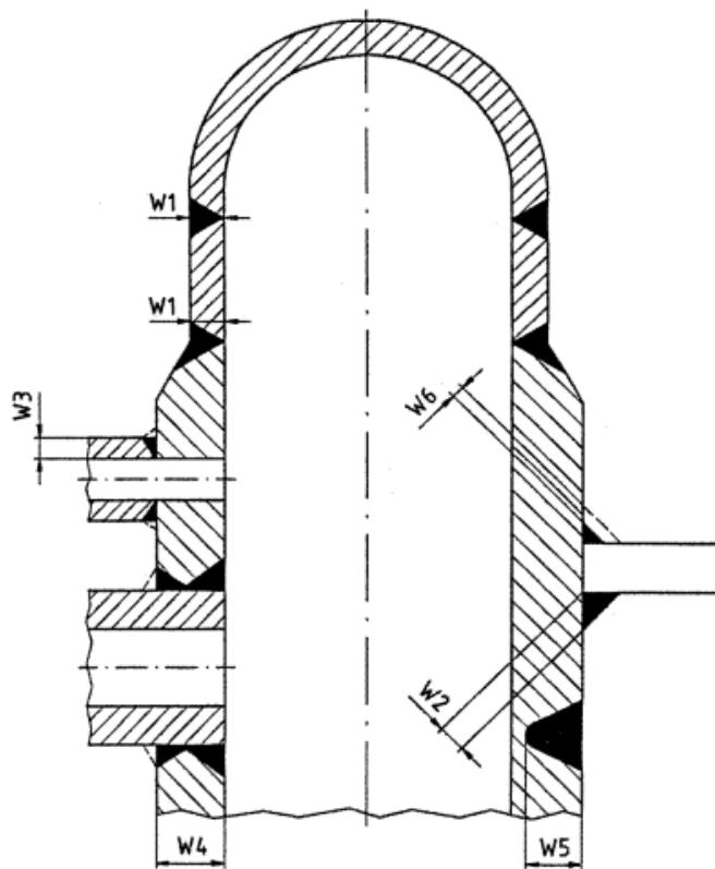
Slika 7 Primjeri kontrolnih debljina za različite vrste spojeva [11]
