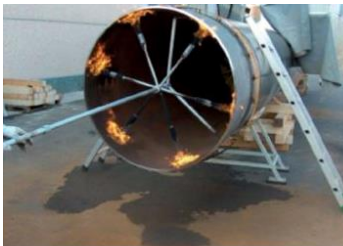
Slika 14 Toplinska obrada plinskim plamenom [18]
