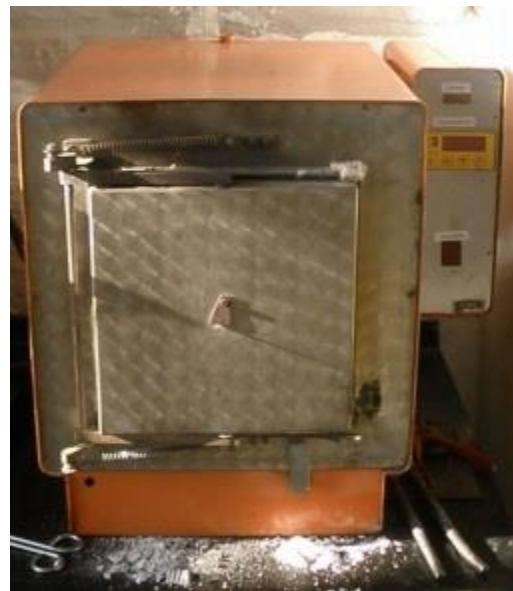
Slika 20 Komorna peć za žarenje [23].
