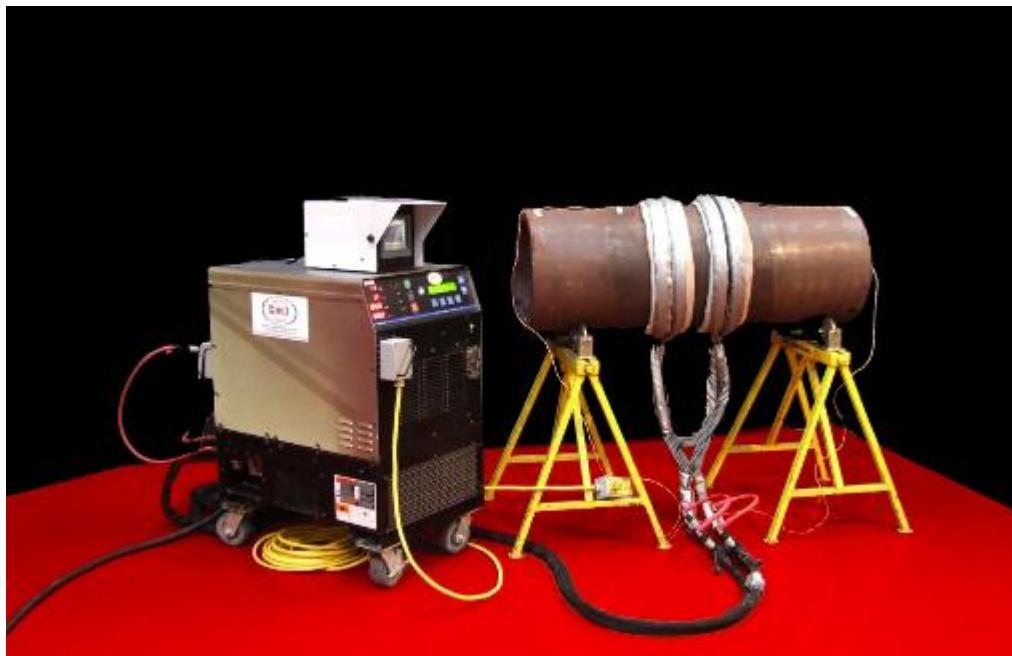
Slika 16 Oprema za induksijsko zagrijavanje [19]
