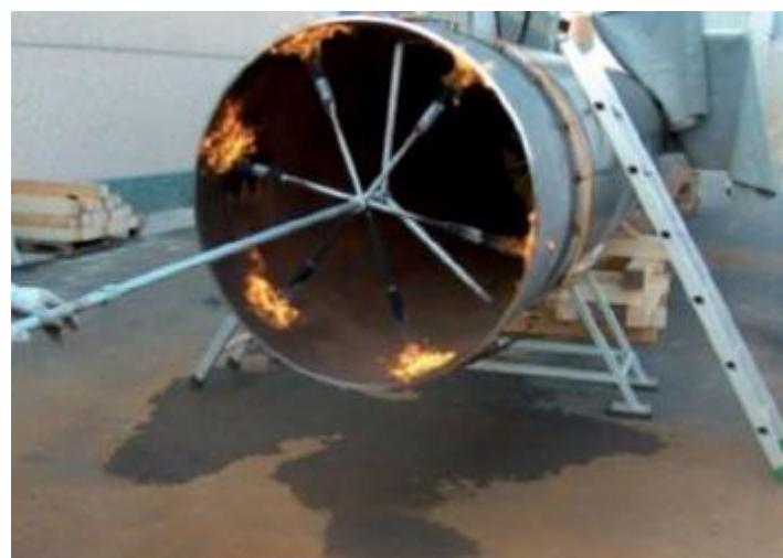
Slika 14 Toplinska obrada plinskim plamenom [18]
