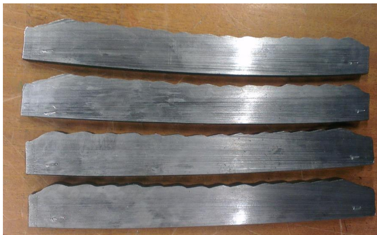
Slika 25 Epruvete izrezane iz ploča navarenih AISI 410 materijalom
