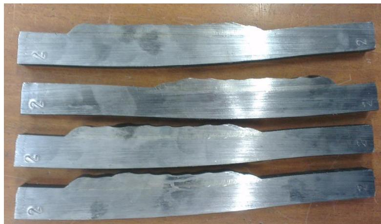
Slika 26 Epruvete izrezane iz ploča navarenih AISI 410 materijalom
