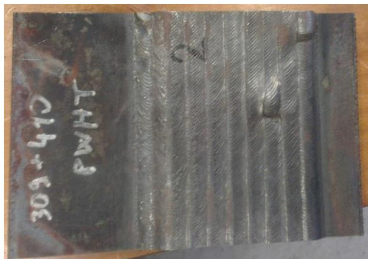
Slika 23 Ploča navarena materijalima AISI 309 i AISI 410
