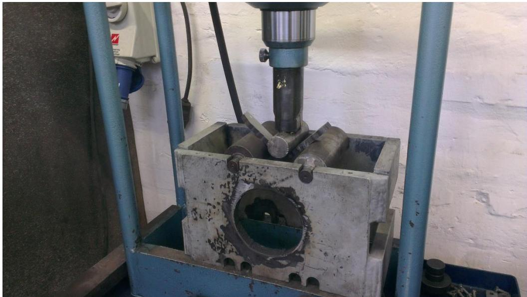
Slika 27 Provođenje ispitivanja na bočno savijanje
