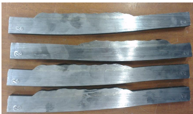
Slika 26 Epruvete izrezane iz ploča navarenih AISI 410 materijalom
