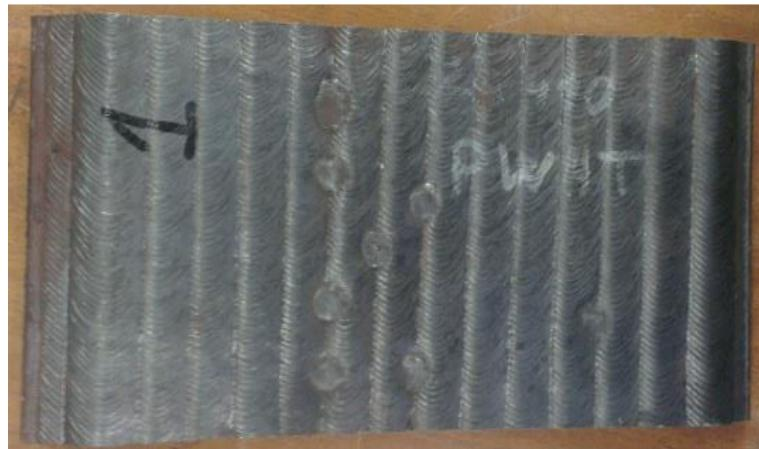
Slika 22 Ploča navarena AISI 410 materijalom
