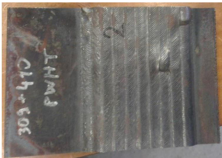
Slika 23 Ploča navarena materijalima AISI 309 i AISI 410
