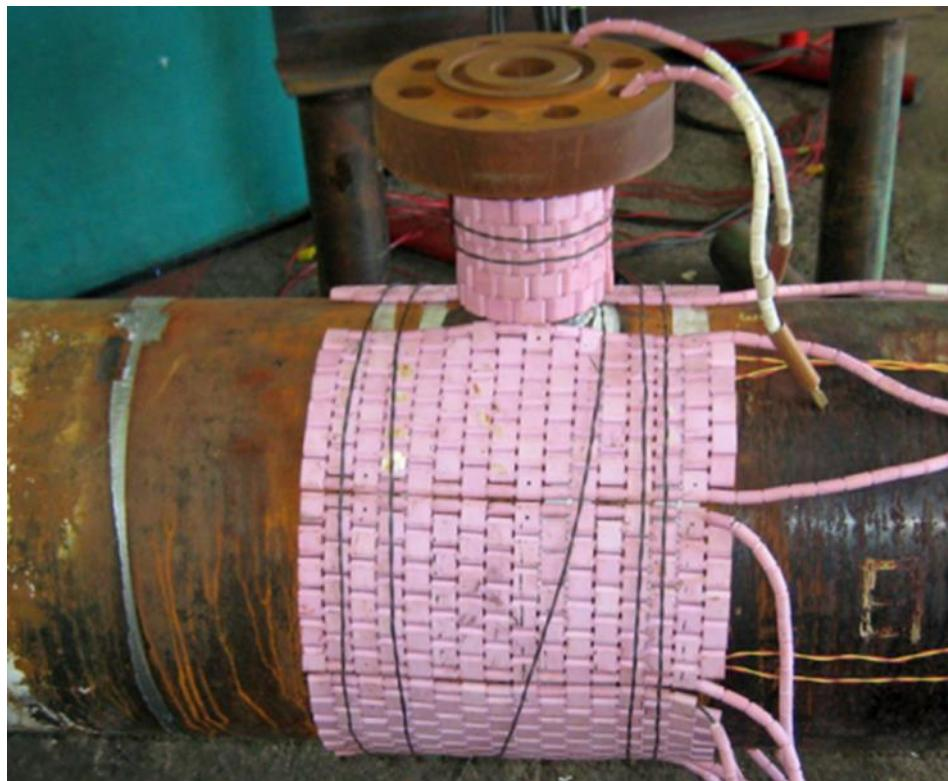
Slika 17 Grijaća tijela za elektrootporno zagrijavanje [19]
