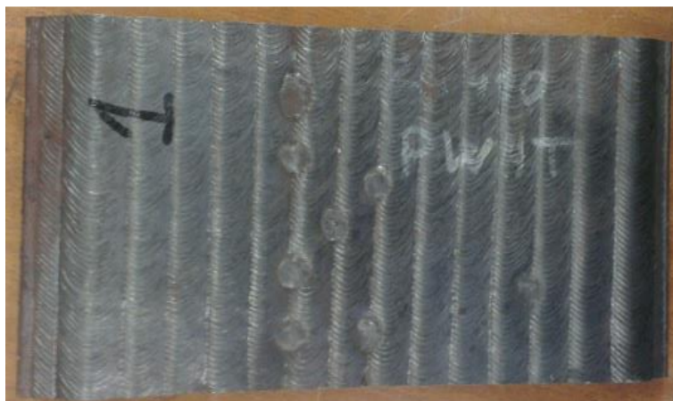
Slika 22 Ploča navarena AISI 410 materijalom
