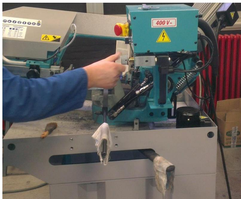
Slika 24 Izrezivanje uzorka na tračnoj pili
