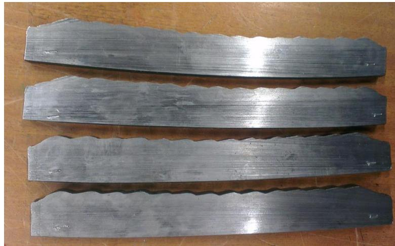
Slika 25 Epruvete izrezane iz ploča navarenih AISI 410 materijalom
