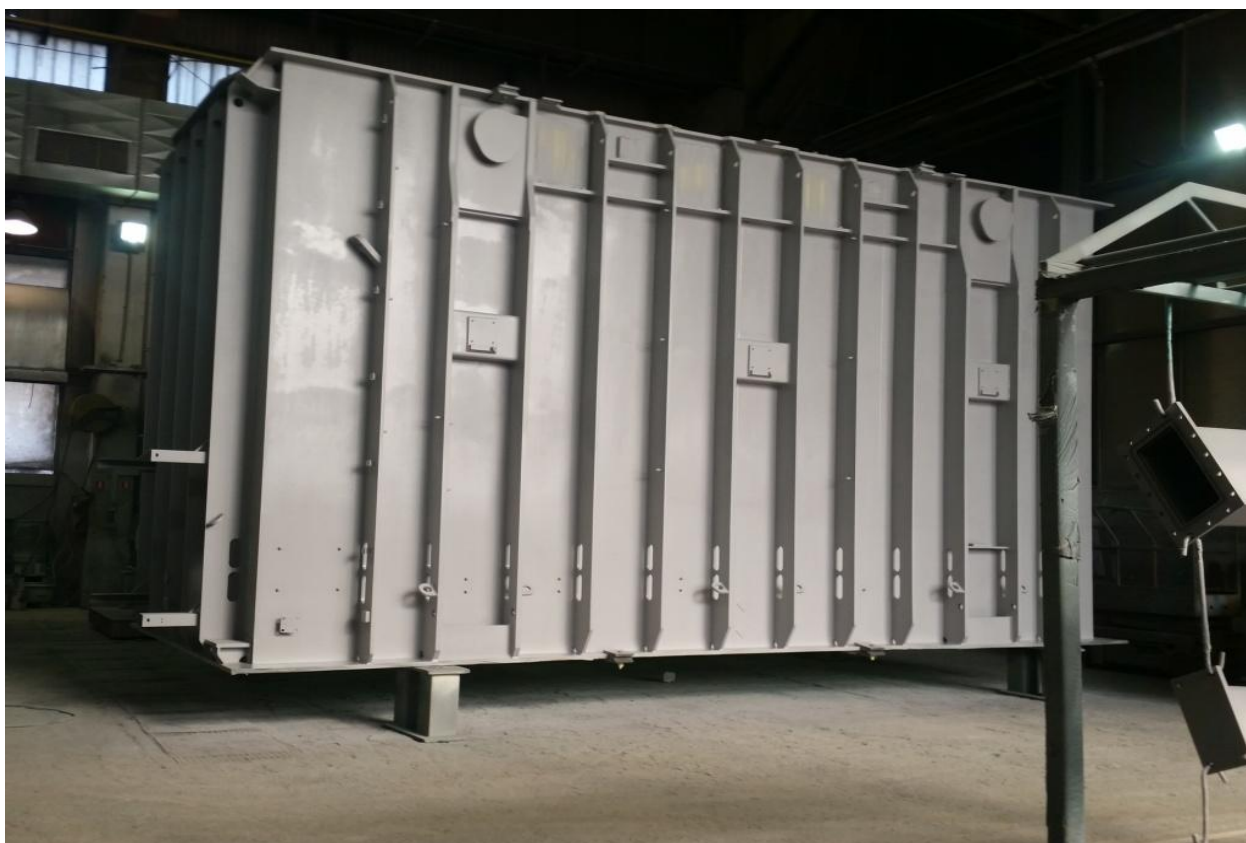
Slika 27. Sušenje transformatorskog kotla nakon nanesenog prvog premaza
