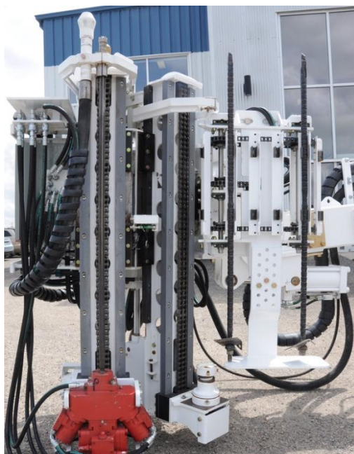
Slika 14. Prikaz sustava za dobavu sidra
