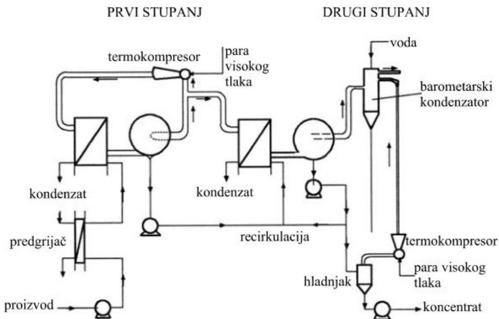
Slika 9. Dvostupanjskaisparna stanica s pločastim izmjenjivačem topline[4]
