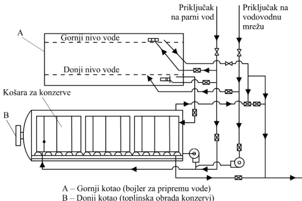
Slika 6. Normalni autoclav s hlađenjem pod tlakom[4]
