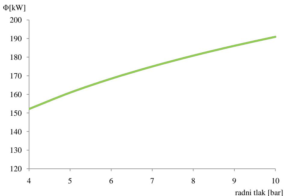
Slika 18. Ovisnost toplinskog toka o radnom tlaku
