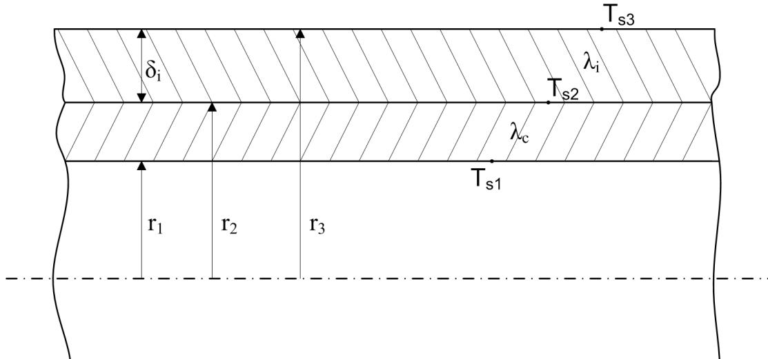
Slika 14. Provođenje kroz stijenkiju cijevi i izolaciju
