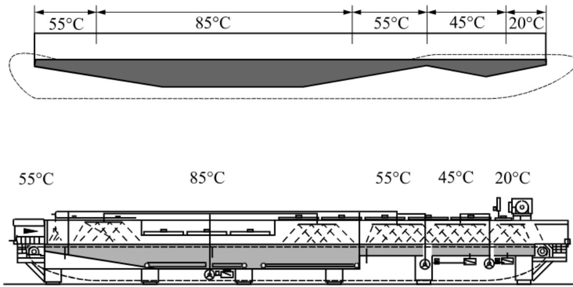
Slika 4. Tunelski pasterizator[4]
