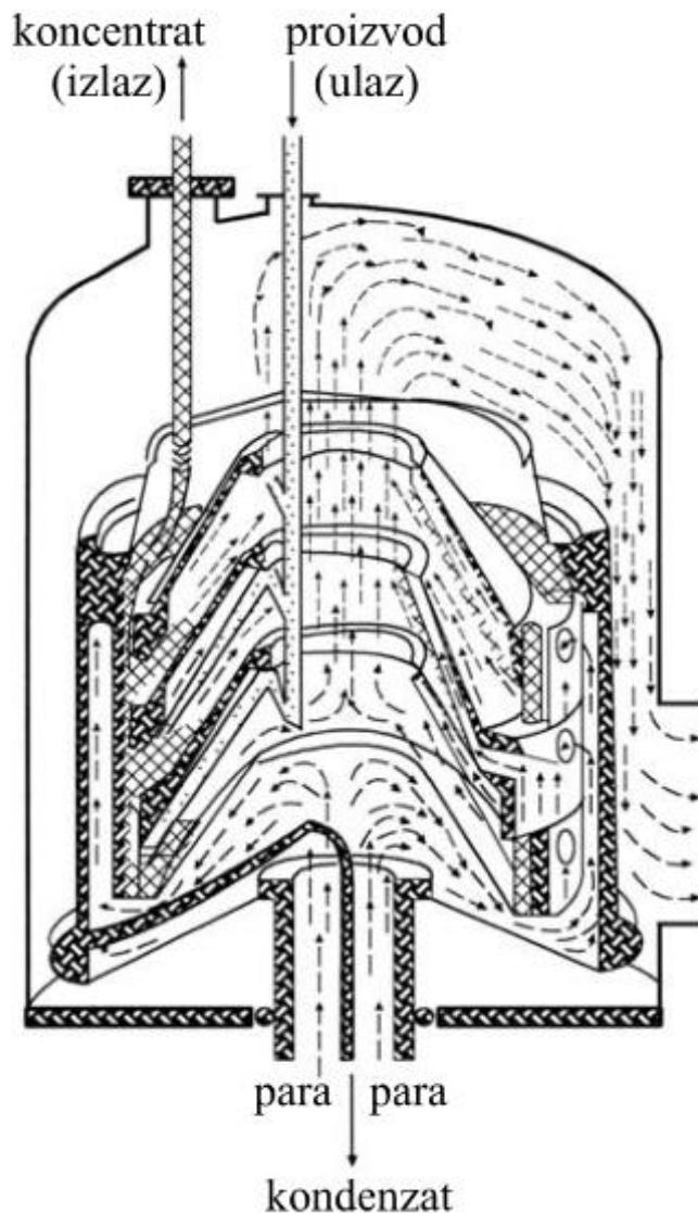
Slika 7. Centrifugalni isparivač[4]
