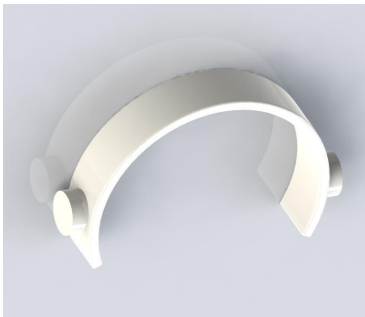
Slika 3.1. Nosač alata robota za neurokirurgiju
