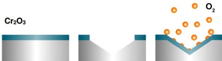
Slika 1. Mehanizam obnove pasivnog filma  $\text{Cr}_2\text{O}_3$  [4]
