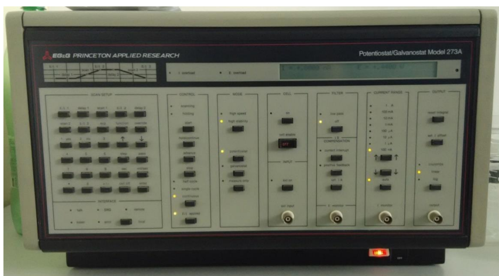
Slika 16. Potenciostat/Galvanostat Model 273A
