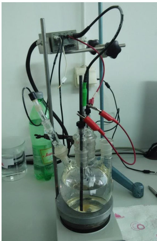
Slika 17. Elektrokemijska ćelija s troelektrodnim sustavom
