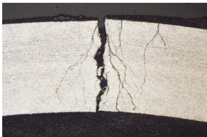
Slika 8. Poprečni presjek pukotine nastale napetosnom korozijom na čeliku AISI 304 izloženom običnoj vodi temperature 60 °C [12]
