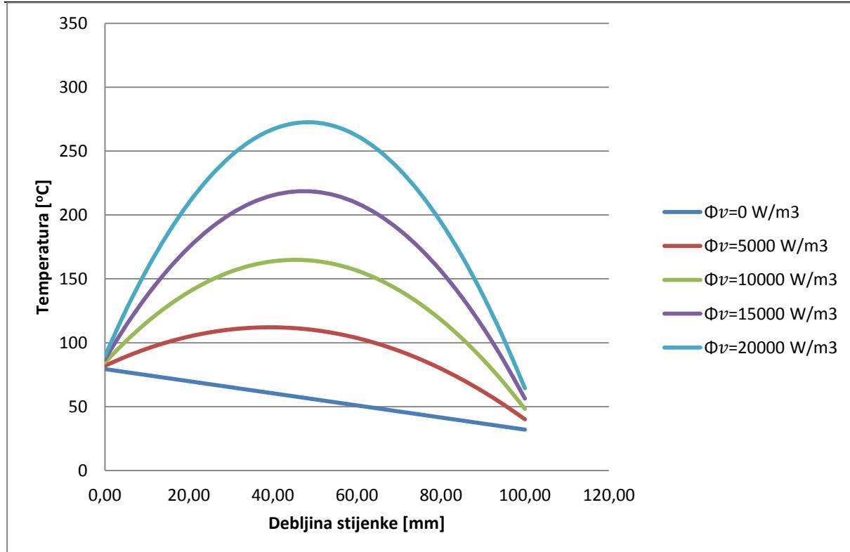
Slika 7. Prikaz temperaturnog polja u suhom betonu s variranjem toplinskog izvora od 0 do  $20000 \text{ W/m}^3$
