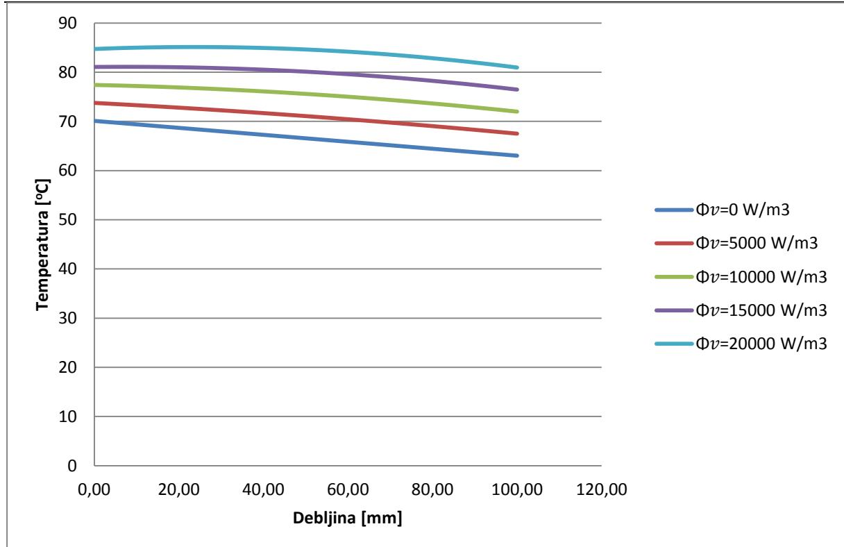
**Slika 6.** Prikaz temperaturnog polja u krom - nikl čeliku s variranjem toplinskog izvora od 0 do  $20000 \text{ W/m}^3$
