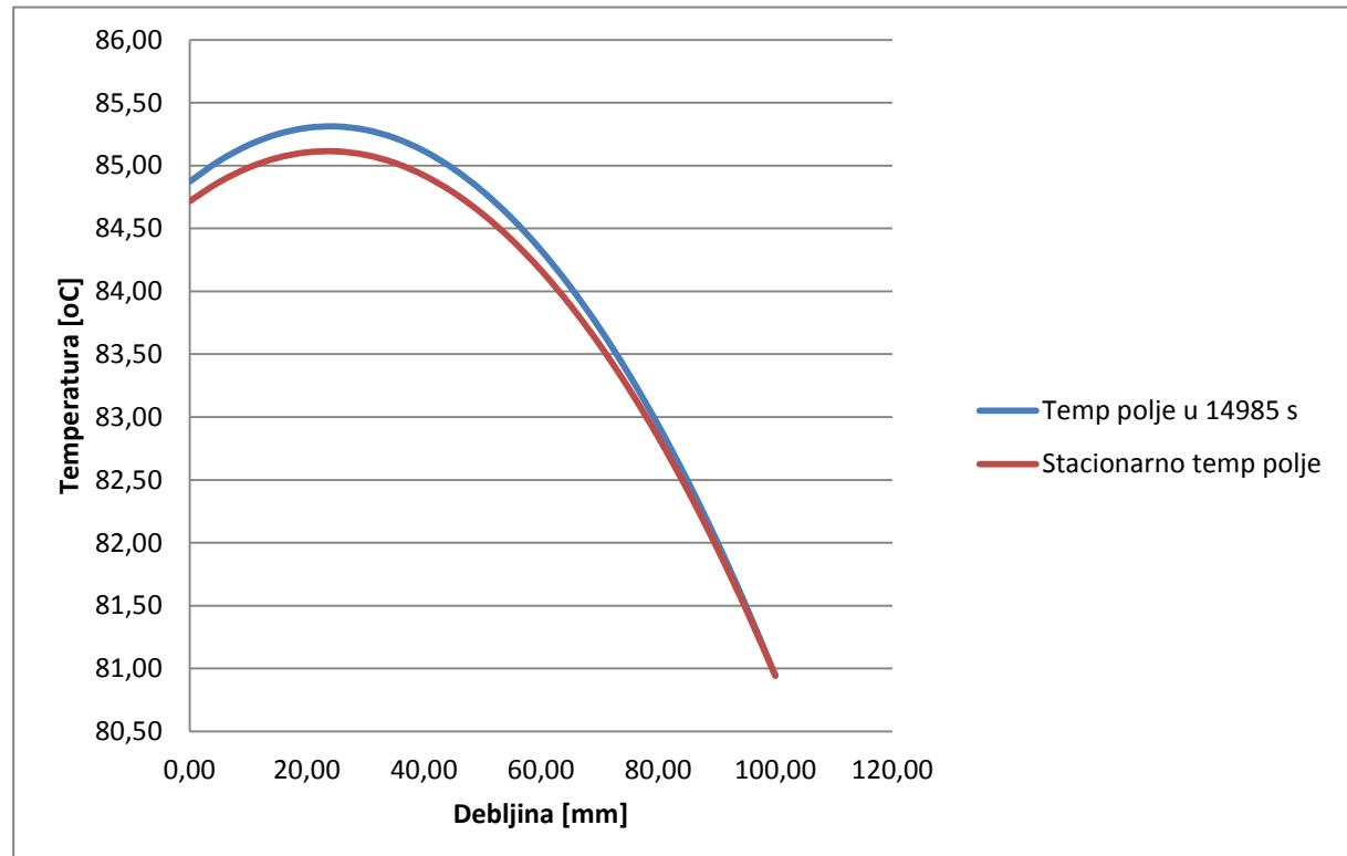
Slika 27. Aproksimacija temperaturnog polja u krom - nikl čeliku za  $\Phi_v = 20000 \text{ W/m}^3$
