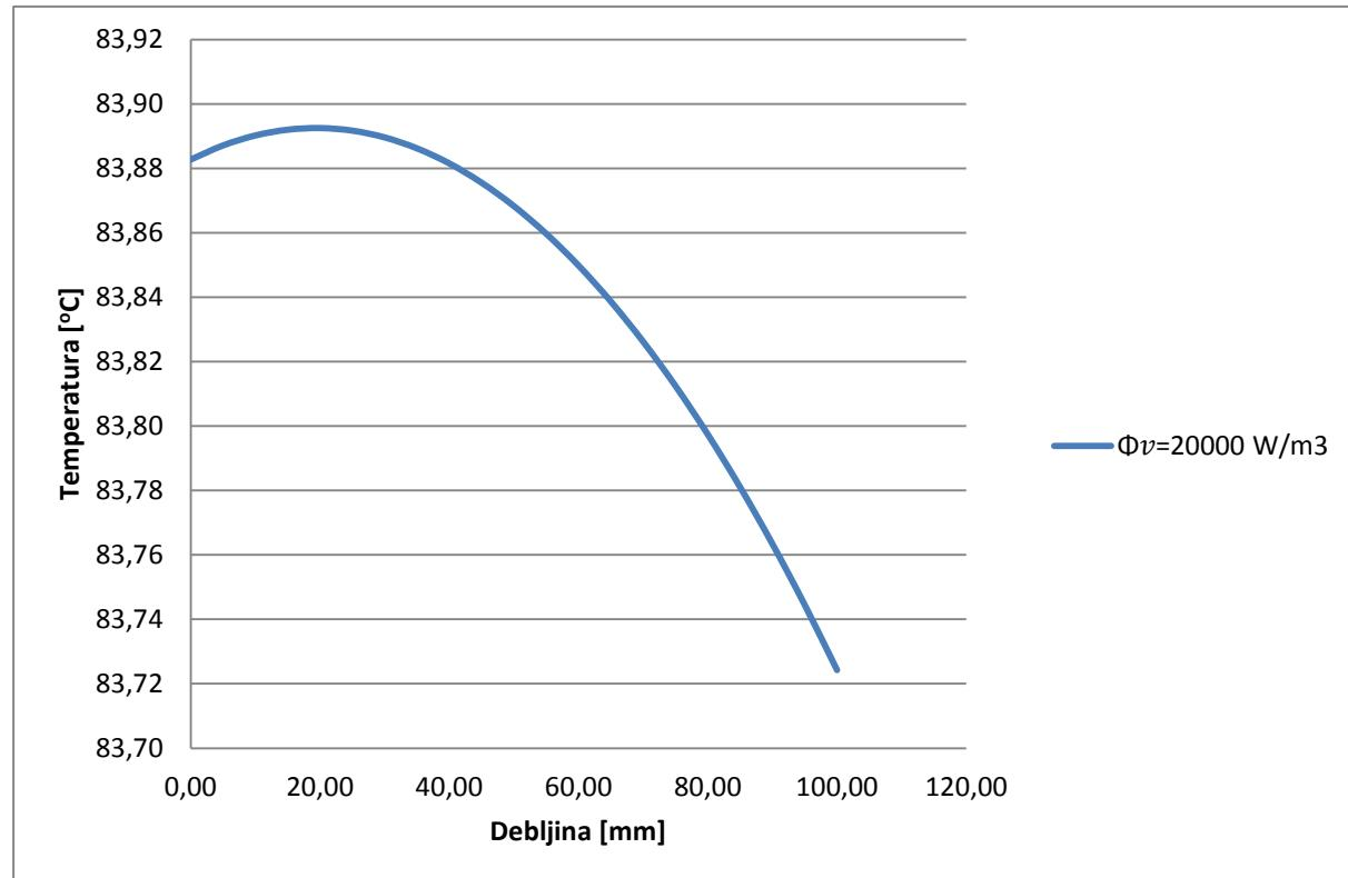
Slika 5. Prikaz temperaturnog polja u bakru za  $\Phi_v=20000 \text{ W/m}^3$
