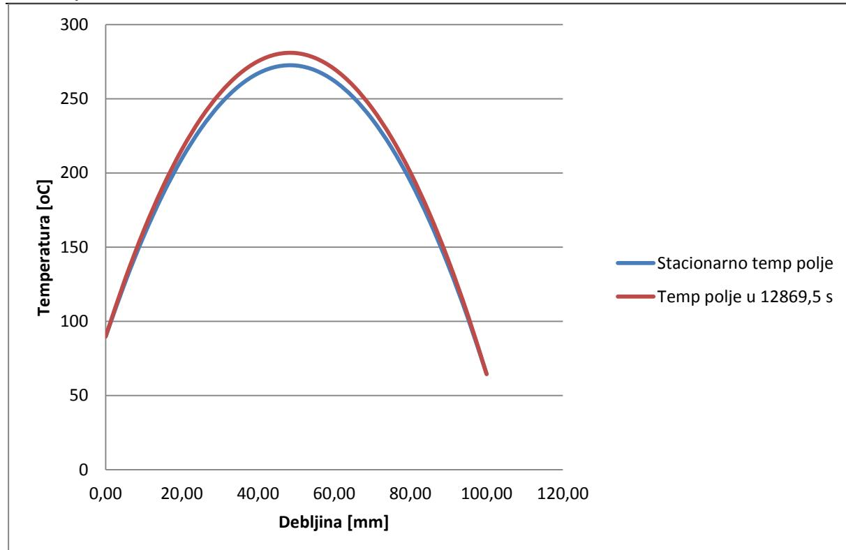
Slika 23. Aproksimacija temperaturnog polja u suhom betonu za  $\Phi_v = 20000 \text{ W/m}^3$
