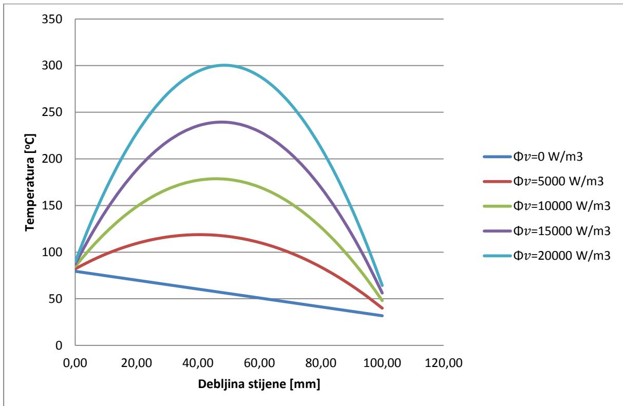
Slika 8. Prikaz temperaturnog polja u azbestu s variranjem toplinskog izvora od 0 do 20000  $\text{W/m}^3$
