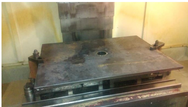
Slika 27: Ploča stegnuta za obradu
