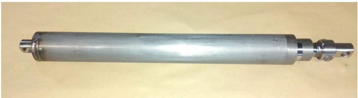
Slika 39: Sklop dvoradnog teleskopskog cilindra
