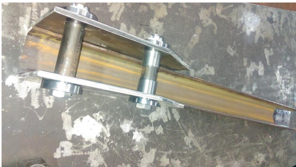
Slika 34: Sklop većeg profila i bočnih ploča
