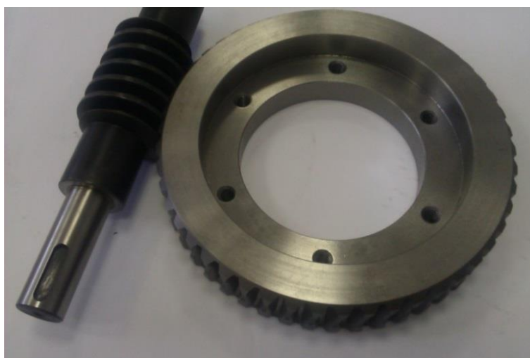
Slika 30: Izrađeno pužno kolo i pužni vijak
