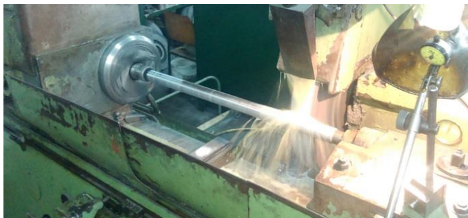
Slika 37: Vanjsko brušenje manje cijevi cilindra
