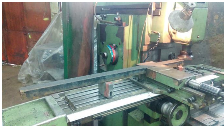
Slika 33: Obrada površine za montažu linearne vodilice
