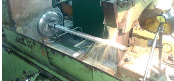
Slika 37: Vanjsko brušenje manje cijevi cilindra
