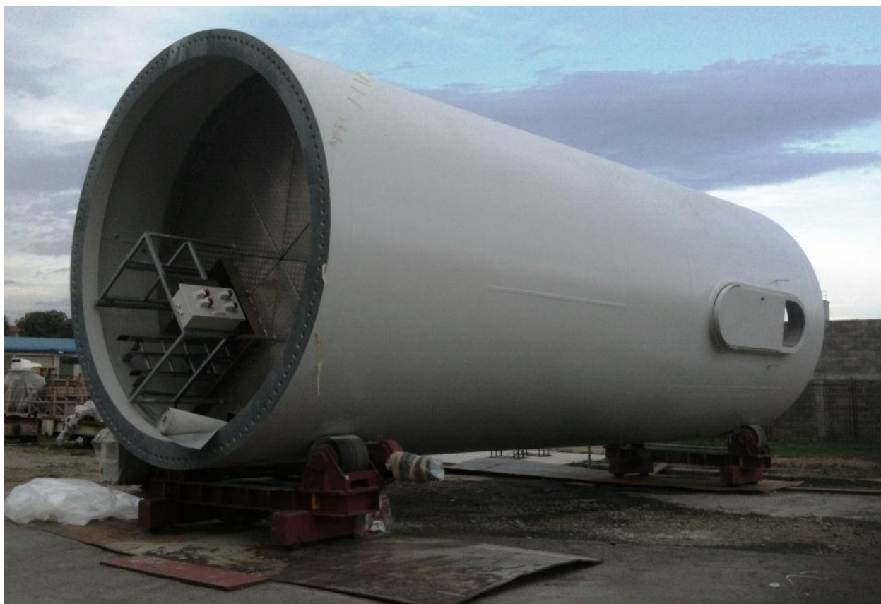
Slika 1.4. Donji segment stupa vjetroagregata K80 [4]
