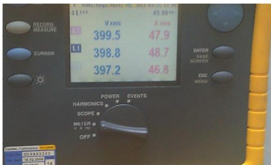
**Slika 24. Pravilan raspored opterećenja po fazama**
