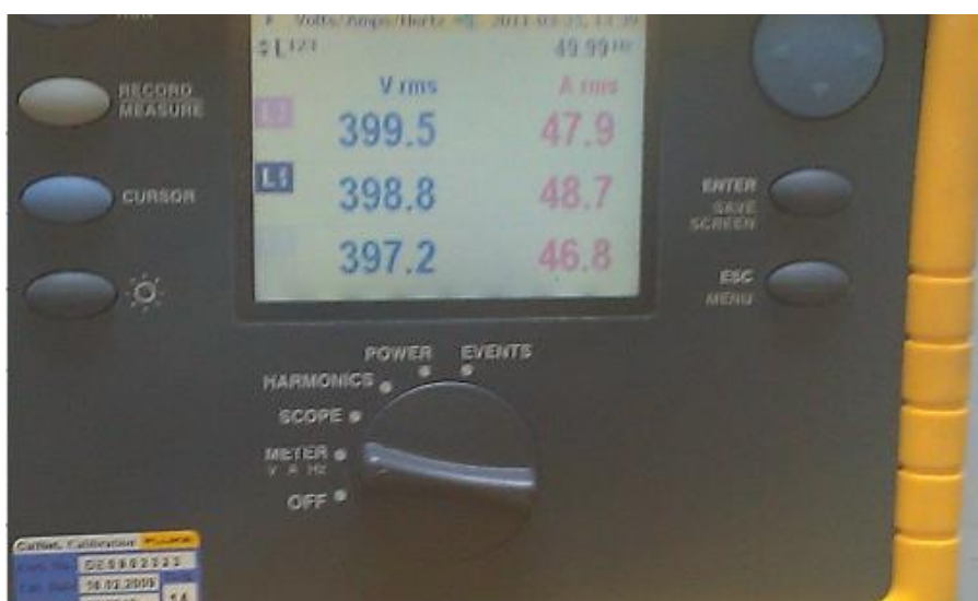
Slika 24. Pravilan raspored opterećenja po fazama
