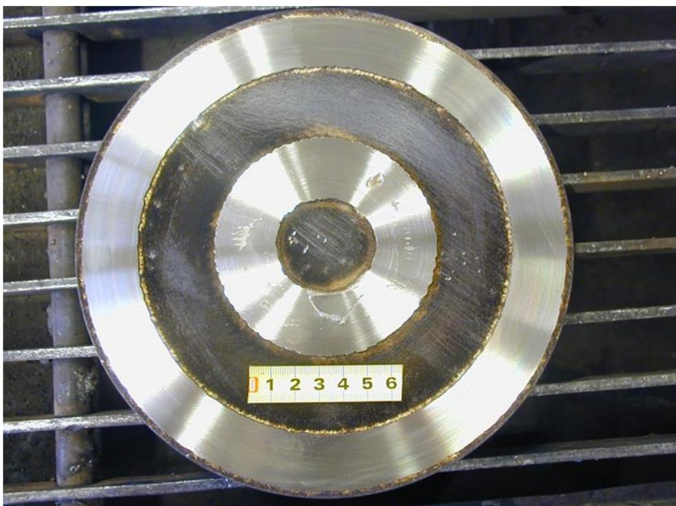
**Slika 24** Obradak nakon dodatne obrade tokarenja [18]
