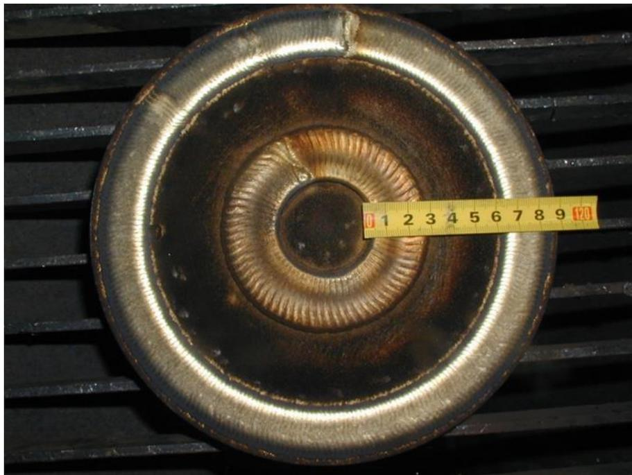
**Slika 23** Obradak nakon nanosenoj sloja plazma navarivanjem [18]
