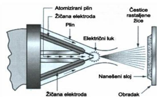
**Slika 13** Shema postupka elektrolučnog naštrcavanja pomoću žice [6]
