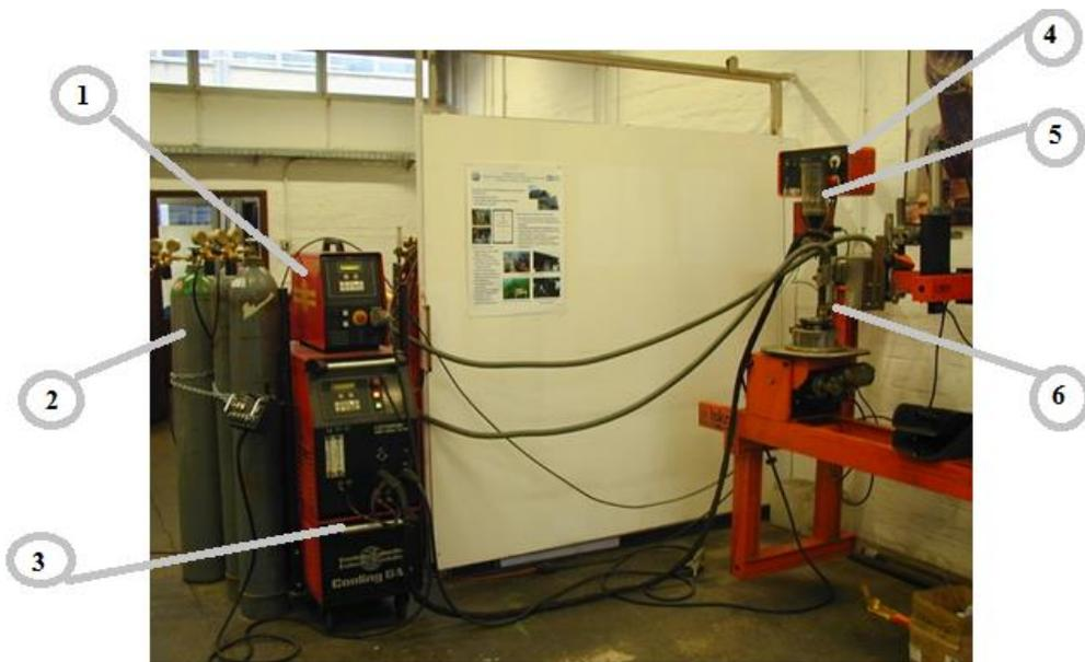
Slika 22 Oprema za plazma navarivanje praškom [18]
