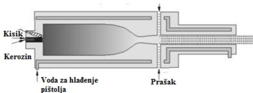
**Slika 19** Shematski prikaz treće generacije HVOF pištolja „JP 5000“ [15]
