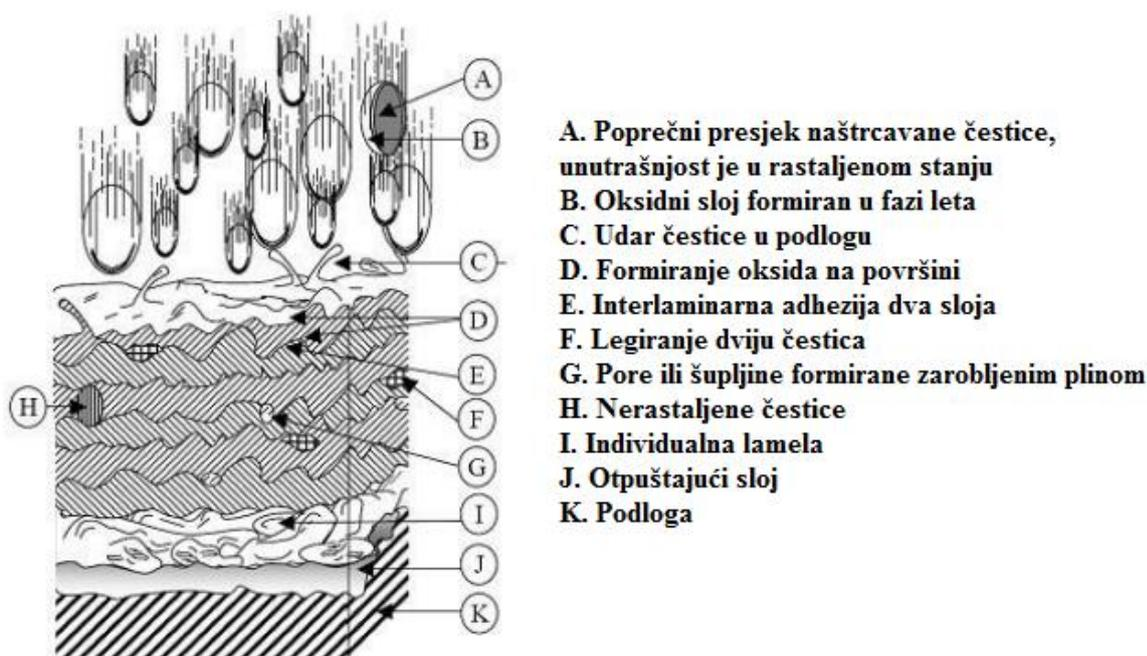
**Slika 4** Tipičan poprečni presjek toplinski naštrcanog sloja [8]
