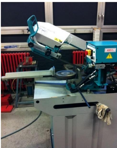
**Slika 25** Tračna pila pomoću koje su izrezani uzorci
