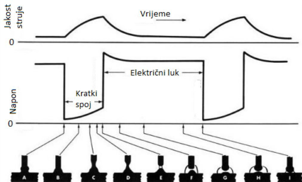
Slika 4. Princip prijenosa metala kratkim spojevima po fazama [8]
