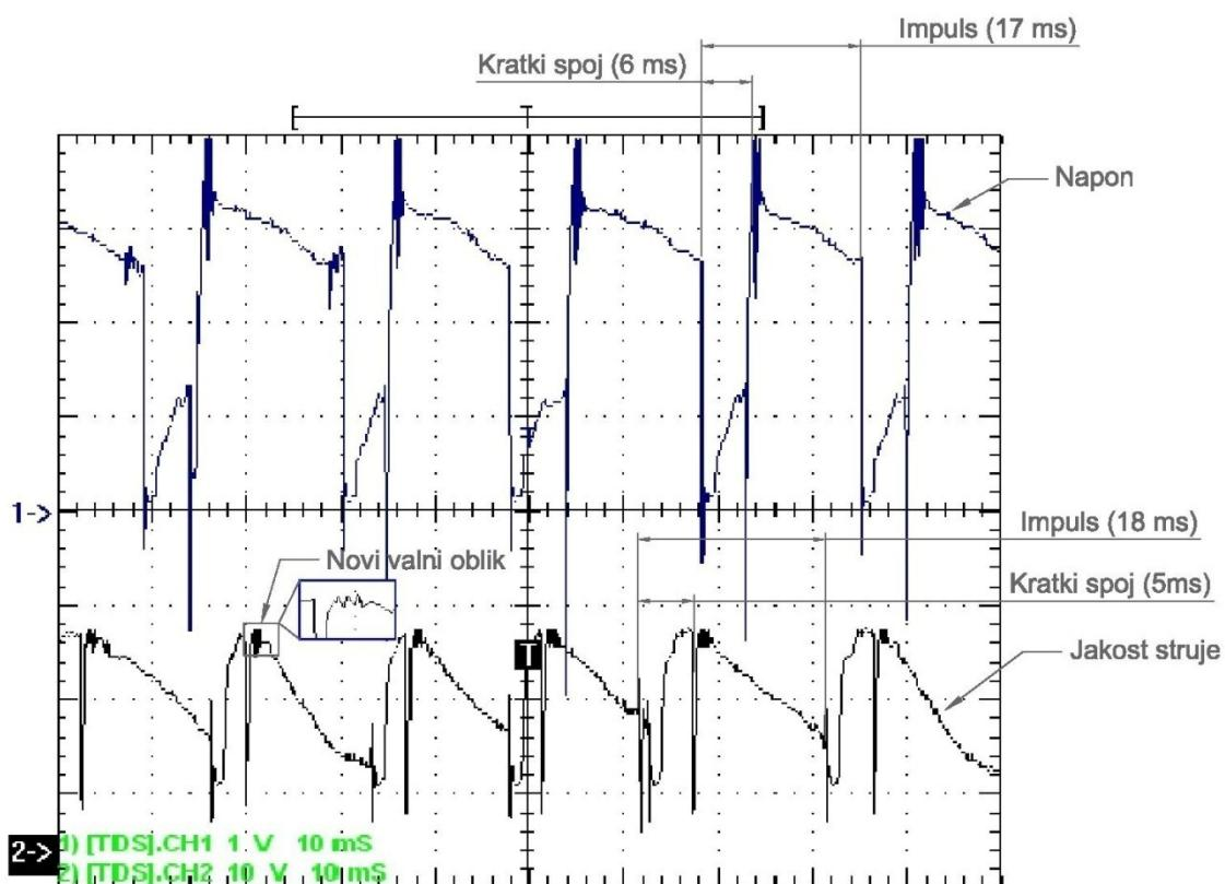
**Slika 37. Oscilogram dinamičke karakteristike  $u,i = f(t)$ , pri CBT prijenosu metala pri brzini dodavanja žice 7 m/min (100% CO<sub>2</sub>)**
