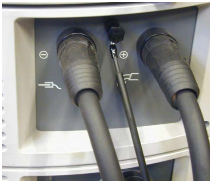
Slika 24. Kabel za povratnu vezu potreban kod „Low spatter“ načina rada [2]
