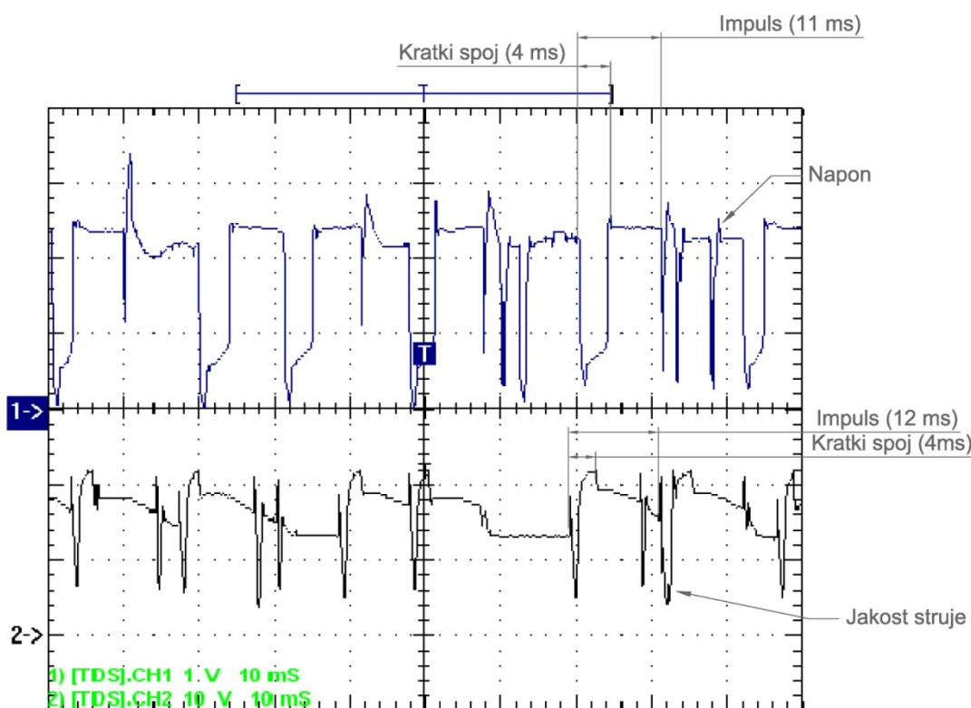
**Slika 30. Oscilogram dinamičke karakteristike  $u,i = f(t)$ , pri klasičnom prijenosu metala pri brzini dodavanja žice 5 m/min (82 % Ar / 18 % CO<sub>2</sub>)**
