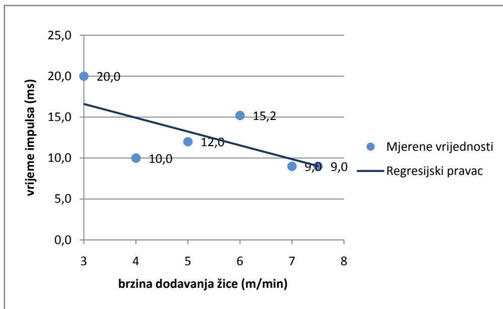
**Slika 31. Promjena trajanja impulsa u ovisnosti od brzine dodavanja žice kod klasičnog načina prijenosa metala (82 % Ar / 18 % CO<sub>2</sub>)**
