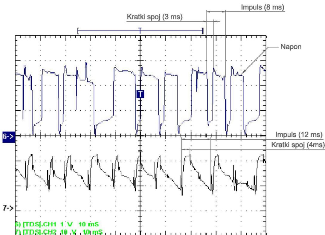
**Slika 39. Oscilogram dinamičke karakteristike  $u,i = f(t)$ , pri klasičnom prijenosu metala pri brzini dodavanja žice 4 m/min (100% CO<sub>2</sub>)**
