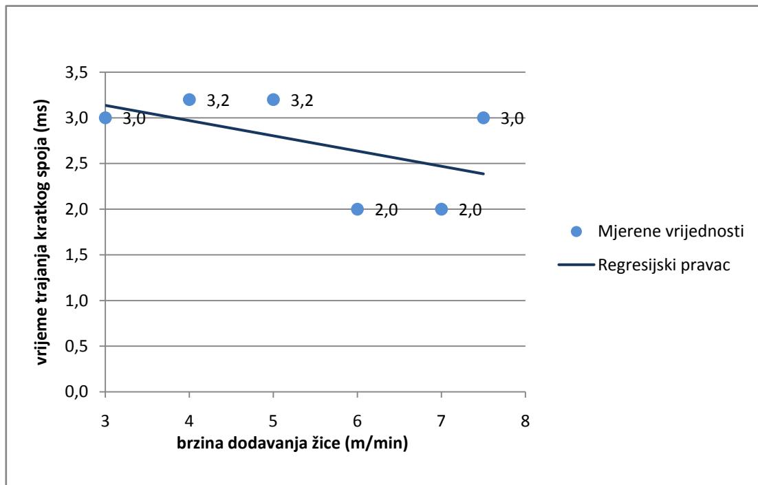
**Slika 32. Promjena vremena trajanja kratkog spoja o brzini dodavanja žice kod klasičnog načina prijenosa metala (82 % Ar / 18 % CO<sub>2</sub>)**
