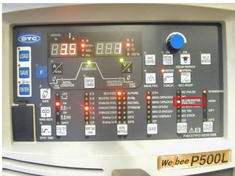
Slika 25. Sučelje za podešavanje načina rada i parametre zavarivanja - OTC Daihen Welbee P500L
