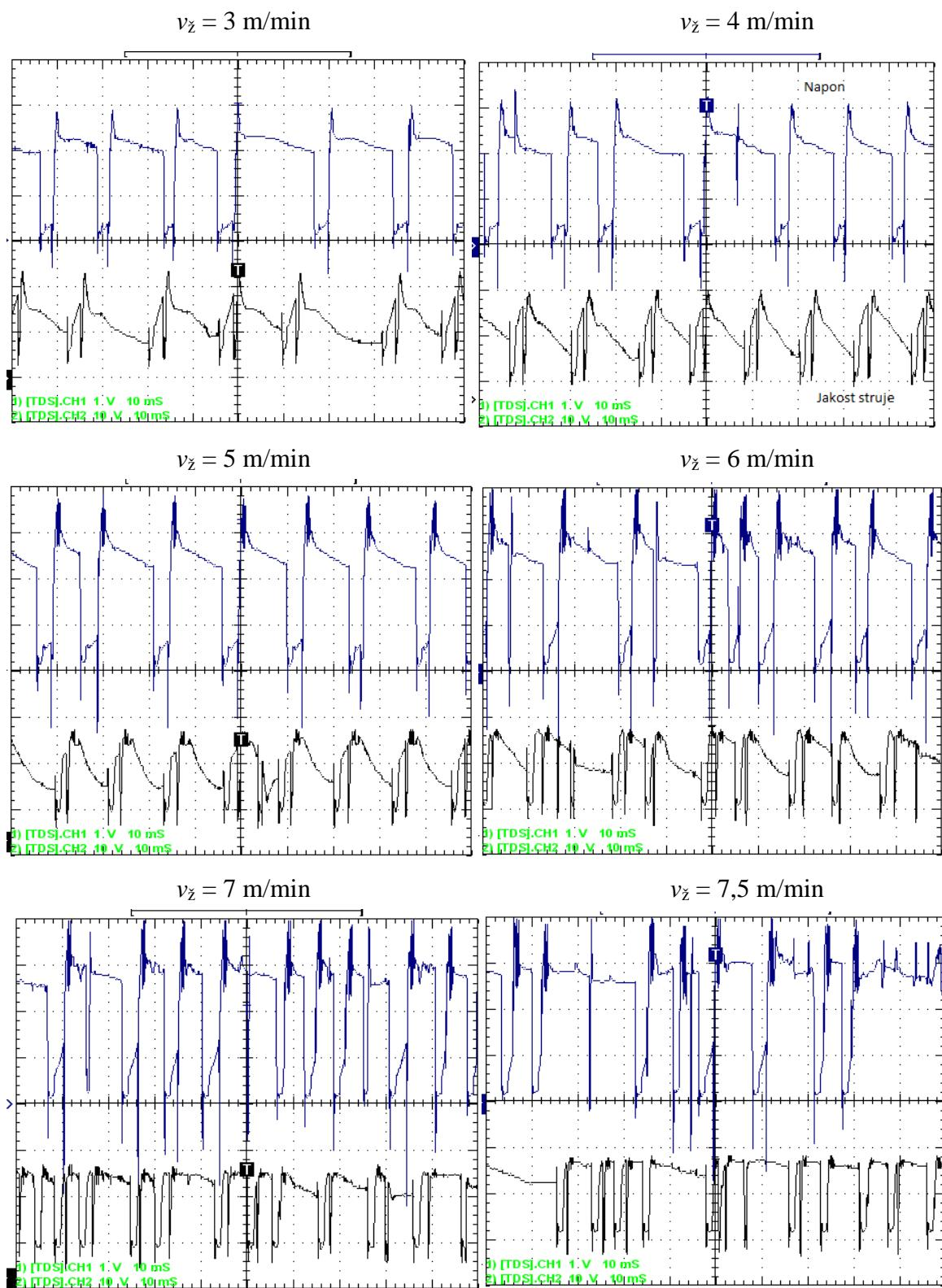
**Slika 27.** Oscilogrami dinamičkih karakteristika  $u,i = f(t)$ , pri CBT prijenosu metala
