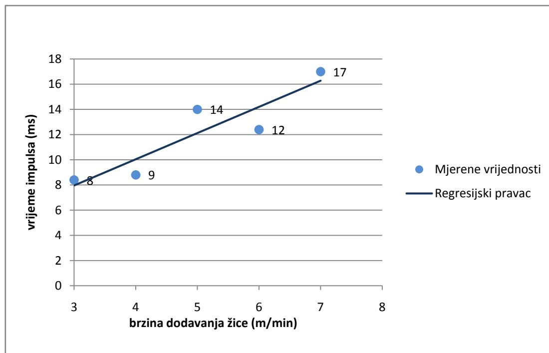
**Slika 40. Promjena vremena trajanja impulsa u ovisnosti od brzine dodavanja žice kod klasičnoga načina prijenosa metala (100% CO<sub>2</sub>)**
