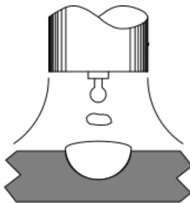
**Slika 5. Shematski prikaz prijenosa metala prijelaznim lukom [7]**
