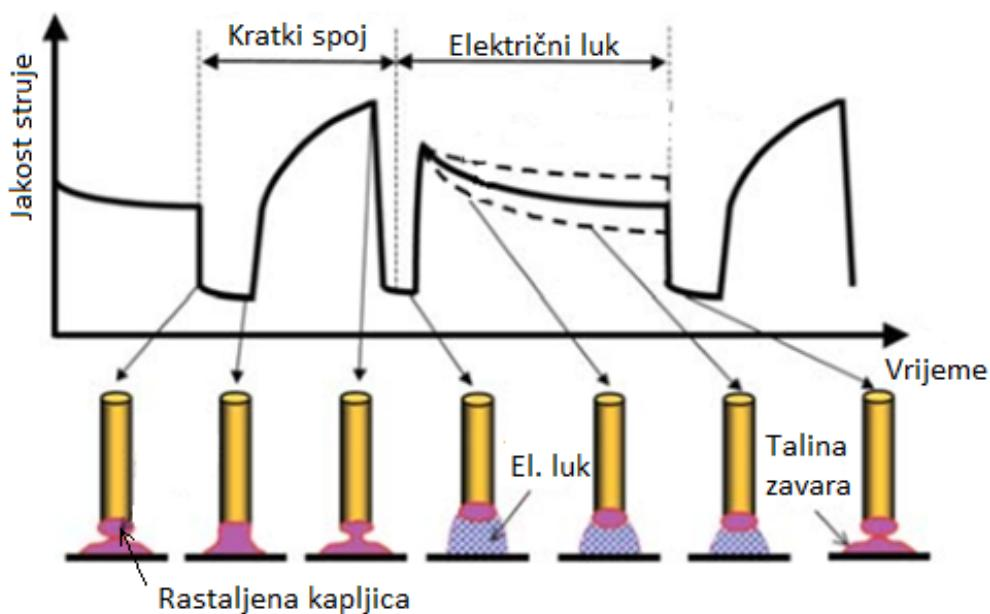
Slika 10. Princip rada CBT metode zavarivanja [10]
