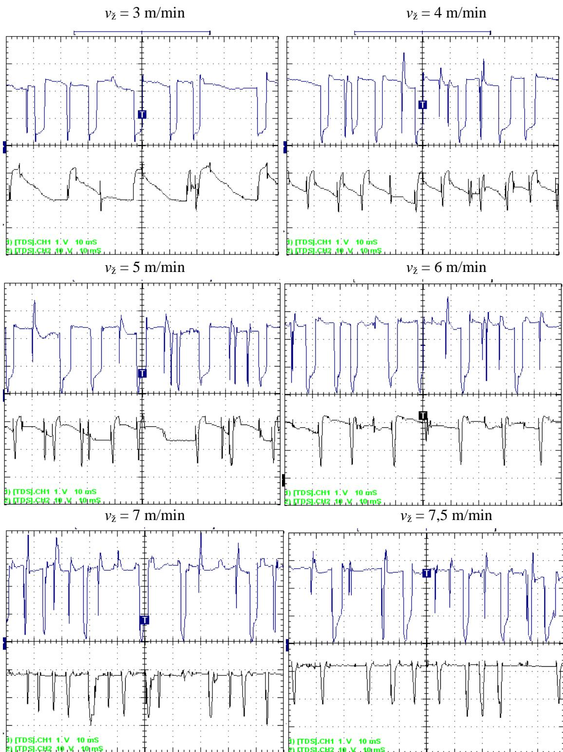
**Slika 29. Oscilogrami dinamičkih karakteristika  $u,i = f(t)$ , pri klasičnom načinu prijenosa metala (82 % Ar / 18 % CO<sub>2</sub>)**
