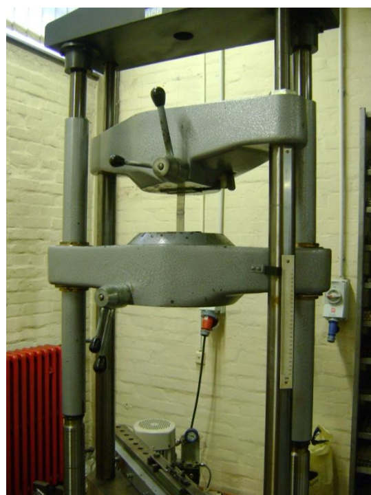
Slika 4.18. Epruveta u čeljustima kidalice
