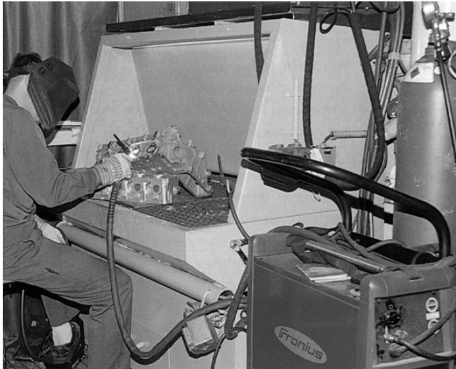
Slika 3.2. Osnovna oprema za TIG postupak zavarivanja [2]
