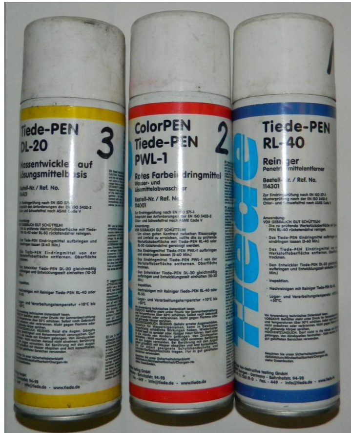
Slika 22. Oprema za ispitivanje penetrantom
