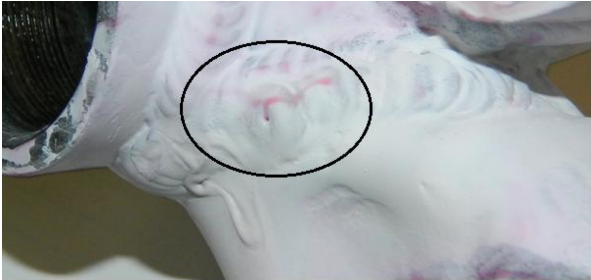
Slika 33. Indikacija pukotine u završnom krateru reparaturnog zavara
