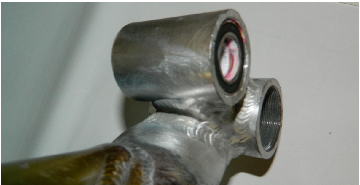
Slika 30. Izgled zavara nakon reparature (pogled s desna)
