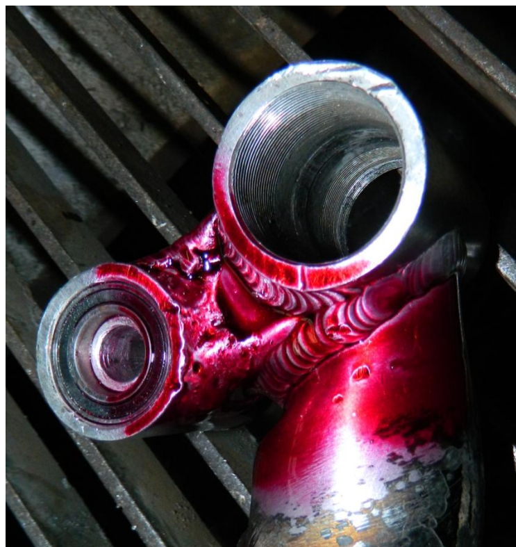
Slika 23. Penetrant nanesen na površinu zavara
