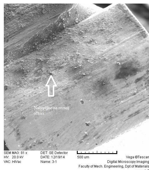
Slika 48. Rezna površina uzorka 3
