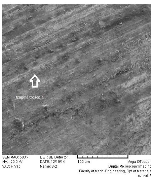
Slika 49. Tragovi trošenja rezne površine uzorka 3
