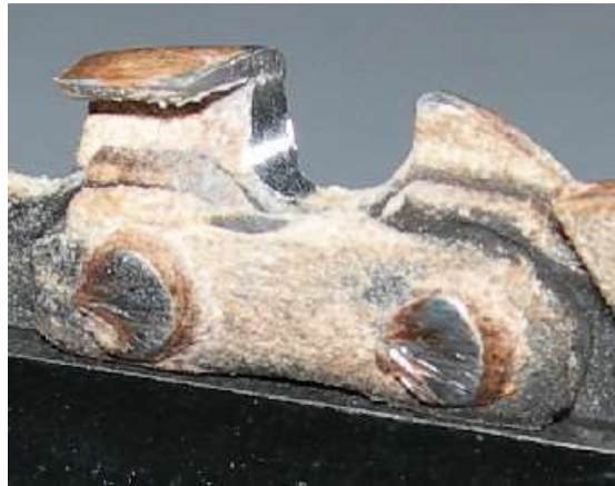
Slika 29. Primjer korodiranog reznog zuba
