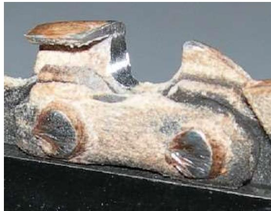
Slika 29. Primjer korodiranog rezognog zuba
