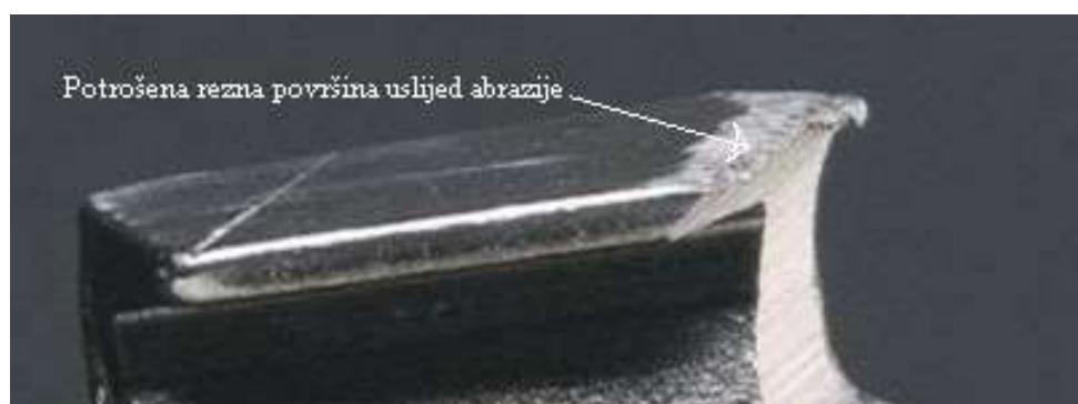
Slika 28. Rezultat abrazivnog trošenja rezne površine reznog zuba
