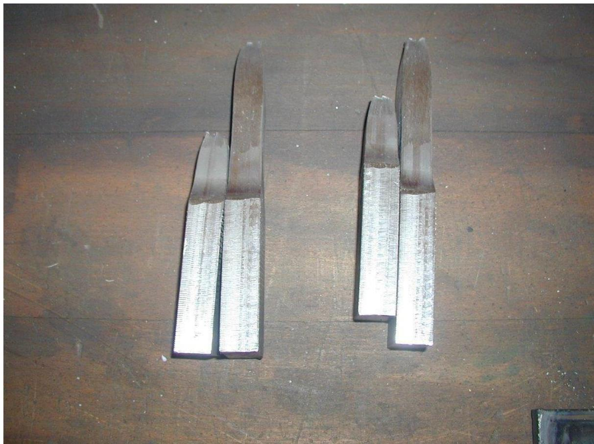
Slika 20. Epruvete nakon provedbe statičkog vlačnog ispitivanja [19]
