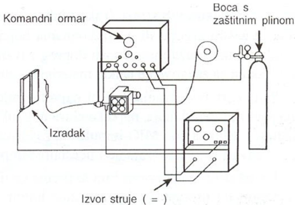
Slika 2. Oprema za MAG zavarivanje [6]
