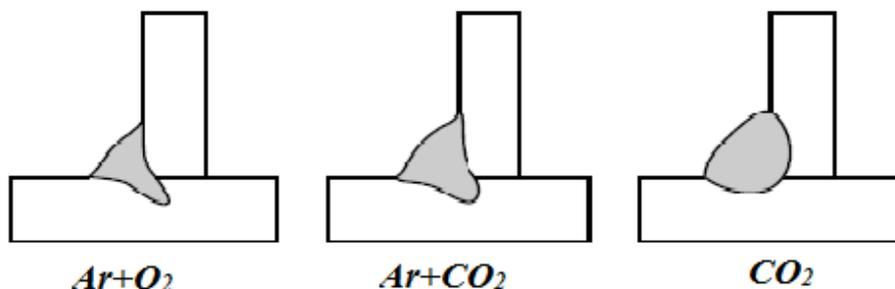
Slika 12. Razlike u penetraciji mješavina plinova i  $\text{CO}_2$  [1]
