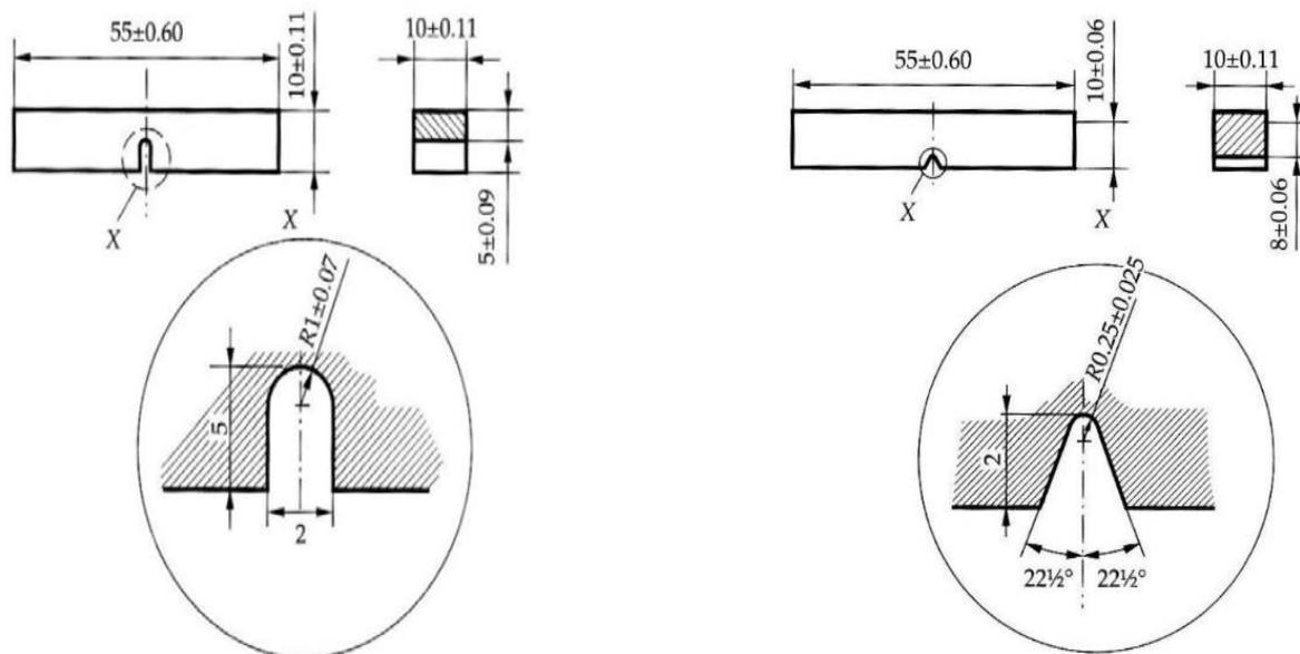
Slika 24. Normirane epruvete (lijevo U-utor; desno V-utor) [24]
