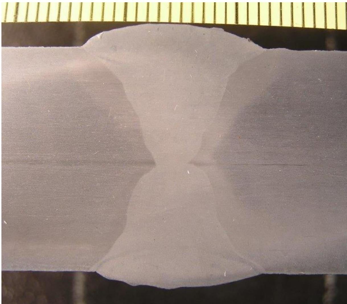
Slika 21. Prikaz makrostrukture zavarenog spoja uz povećanje od 4x [19]
