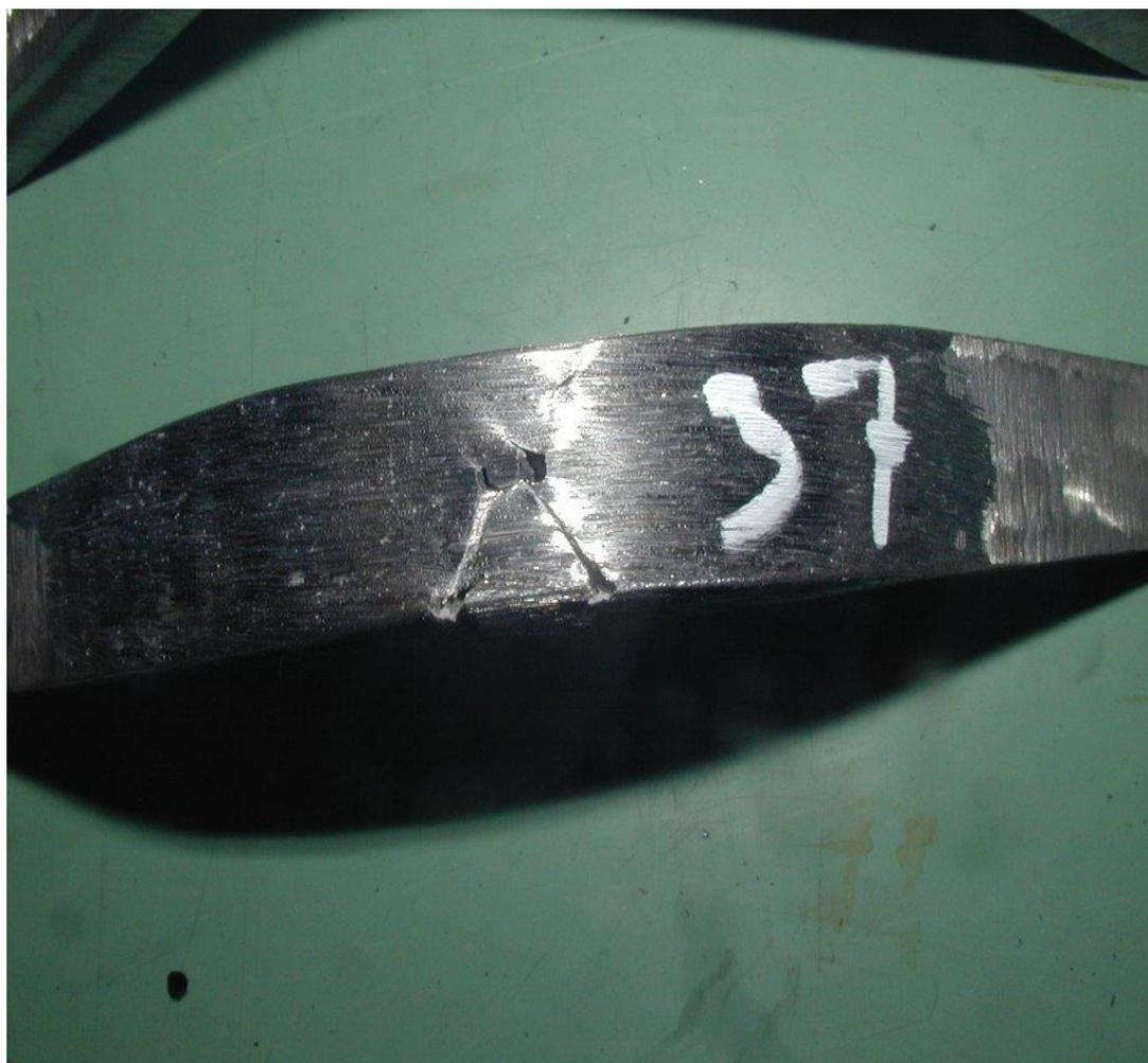
Slika 18. Epruveta koja nije zadovoljila testiranje savijanjem [19]
