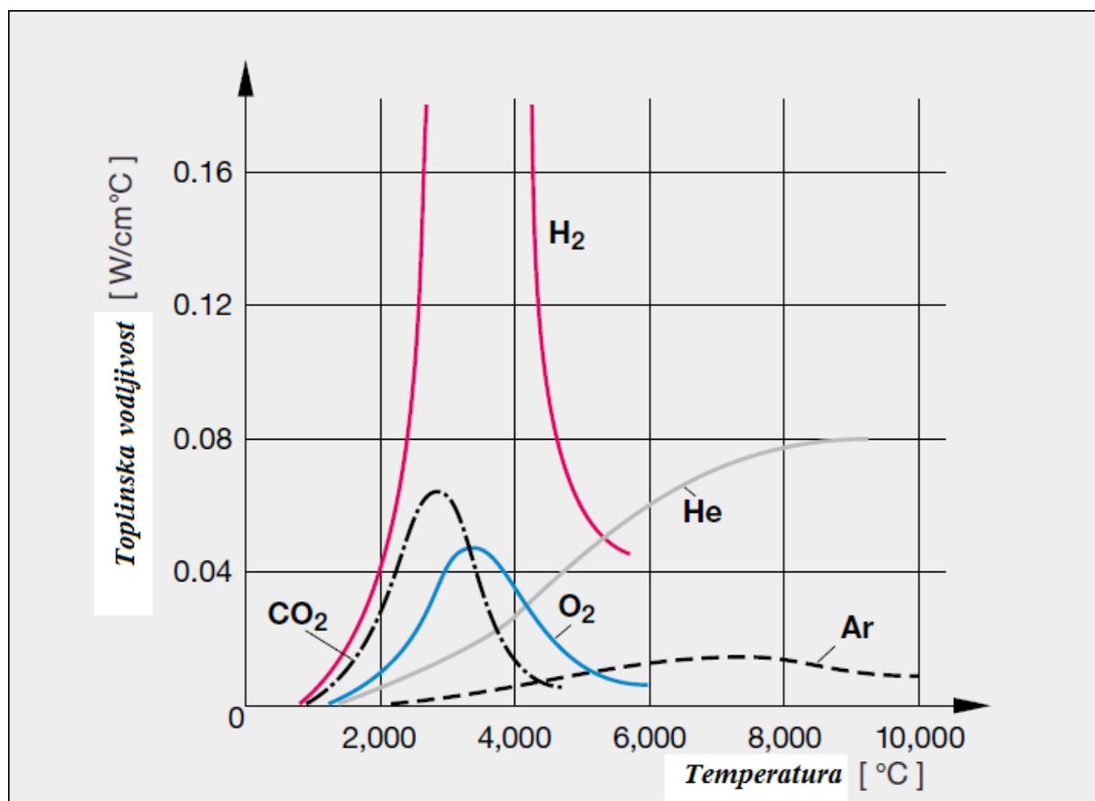
Slika 11. Toplinska vodljivost plinova ovisno o temperaturi [12]
