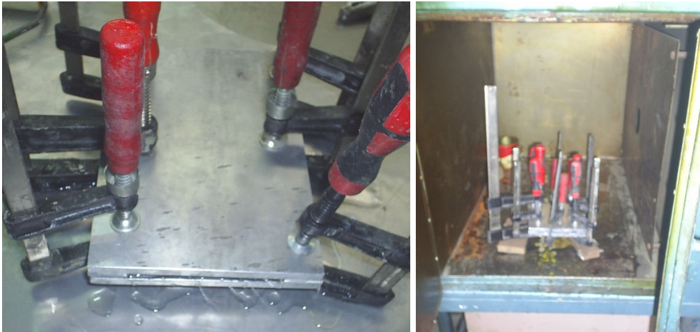
Slika 5.4. Stegnuti kalup i peć
