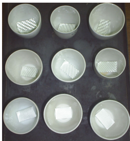
Slika 5.15. Porculanski lončići s staklenim vlaknima
