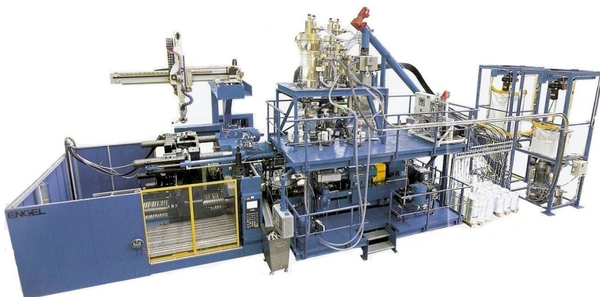
Slika 4.10. Engelova linija za injekcijsko prešanje vlaknima ojačanih plastomernih taljevina [12]
