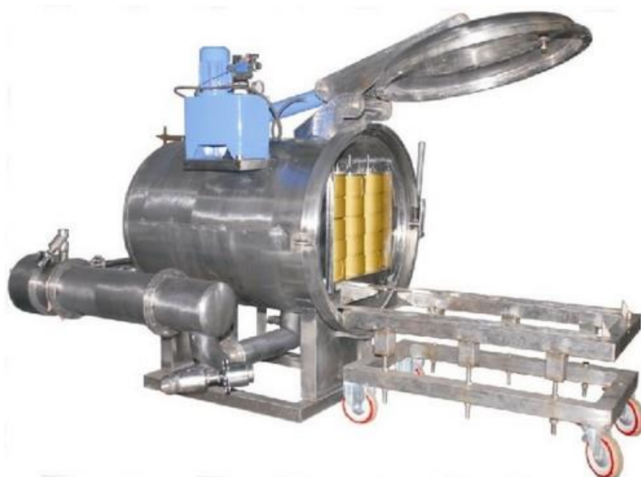
Slika 2. Aparat (kupa) za bojenje konca [3]
