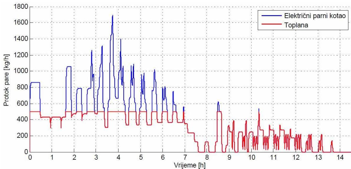
**Slika 11. Pokrivanje potrošnje opskrbom iz toplane uz vršni električni kotao**
