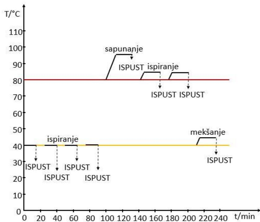
Slika 5. Prikaz temperaturnih režima u procesu naknadne obrade
