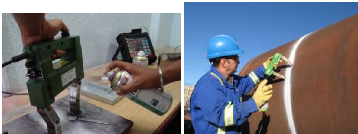
Slika 2.5 Ispitivanje magnetskim česticama
