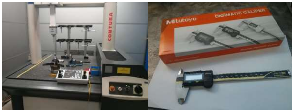
Slika 2.2 Instrumenti za provedbu dimenzionalne kontrole: koordinatni mjerni uređaj (lijevo), pomično mjerilo (desno)
