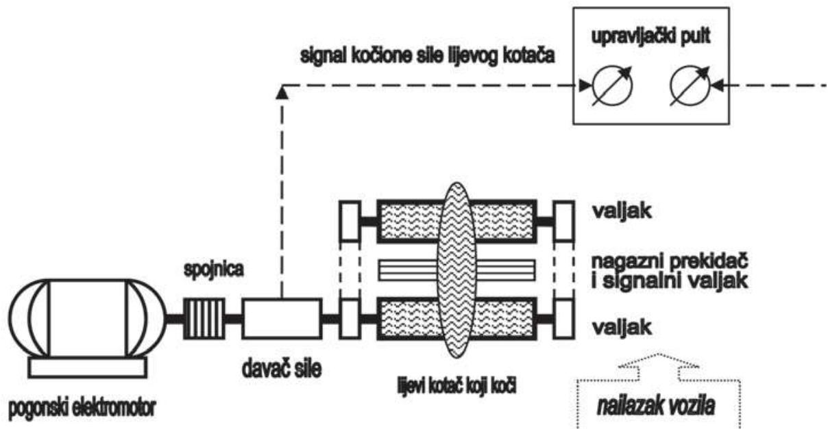
Slika 2. Načelna shema tlocrta valjaka za ispitivanje kočnica [2]
