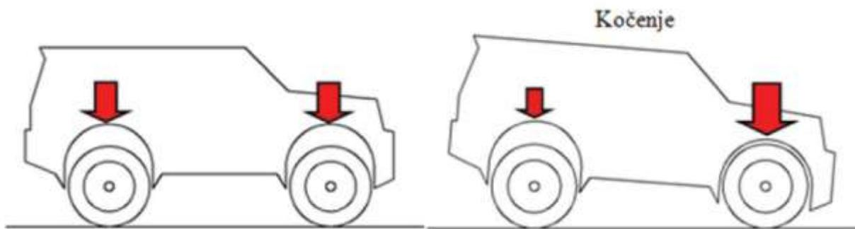
Slika 5. Preraspodjela opterećenja na osovine pri kočenju vozila [2]
