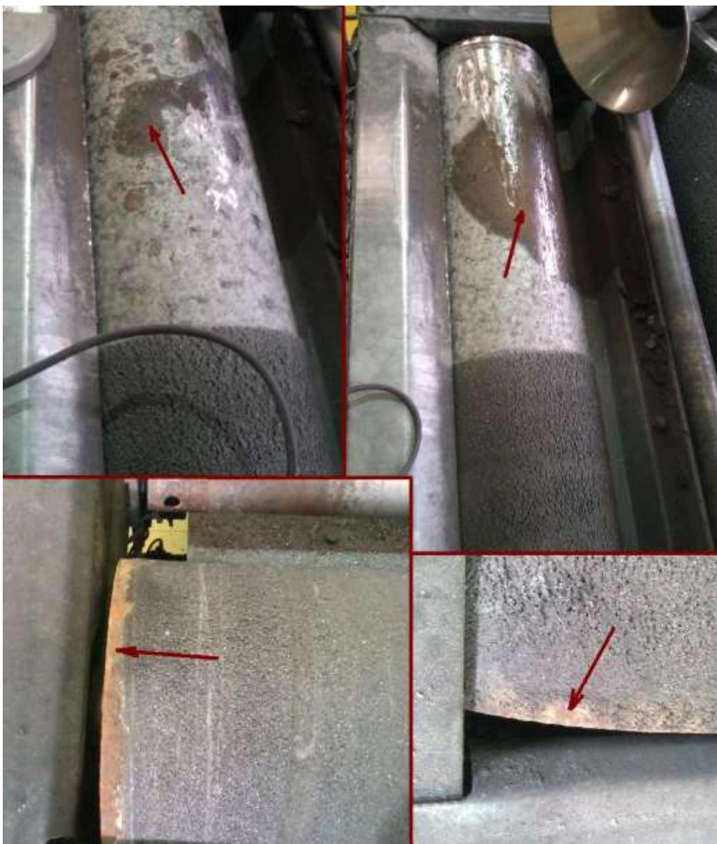
Slika 36. Produkti korozije na valjcima
