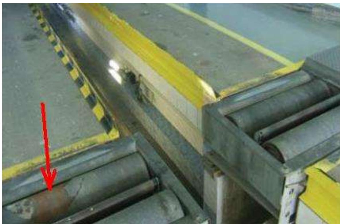
Slika 11. Valjak s kojeg je otpao sloj kompozitne prevlake
