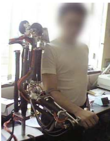
Slika 2.12. Mehanički sustav za pokretanje ljudske ruke [11]
