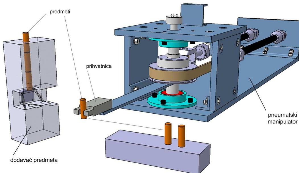
Slika 3.16. CAD model sustava za sortiranje
