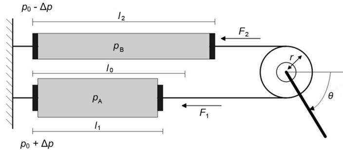
Slika 4.1. Shematski prikaz radnog principa ruke manipulatora
