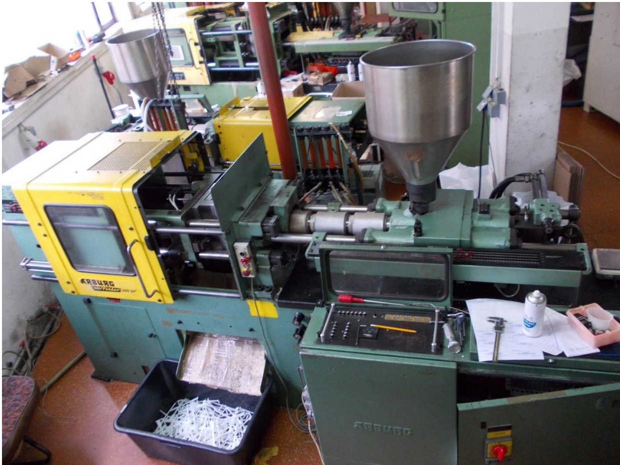
Slika 6.4. Ubrizgavalica proizvođača Arburg , model Allrounder 305-210-700
