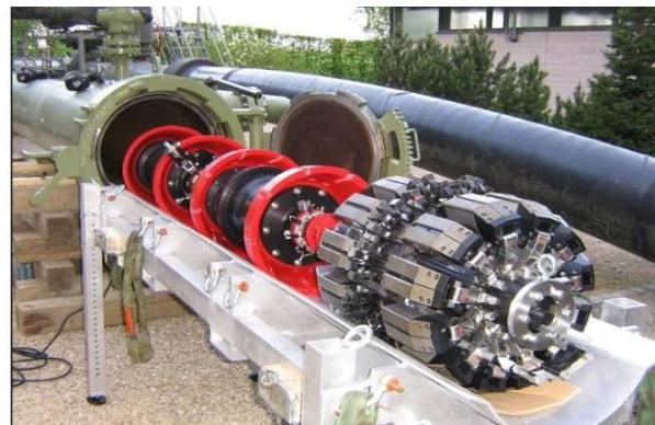
**Slika 23. Čistač i intelijgentni pig**
