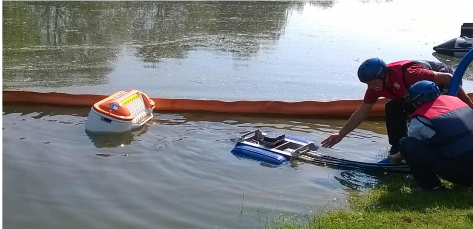
Slika 41. Puštanje skimera i pumpe u vodu, [11]
