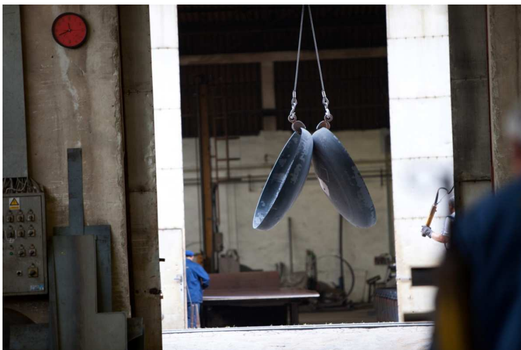
Slika 3. Podnice izrađene hladnim oblikovanjem spremne za normalizaciju [1]
