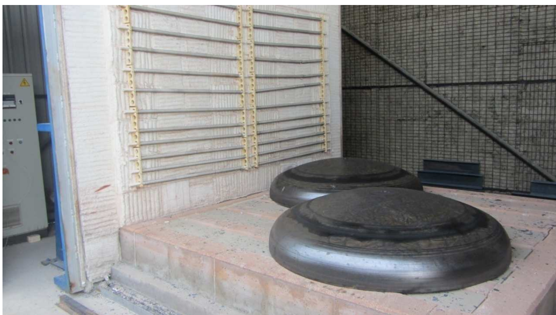
Slika 14. Podnice položene na dno peći prije toplinske obrade
