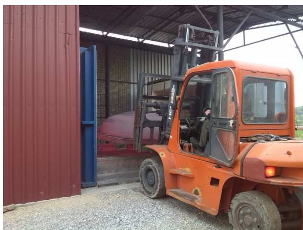
Slika 22. Vađenje proizvoda za hlađenje na mirnom zraku
